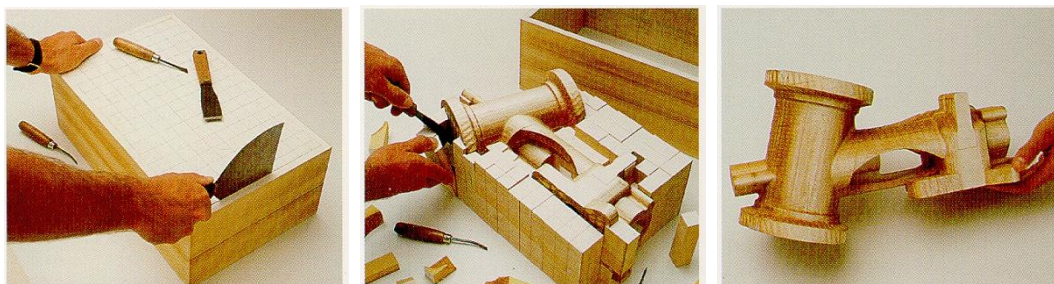
Σχήμα 5.1.1: Καθαρισμός – αποπεράτωση – λήψη πρωτοτύπου LOM
