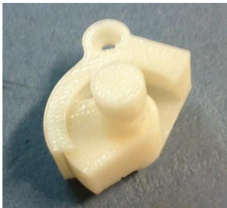
Σχήμα 5.2.4.7: Επιτυχώς αντισταθμισμένο λειτουργόν ζεύγος «έμβολο-φωλιά»
