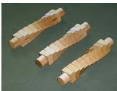
Σχήμα 5.1.4.2.4: Τα “Truncheons” αξιολόγησης ποιότητας επιφάνειας
