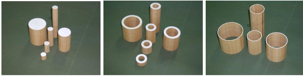
Σχήμα 5.1.4.2.1: Δοκίμια ελέγχου ακρίβειας στον άξονα Z
