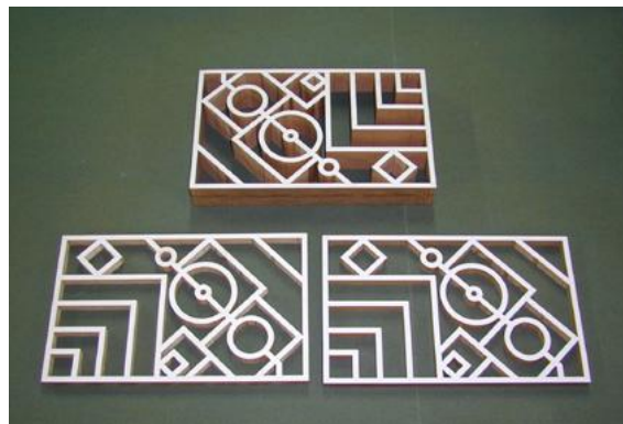
Σχήμα 5.1.4.2.2: Δοκίμια LOM ελέγχου ακρίβειας επιπέδου XY
