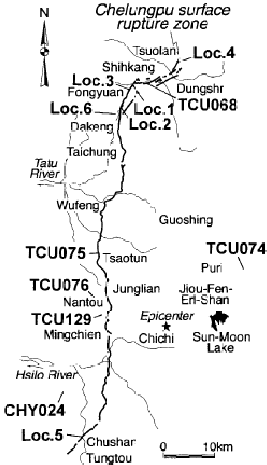
Χάρτης 5.13: Η επιφάνεια ρήξης και οι τοποθεσίες των τόπων της έρευνας και το ισχυρόν κινήσεων που παρατηρήθηκαν. Το αστέρι δείχνει το επίκεντρο του κυρίως σεισμού.
