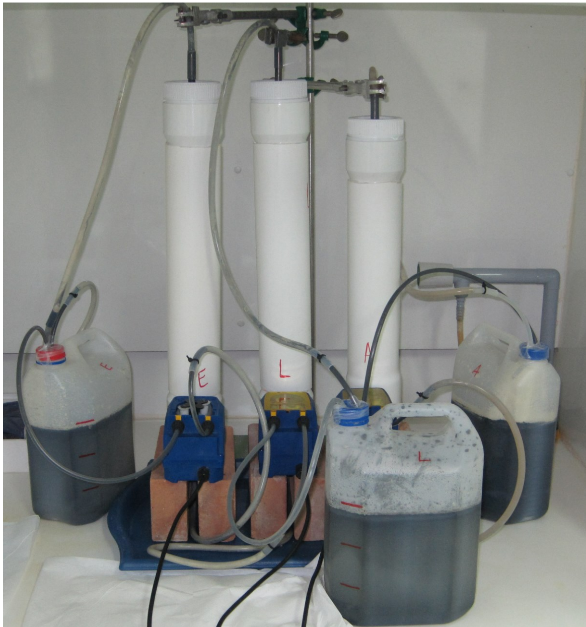
Εικόνα Α.4. Αντιδραστήρες IV με πληρωτικό υλικό Γ και αιθανόλη (E), γαλακτικό νάτριο (L) και οξικό νάτριο (A) ως πηγή άνθρακα/ηλεκτρονίων σε κατάσταση λειτουργίας διαλείποντος έργου
