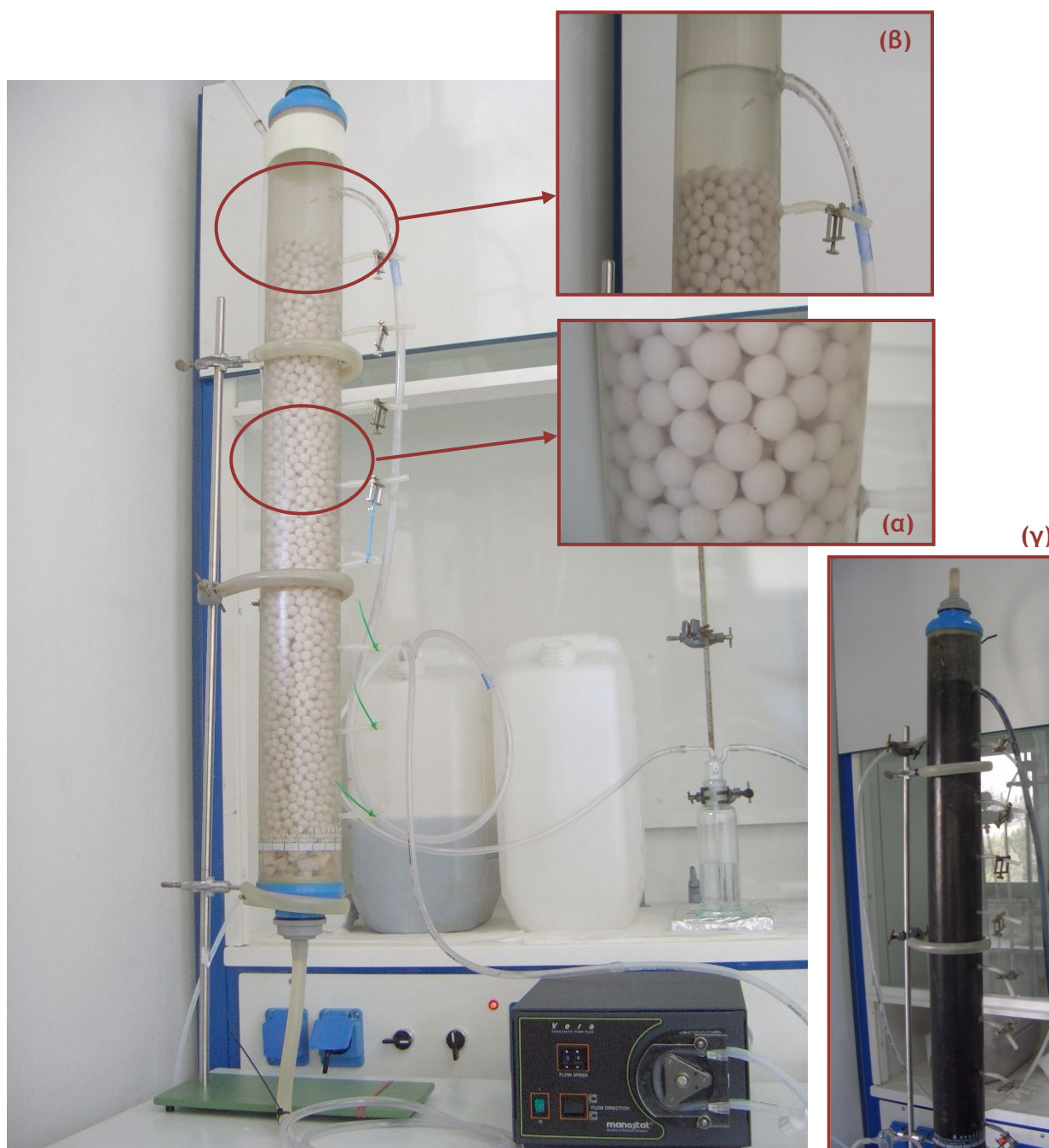
Εικόνα Α.1. Διάταξη αντιδραστήρα Ι κατά την έναρξη της λειτουργίας του: (α) λεπτομέρεια της κλίνης με πληρωτικό υλικό Α και (β) τμήμα αντιδραστήρα χωρίς πληρωτικό υλικό. (γ) Εικόνα αντιδραστήρα πέντε μήνες μετά την έναρξη της λειτουργίας του
