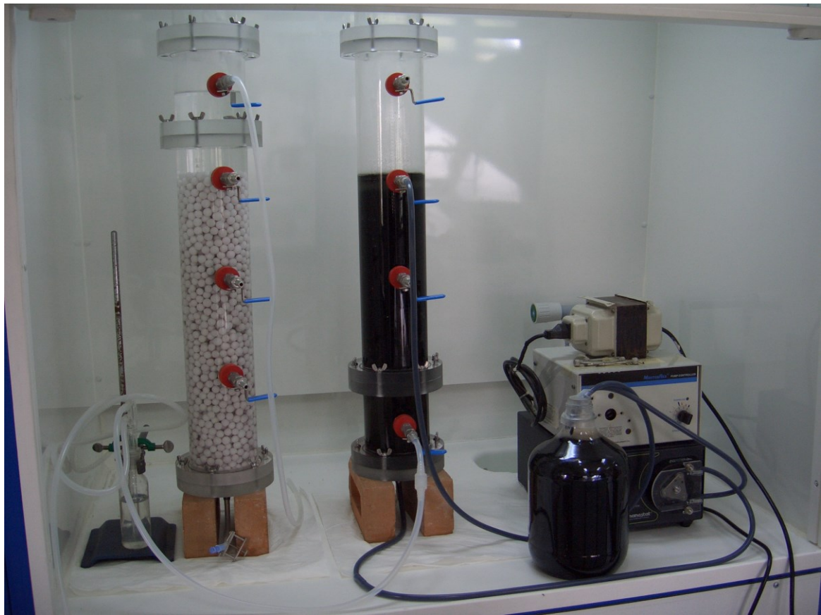
Εικόνα Α.2. Αντιδραστήρας II με πληρωτικό υλικό Β σε κατάσταση λειτουργίας διαλείποντος έργου, δέκα ημέρες μετά τον εμβολιασμό του
