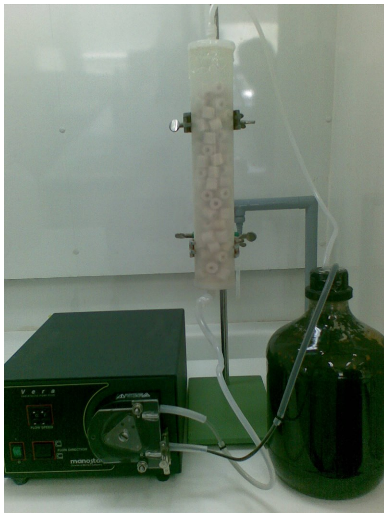
Εικόνα Α.3. Αντιδραστήρας III με πληρωτικό υλικό Γ κατά την έναρξη της λειτουργίας του σε κατάσταση διαλείποντος έργου
