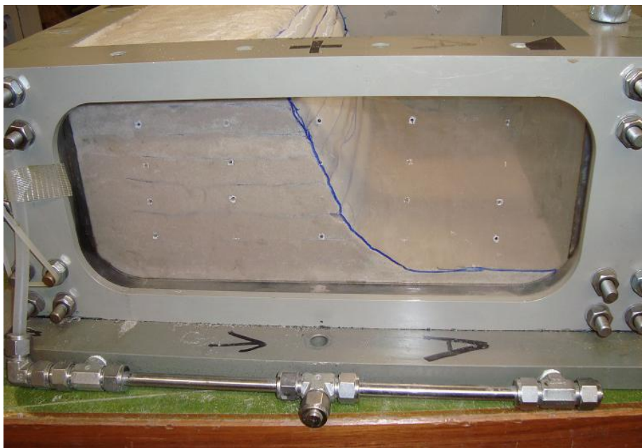
Φωτογραφία 8.11. Οπλισμένο πρανές μετά το πέρας των φορτίσεων. Photograph 8.11. Reinforced slope after loading.
