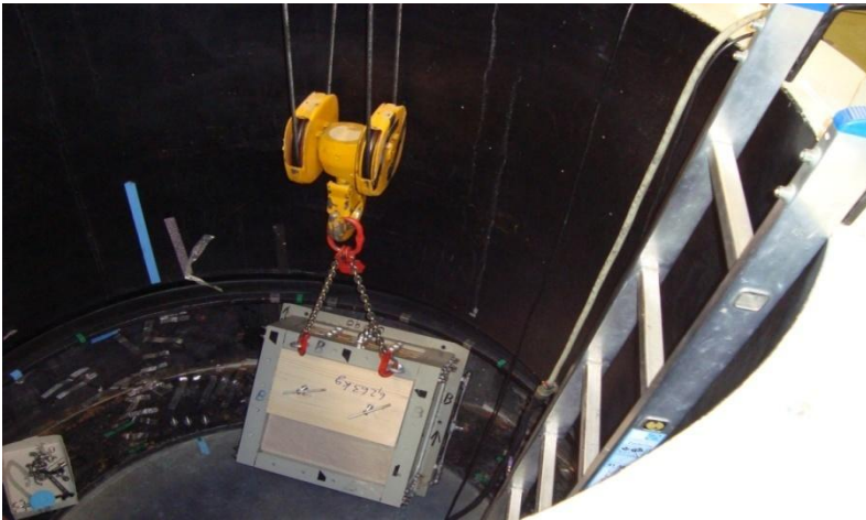
Φωτογραφία 8.3. Τοποθέτηση μοντέλου στον φυγοκεντριστή. Photograph 8.3. Placement of the model in the centrifuge.
