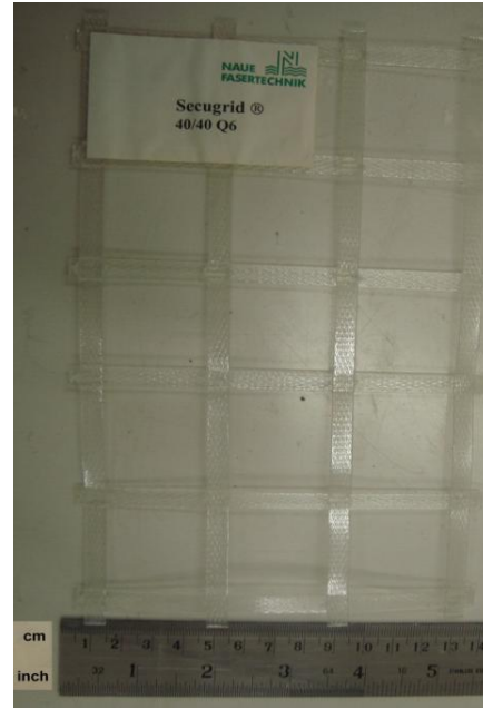
Φωτογραφία 1.13. Τύπος Γεωπλέγματος. Photograph 1.13. Geogrid type.
