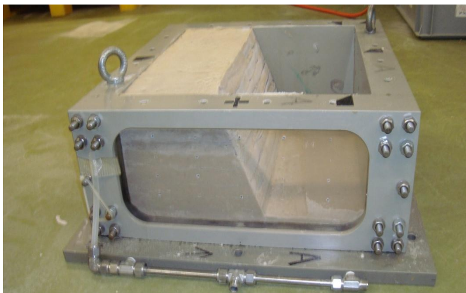
Φωτογραφία 8.9. Οπλισμένο πρανές πριν από την μεταφορά του στον φυγοκεντριστή. Photograph 8.9. Reinforced slope before the transport in the centrifuge.
