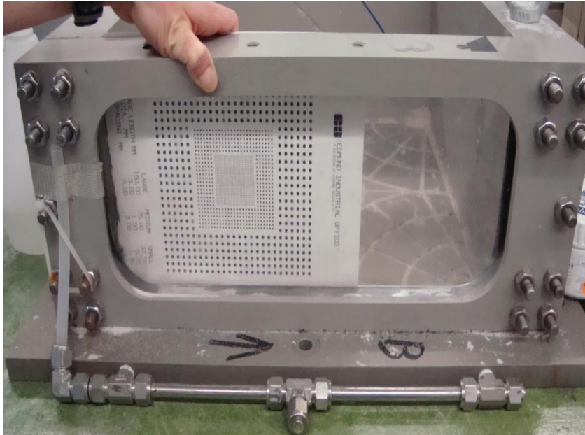
Φωτογραφία 7.41. Φωτογραμμικός κάναβος για την βαθμονόμηση του μοντέλου. Photograph 7.41. Photogrammetric grid for model calibration.
