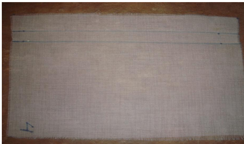
Φωτογραφία 7.17. Υλικό όπλισης: Επίδεσμος. Photograph 7.17. Reinforcement material: Bandage.
