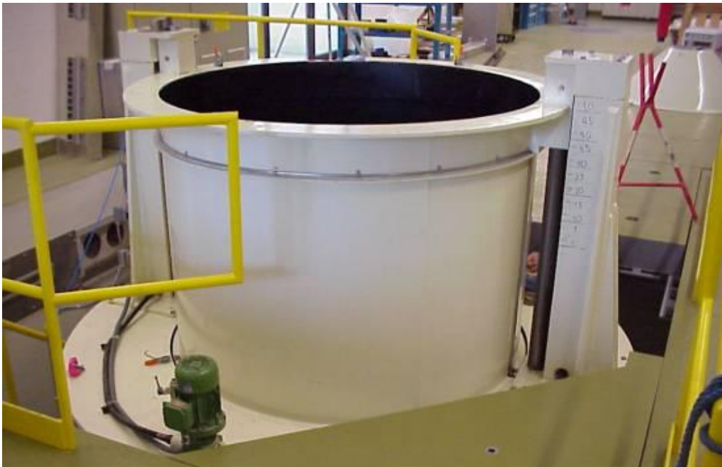
Φωτογραφία 5.1. Γεωτεχνικός Φυγοκεντριστής με Τύμπανο στο ETH Zurich (Kapogianni et al. 2010). Photograph 5.1. The ETH Zurich Drum Geotechnical Centrifuge (Kapogianni et al. 2010).
