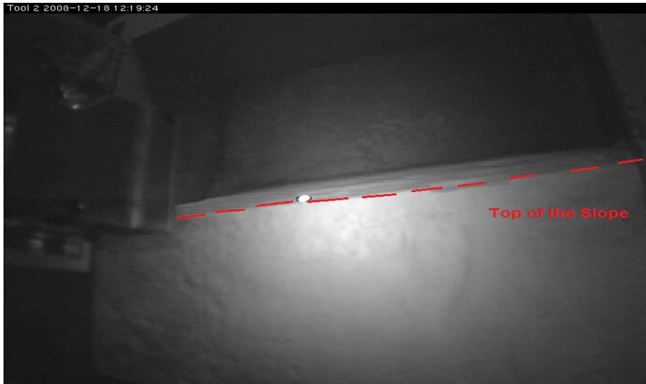
Φωτογραφία 8.10. Κορυφή οπλισμένου πρανούς σε επιτάχυνση της βαρύτητας 25g. Photograph 8.10. Top of reinforced slope at 25g level.
