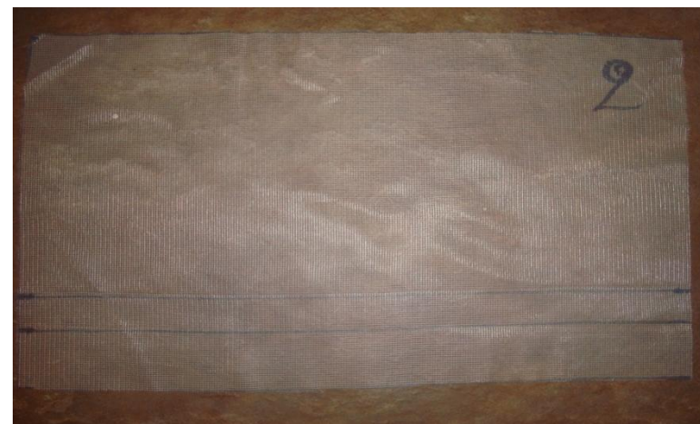
Φωτογραφία 7.18. Υλικό όπλισης: Κουρτίνα Β. Photograph 7.18. Reinforcement material: Curtain B.
