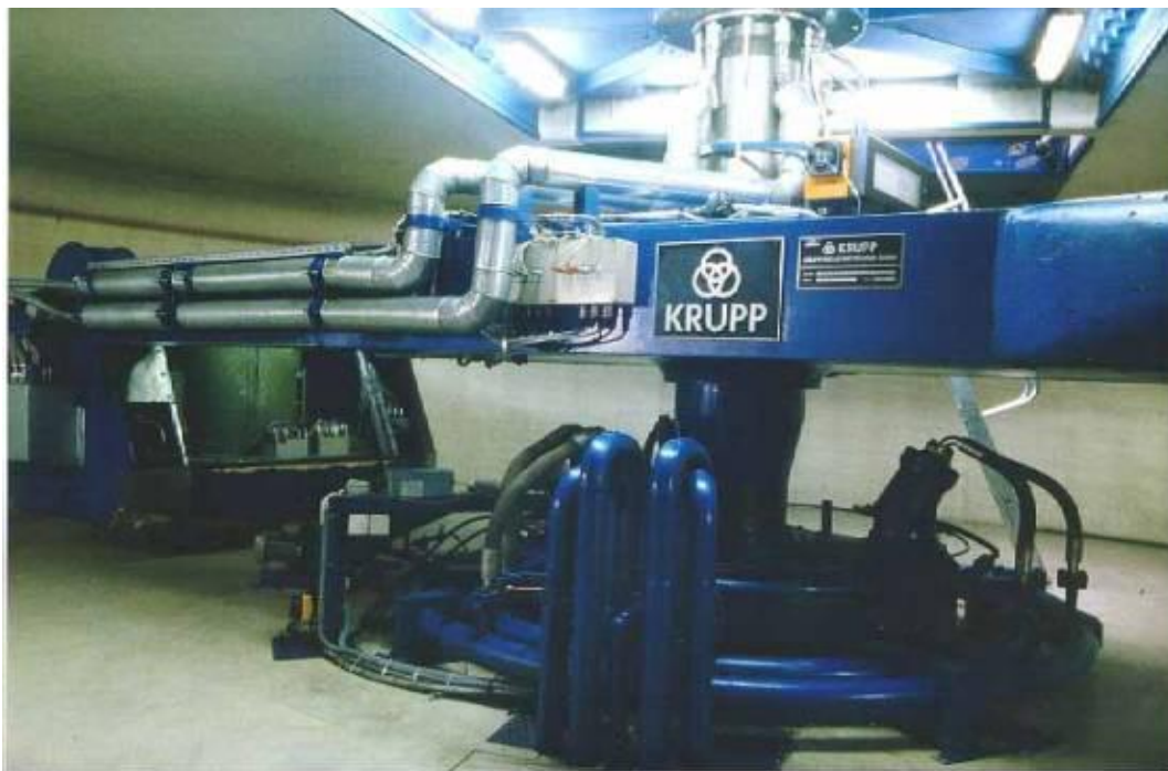
Φωτογραφία 5.2. Γεωτεχνικός Φυγοκεντριστής με καλάθι περιστροφής του Bochum (Laue, 2002) Photograph 5.2. The Bochum Beam Geotechnical Centrifuge (Laue, 2002).
