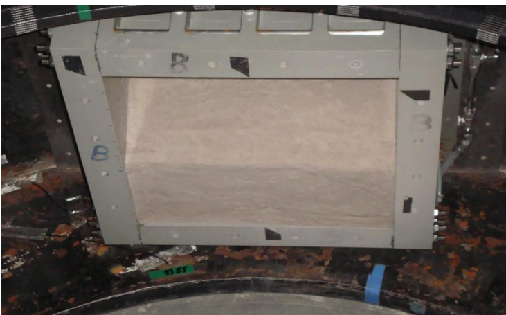
Φωτογραφία 8.5. Άοπλο πρανές στον φυγοκεντριστή. Photograph 8.5. Unreinforced model in the centrifuge.
