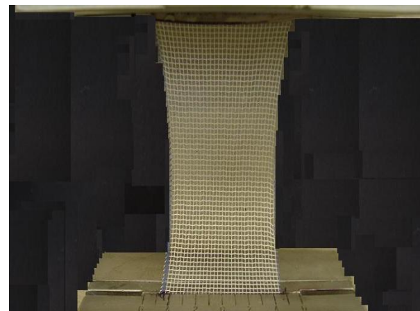
Φωτογραφία 7.23. Πείραμα εφελκυστικής αντοχής 'Κουρτίνας Β'. Photograph 7.23. Tensile strength test of 'Curtain B'.
