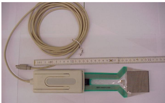
Φωτογραφία 6.1. Αισθητήρας πίεσης με λαβή (Laue, 2002). Photograph 6.1. Pressure sensor with handle (Laue, 2002).
