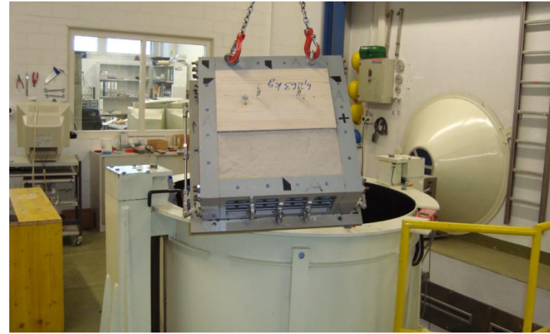
Φωτογραφία 8.2. Μεταφορά του μοντέλου στον φυγοκεντριστή. Photograph 8.2. Transportation of the model in the centrifuge.
