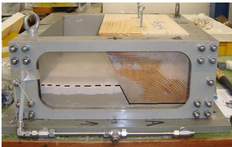
Φωτογραφία 7.5. Οπλισμένο πρανές στη φάση κατασκευής του. Photograph 7.5.Reinforced slope during its construction.
