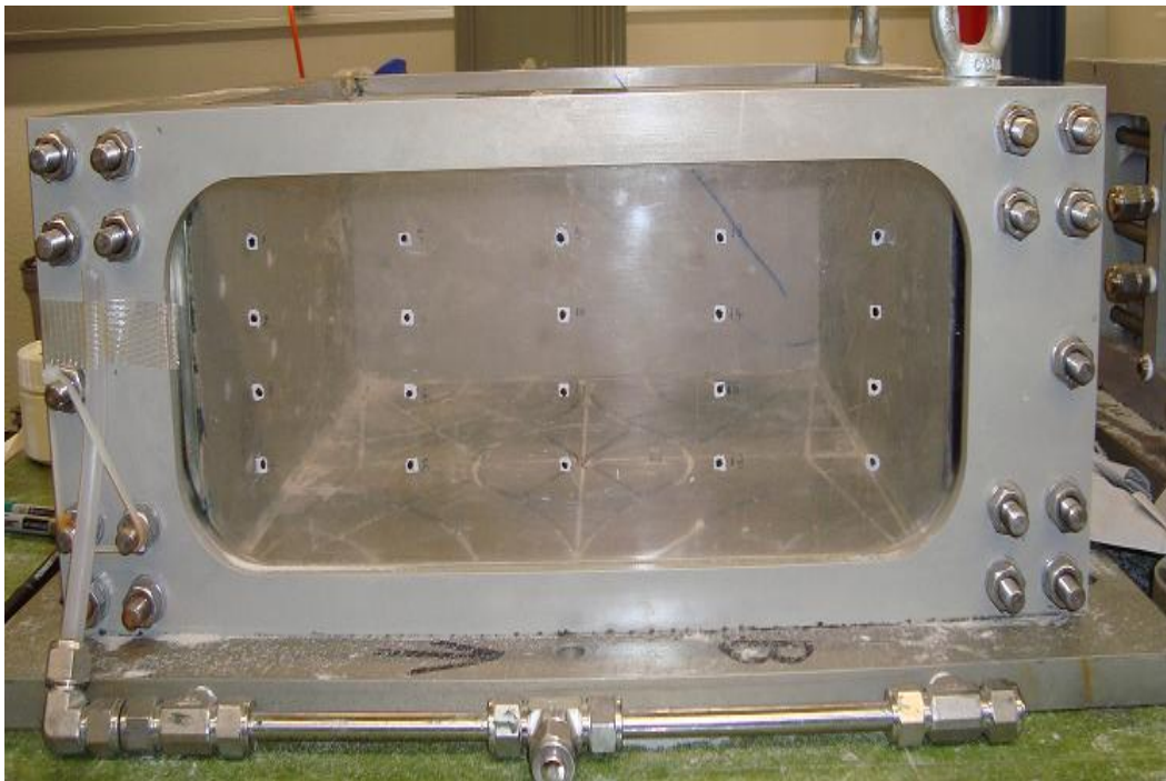
Φωτογραφία 7.1. Στιβαρό κουτί με Plexiglas και ενσωματωμένο κάναβο. Photograph 7.1. Strong box with Plexiglas and incorporated grid.
