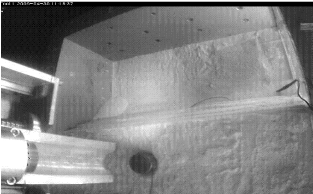
Φωτογραφία 7.30. Ρίψη μοντέλου «βράχου» στην κορυφή του οπλισμένου πρανούς (κάμερα λέιζερ). Photograph 7.30 Rock fall view on top of reinforced slope (laser camera).
