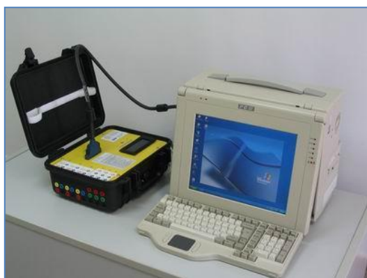
Σχήμα Β2. Μετρητικό σύστημα ποιότητας ισχύος χρησιμοποιήθηκε για τις μετρήσεις αρμονικών στα πλαίσια της διατριβής (αριστερά) και στιγμιότυπο του λογισμικού συλλογής δεδομένων CRESDAQ (δεξιά).
