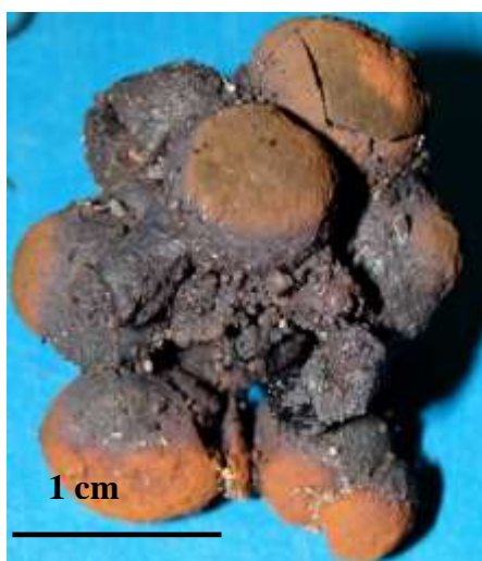
Σχήμα 7.27. Τοπική φρύξη και συσσωμάτωση σφαιριδίων ερυθράς ιλύος.
