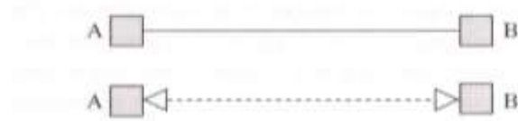
Σχήμα 2.8. Ζεύξη δύο σημείων με γραμμή μεταφοράς (συνεχής γραμμή) και με ακτινοβολία (διακεκομμένη γραμμή) [2].
