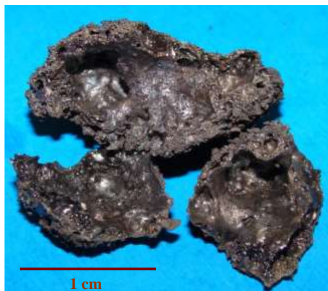
Σχήμα 6.22. Τεμάχια του ανηγμένου κελύφους λατερίτη ύστερα από 120 s μικροκυματικής θέρμανσης.
