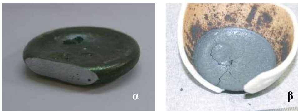
Σχήμα 3.20. (α) Δείγμα χυτοσιδήρου παραχθέν στη συχνότητα των 30 GHz και (β) δείγμα χυτοσιδήρου παραχθέν στη συχνότητα των 2.45 GHz [85].
