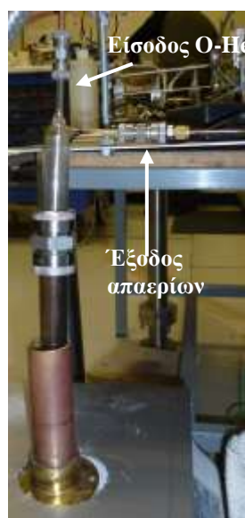
Σχήμα 4.13. Σημεία εισόδου μίγματος οξυγόνου-ηλίου και εξόδου των προς ανάλυση αερίων.
