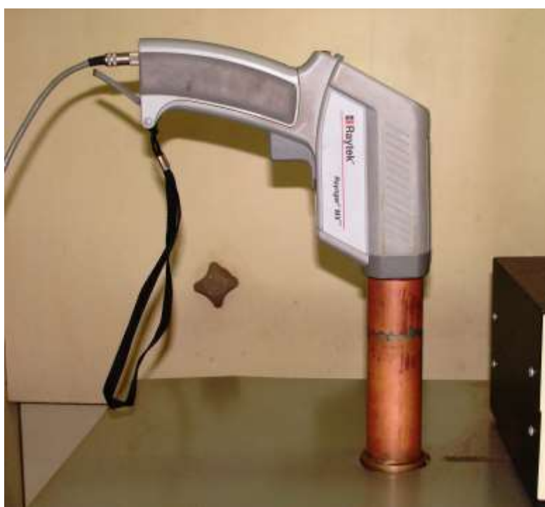
Σχήμα 4.4. Προσαρμογή οπτικού πυρομέτρου στο κυλινδρικό κυματοδηγό.
