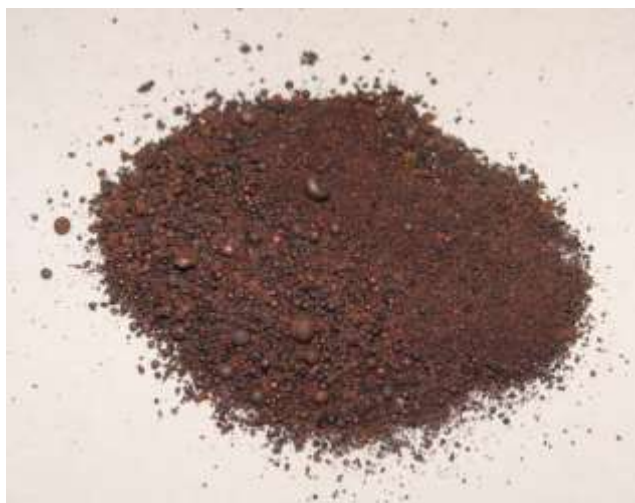
Σχήμα 5.22. Ανηγμένο δείγμα CuO ύστερα από 160 s θέρμανσης σε ισχύ 800 W.
