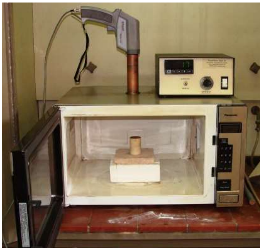
Σχήμα 4.3. Ο τροποποιημένος φούρνος Ceralink ThermWave 1.3.
