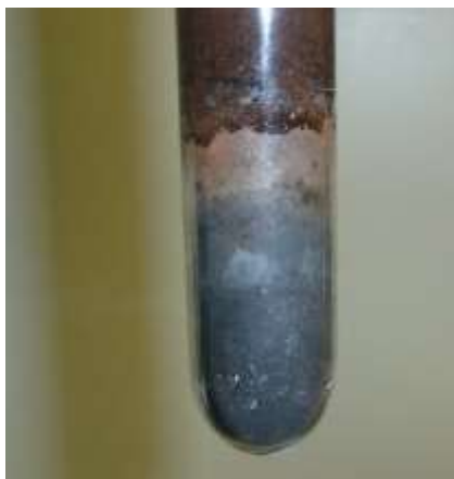
Σχήμα 4.14. Ανηγμένος λατερίτης μετά το πέρας της μικροκυματικής αναγωγής στον πυθμένα του κυλινδρικού δειγματοφορέα.
