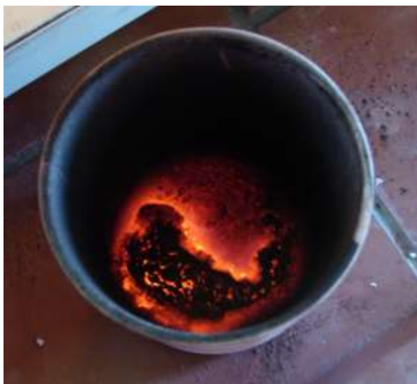
Σχήμα 6.19. Η άνω εξωτερική επιφάνεια μίγματος λατερίτη-λιγνίτη (συνολική μάζα 11.75 g, μάζα λιγνίτη 1.75 g) μόλις έχει εξέλθει από τον φούρνο ύστερα από θέρμανση στα 800 W για 360 s.
