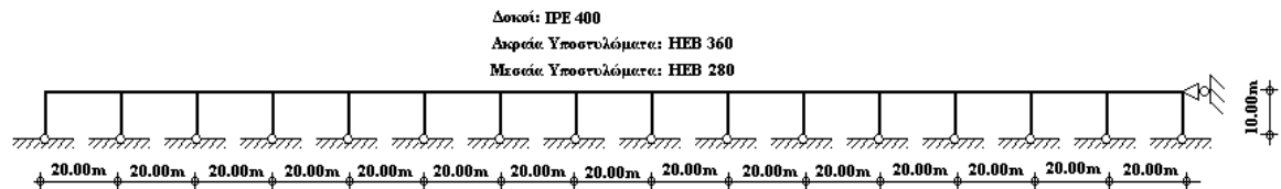
Σχήμα 3.52 Αμετάθετο πλαίσιο με δεκαπέντε φατώματα
