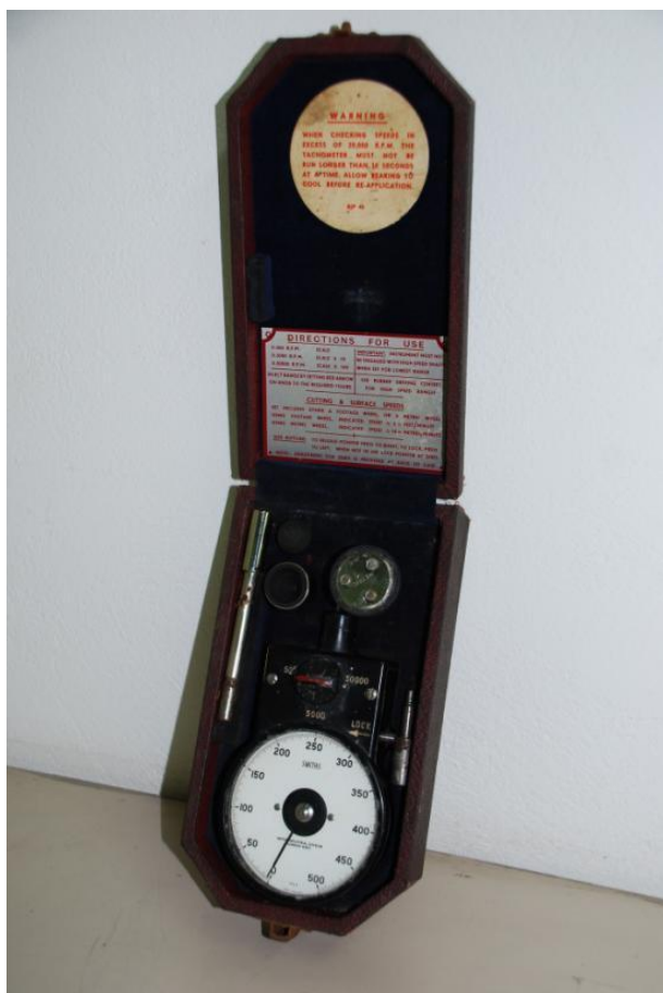
Σχήμα 3-18 : Στροφόμετρο χειρός της εταιρείας Smiths
