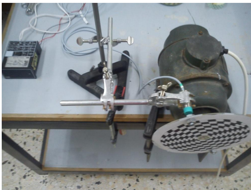
Σχήμα 3-14: Πειραματική εγκατάσταση βαθμονόμησης επαγωγικού αισθητήρα
