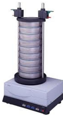
Σχήμα 3-26 : Συσκευή ανάλυσης κοκκομετρίας Retch AS200
