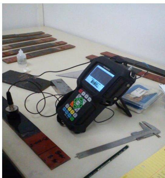
Σχήμα 3.31: Όργανο μέτρησης για τη μέθοδο NDT
