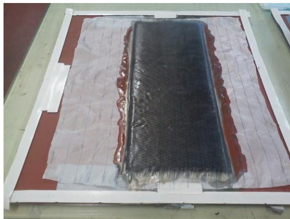
Σχήμα 3.12: Τοποθέτηση peel ply επάνω στο σύνθετο υλικό
