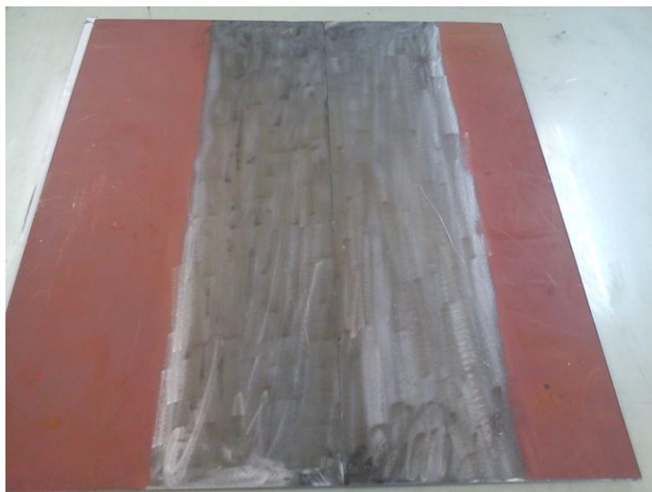
Σχήμα 2.28: Μεταλλικές πλάκες που χρησιμοποιήθηκαν για την κατασκευή των συνδέσμων H-100
