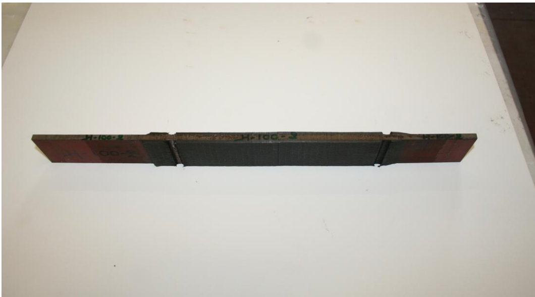
Σχήμα 3. 42: Κοπές σύνθετου υλικού για την επίτευξη του επιθυμητού μήκους επικάλυψης
