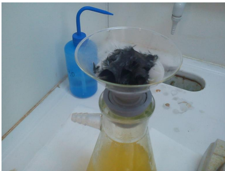
Σχήμα 3.7: Διαδικασία διάλυσης σύνθετου υλικού για μέτρηση της περιεκτικότητας σε ίνες άνθρακα
