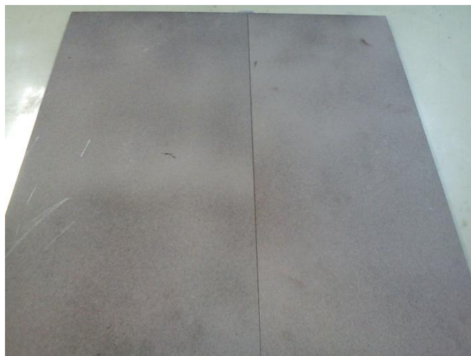
Σχήμα 2.23: Μεταλλικές πλάκες που χρησιμοποιήθηκαν για την κατασκευή των συνδέσμων S-50
