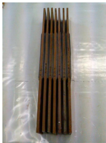
Σχήμα 3.21: Δοκίμια συνδέσμου A-50
