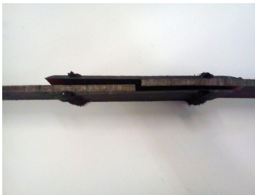
Σχήμα 4.18: Θραύση δοκιμίου με αποκόλληση του σύνθετου υλικού αντισυμμετρικά
