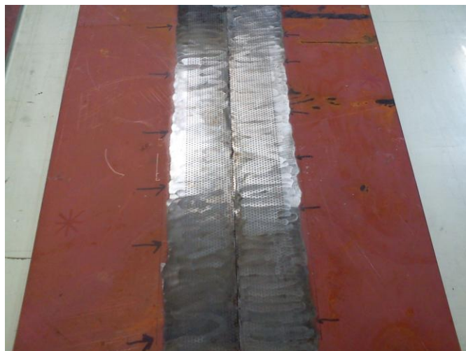
Σχήμα 2.22: Μεταλλικές πλάκες που χρησιμοποιήθηκαν για την κατασκευή των συνδέσμων B-50
