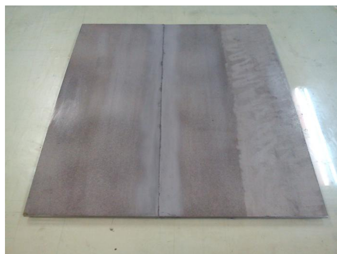
Σχήμα 2.27: Μεταλλικές πλάκες που χρησιμοποιήθηκαν για την κατασκευή των συνδέσμων S-100
