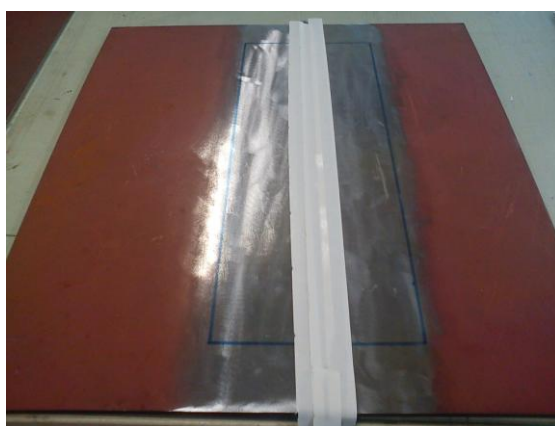
Σχήμα 3.9: Τοποθέτηση tacky tape στην ένωση των δύο μεταλλικών πλακών στην αντίθετη πλευρά από αυτή στην οποία πρόκειται να κατασκευαστεί το σύνθετο υλικό
