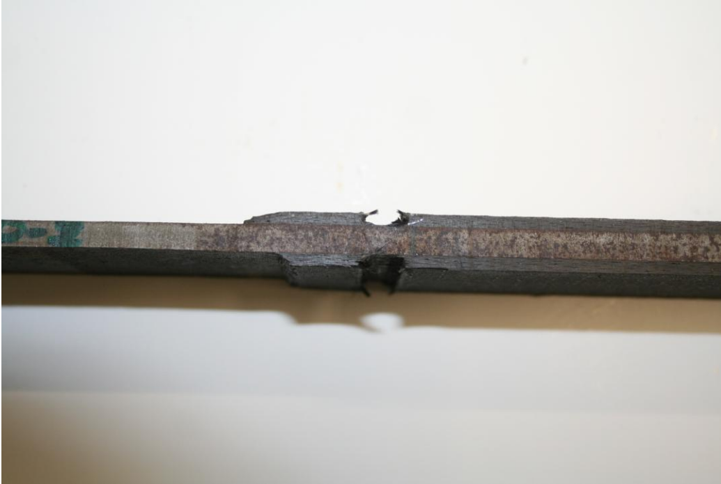
Σχήμα 3.41: Κοπές σύνθετου υλικού για την επίτευξη του επιθυμητού μήκους επικάλυψης
