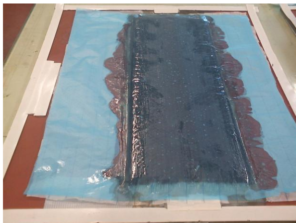
Σχήμα 3.13: Τοποθέτηση perforated foil επάνω στο σύνθετο υλικό
