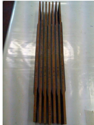
Σχήμα 3.27: Δοκίμια συνδέσμου S-100
