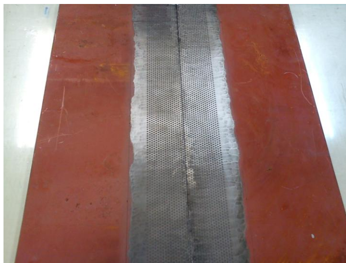
Σχήμα 2.21: Μεταλλικές πλάκες που χρησιμοποιήθηκαν για την κατασκευή των συνδέσμων A-50
