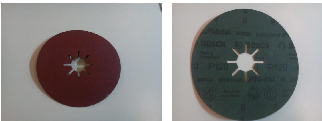
Σχήμα 2.6: Γυαλόχαρτο που χρησιμοποιήθηκε για τη μέθοδο επιφανειακής επεξεργασίας με το χέρι
