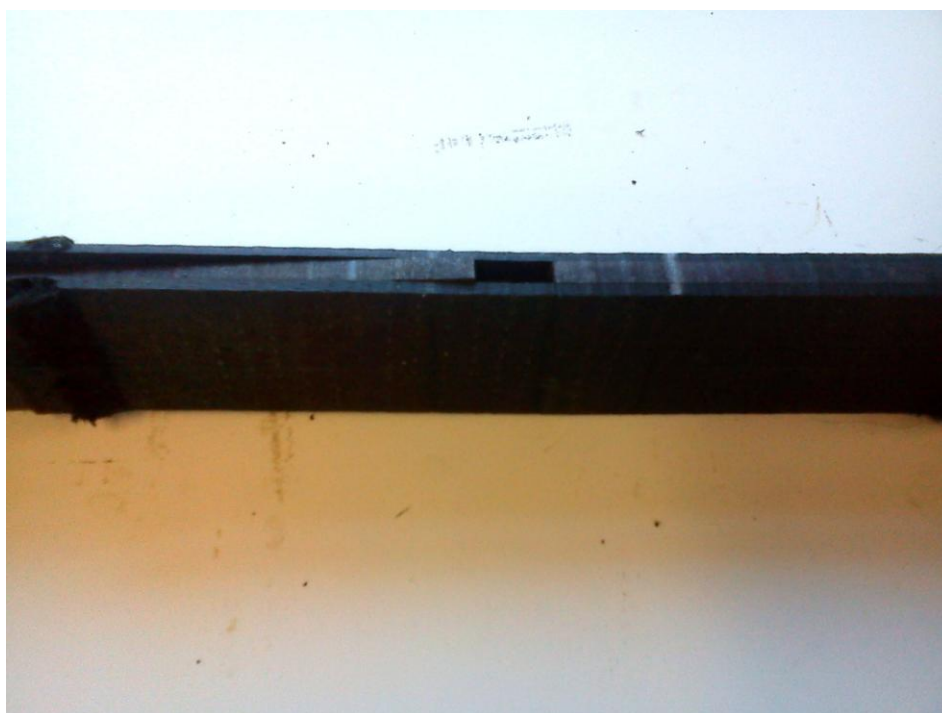
Σχήμα 4.21: Θραύση δοκιμίου με πλήρη αποκόλληση του σύνθετου υλικού από τις δύο πλευρές της μίας μεταλλικής πλάκας
