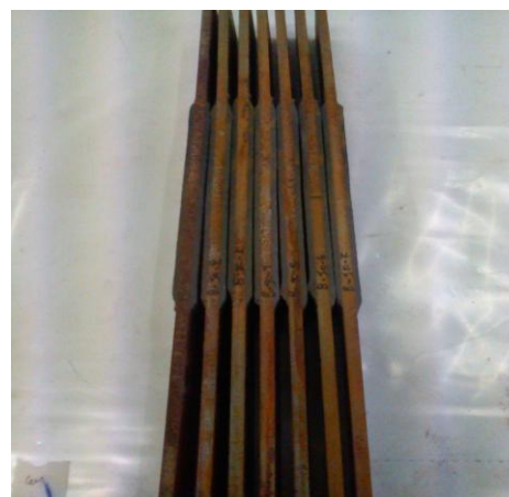
Σχήμα 3.22: Δοκίμια συνδέσμου B-50
