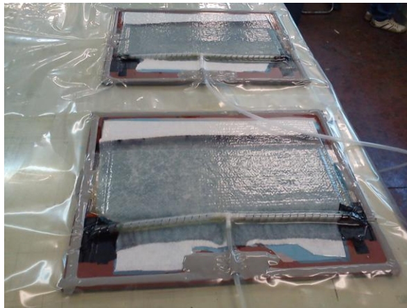
Σχήμα 3.17: Στερεοποίηση του σύνθετου υλικού επάνω στις μεταλλικές πλάκες
