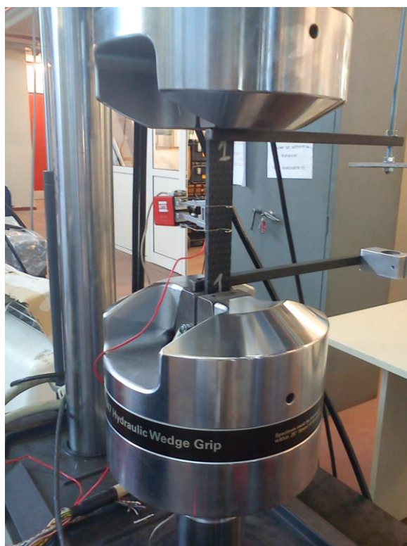
Σχήμα 3.3: Χαρακτηριστικό παράδειγμα φόρτισης δοκιμίου από σύνθετο υλικό σε εφελκυσμό
