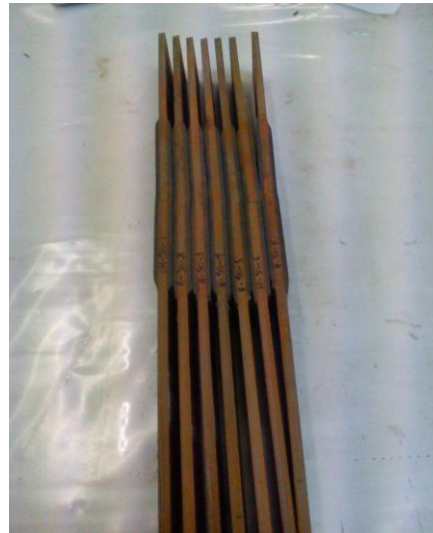
Σχήμα 3.24: Δοκίμια συνδέσμου H-50
