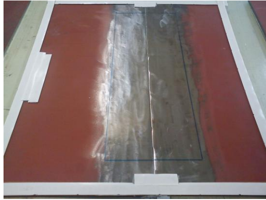
Σχήμα 3.10: Τοποθέτηση tacky tape επάνω στις μεταλλικές επιφάνειες στην πλευρά όπου πρόκειται να κατασκευαστεί το σύνθετο υλικό, προκειμένου να επιτευχθεί αεροστεγές κλείσιμο με το vacuum bag
