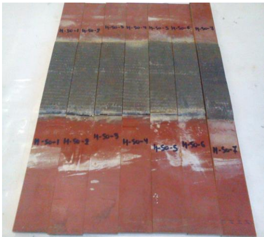
Σχήμα 3.24: Δοκίμια συνδέσμου H-50
