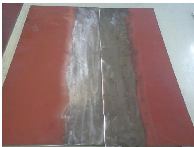
Σχήμα 2.24: Μεταλλικές πλάκες που χρησιμοποιήθηκαν για την κατασκευή των συνδέσμων H-50
