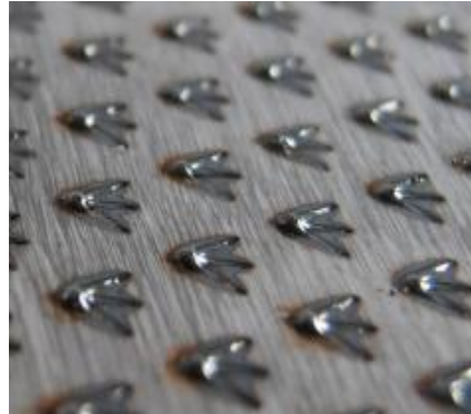
Σχήμα 2.2: Άποψη της επιφάνειας θετικής τραχύτητας A και κατανομή της μικροδομής
