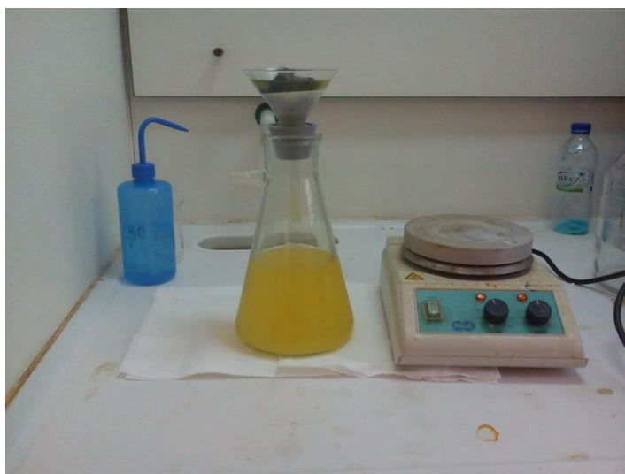
Σχήμα 3.6: Διαδικασία διάλυσης σύνθετου υλικού για μέτρηση της περιεκτικότητας σε ίνες άνθρακα
