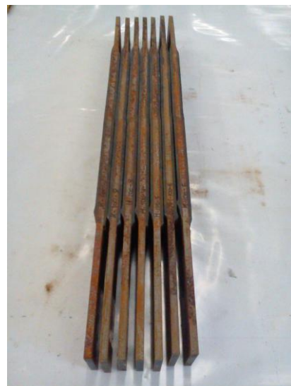
Σχήμα 3.28: Δοκίμια συνδέσμου Η-100
