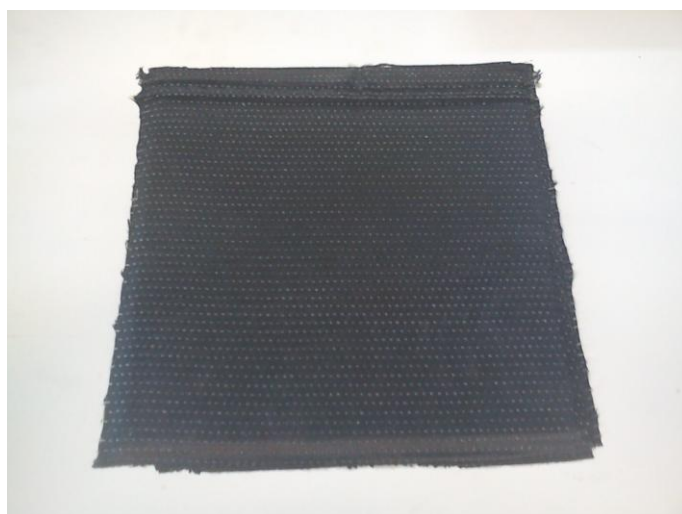
Σχήμα 3.1: Πολύστρωτο από ίνες άνθρακα και εποξική ρητίνη για το χαρακτηρισμό του υλικού
