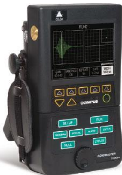
Σχήμα 3.29: Όργανο BondMaster 1000e+ για την ανίχνευση αποκολλήσεων σε σύνθετα υλικά και κολλητούς συνδέσμους (olympus.com)
