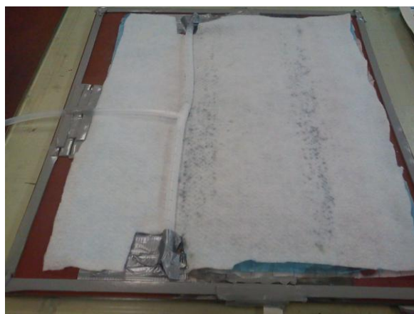
Σχήμα 3.15: Τοποθέτηση σωλήνος για την εφαρμογή του κενού
