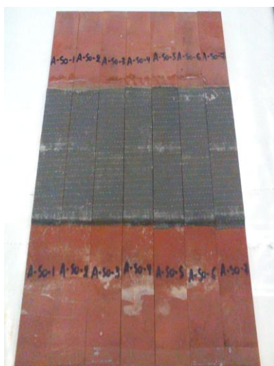
Σχήμα 3.21: Δοκίμια συνδέσμου A-50
