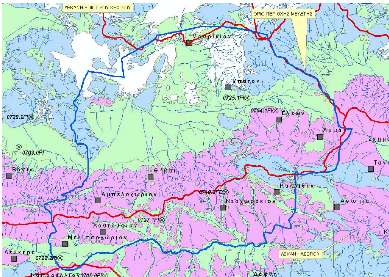
Σχήμα 2.2.3-1. Γεωτρήσεις δειγματοληψίας ΚΥΥ στη λεκάνη Θηβών. Κόκκινη γραμμή: υδροκρίτης. Γαλάζια γραμμή: όριο περιοχής ενδιαφέροντος. Τετράγωνα: οικισμοί. Κύκλοι: γεωτρήσεις δειγματοληψίας. Πράσινες περιοχές: προσχώσεις. Ρόζ περιοχές: νεογενή. Γαλάζιες περιοχές: σχηματισμοί υποβάθρου.
