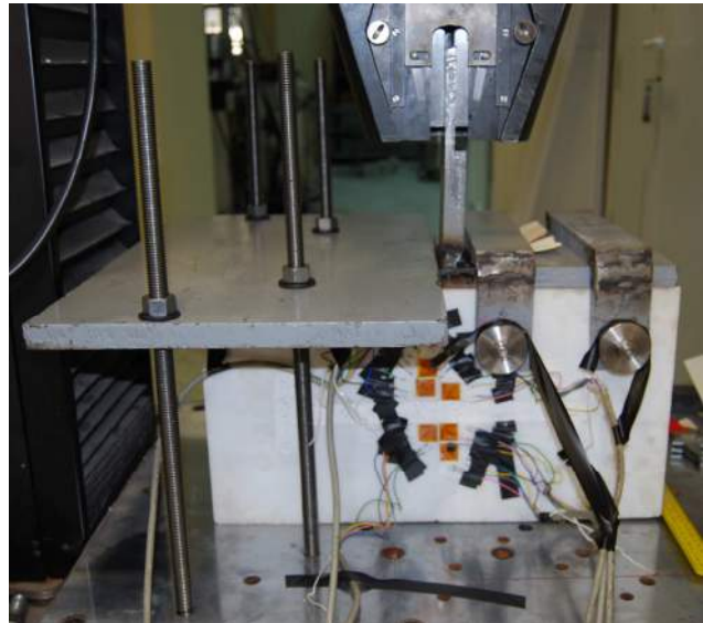
Εικ. 5.8: Δοκίμιο τύπου I τοποθετημένο στην τράπεζα του πλαισίου φόρτισης πριν την έναρξη της δοκιμής.
