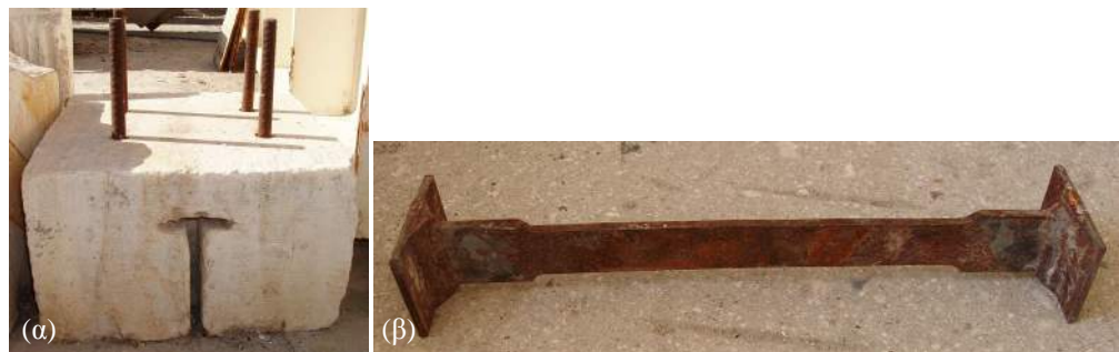
Εικ. 1.18: (α) Ο ένας εκ των δύο όγκων μαρμάρου και (β) ο ένας εκ των δύο σιδερένιων συνδέσμων των δοκιμών εφελκυσμού [6].
