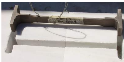
Εικ. 1.13: Σύνδεσμος τιτανίου μορφής “Γ” και η εντορμία στην οποία θα εισαχθεί.
