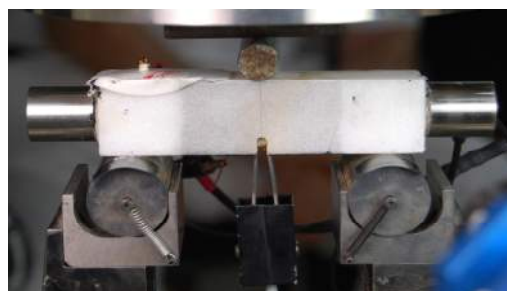
Εικ. 3.24: Ένα τυπικό δοκίμιο στο πλαίσιο φόρτισης αμέσως πριν ξεκινήσει η δοκιμή.
