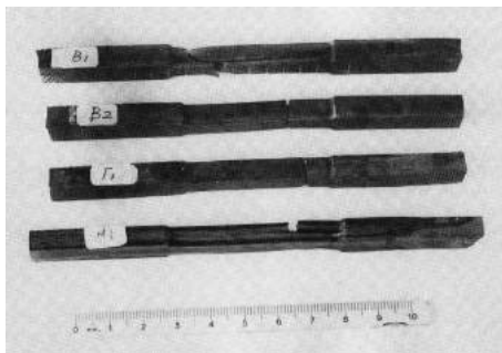
Εικ. 3.4: Δοκίμια εφελκυσμού αρχαίου δομικού σιδήρου. Η σημαντική διαφορά στην παραμόρφωση θραύσης είναι εμφανής [6].
