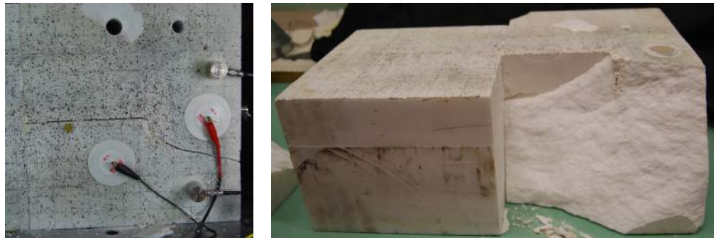
Εικ. 5.14: Κωνικής μορφής θραύση του επιστυλίου.
