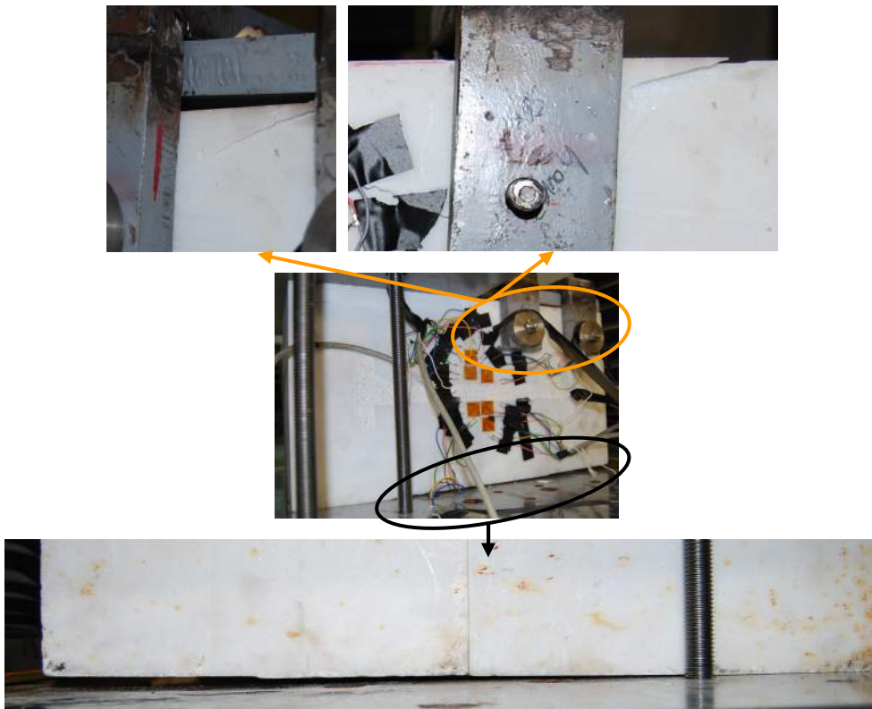
Εικ. 5.12: Αδυναμίες της πρώτης πειραματικής διάταξης.
