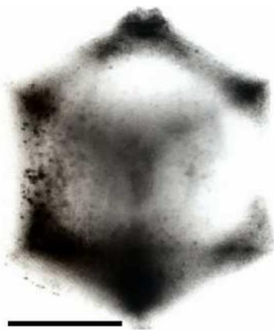
Εικόνα 3-11: Απεικόνιση TEM του ασβεστίτη. Η γραμμή στο κάτω αριστερά μέρος της εικόνας έχει μέγεθος 100nm.
