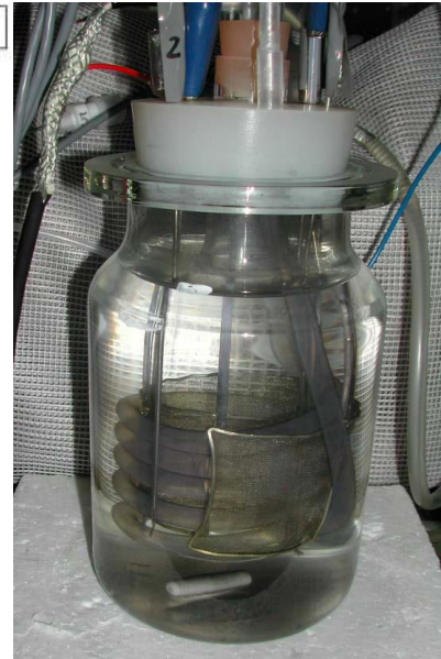
Εικόνα 3-18: Μια βασική πειραματική διάταξη για την προτεινόμενη μέθοδο παραγωγής υδρογόνου.
