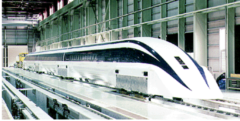
Σχ. 1.25 Το Ιαπωνικό υπεραγώγιμο τρένο Maglev MLX01 σε περίοδο δοκιμών [1.43]
