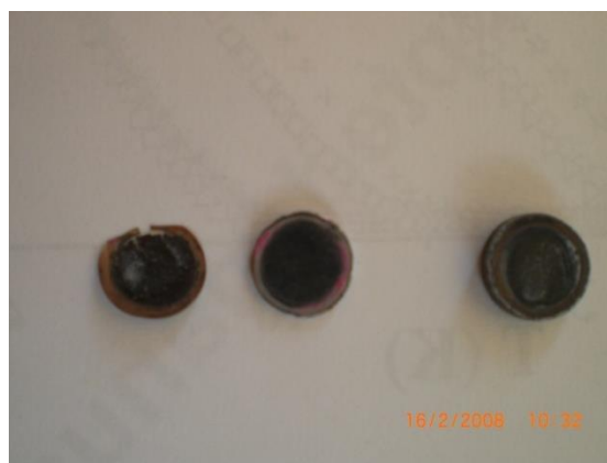
Σχ. 3.3 Δισκία MgB 2 μετά την ολοκλήρωση της θερμικής κατεργασίας
