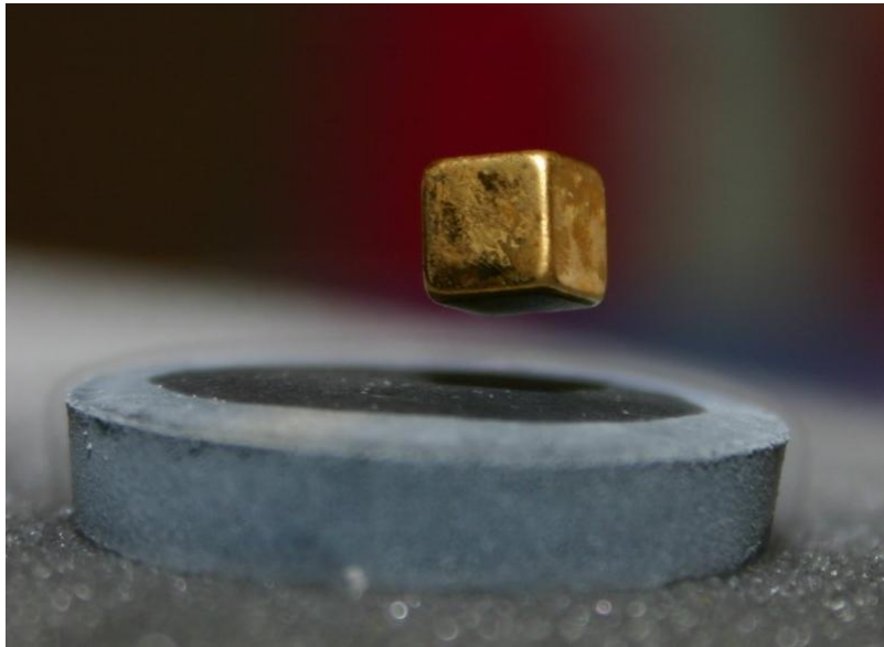
Σχ. 1.5 Μαγνητική αιώρηση μαγνήτη πάνω από έναν υπεραγωγό ο οποίος βρίσκεται σε θερμοκρασία μικρότερη της T_c [1.15]
