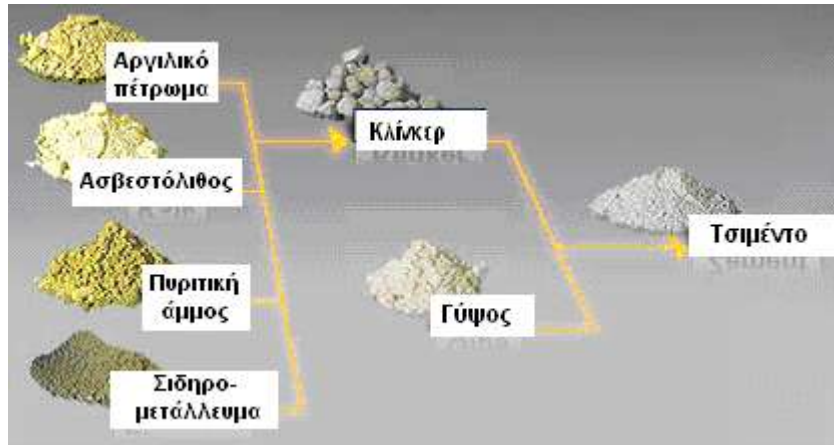
Εικόνα 1.1 Πρώτες ύλες, ενδιάμεσα προϊόντα και τελικό προϊόν στη διεργασία παραγωγής τσιμέντου. (Τσακαλάκης Κ., 2010)
