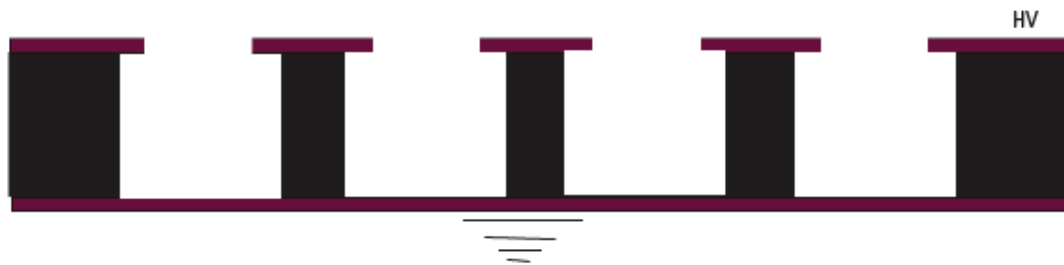
Σχ. 3.7 Pillars από karton σχηματίζονται κάτω από τον χαλκό για κάθε pitch του mesh [16]
