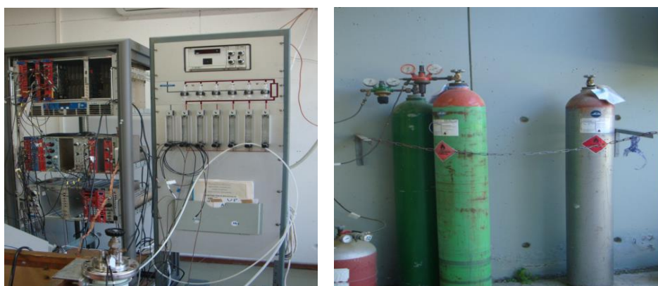
Σχ. 4.7 Η gas flow Μονάδα και η μπουκάλα Αργού-Ισοβουτανιού
