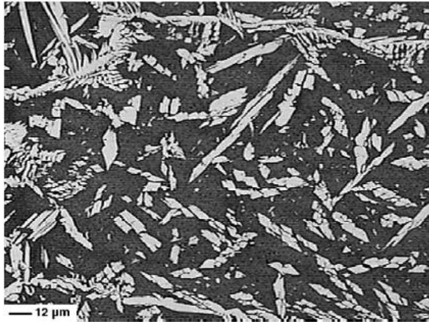
Εικόνα 6.10. Μικροδομή μετάλλου συγκόλλησης (μέθοδος GTAW)
