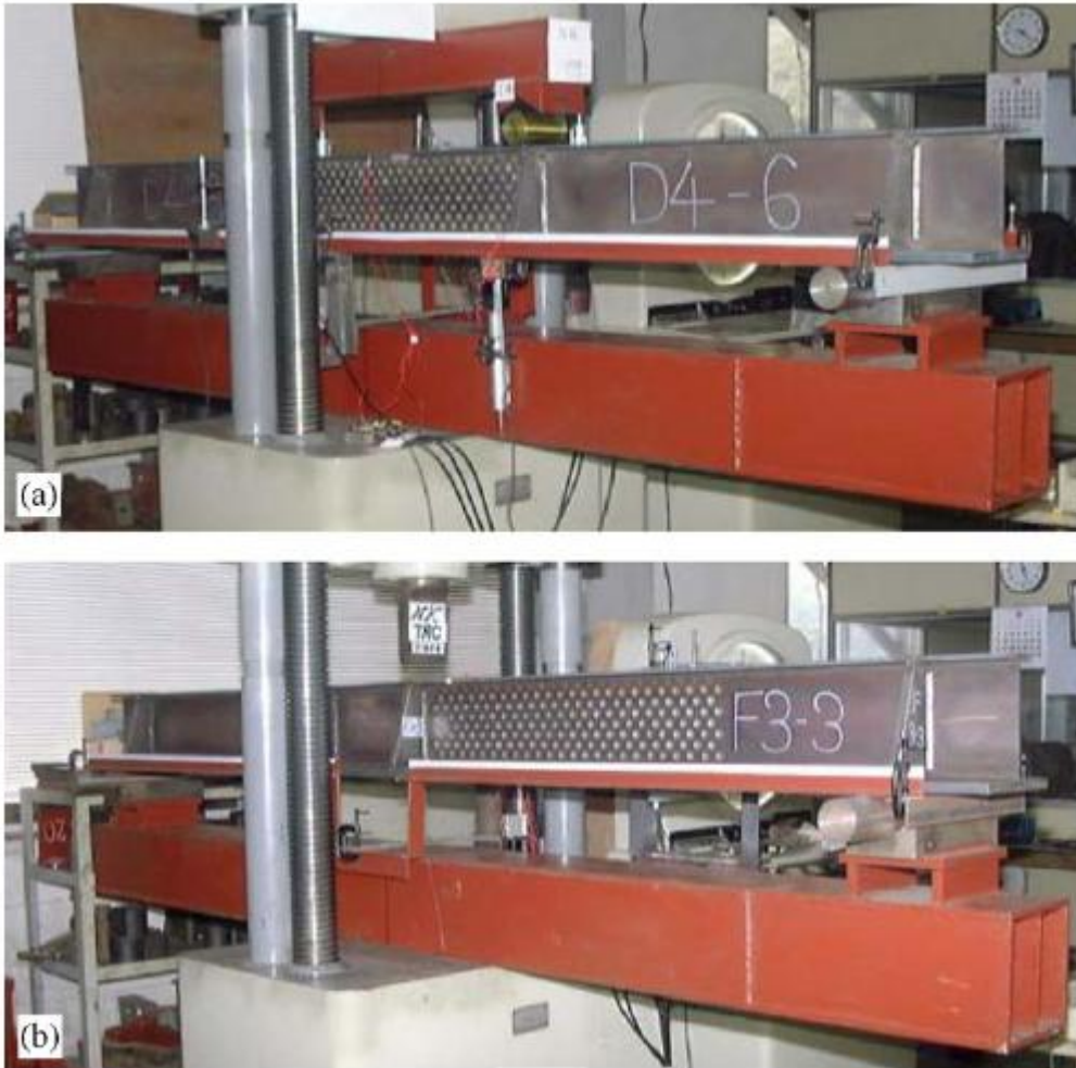
Εικόνα 4.11. Δοκίμια για τα πειράματα κάμψης τριών και τεσσάρων σημείων.
