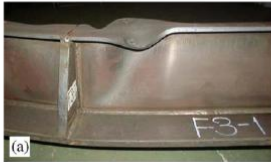
Εικόνα 4.17. Τοπικός λυγισμός του face plate του δοκιμίου.
