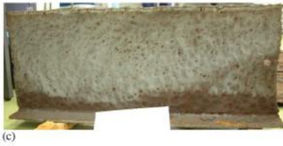
Εικόνα 4.4. Διάβρωση με βελονισμούς στους νομείς ενός Bulk carrier 14 ετών.
