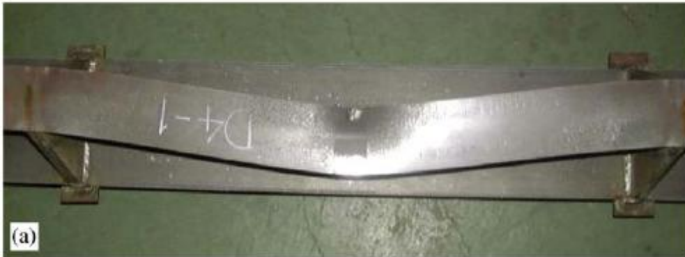
Εικόνα 4.13. Παραμόρφωση του face plate του δοκιμίου:
