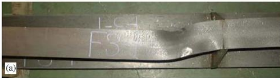
Εικόνα 4.18. Παραμόρφωση του face plate του δοκιμίου:
