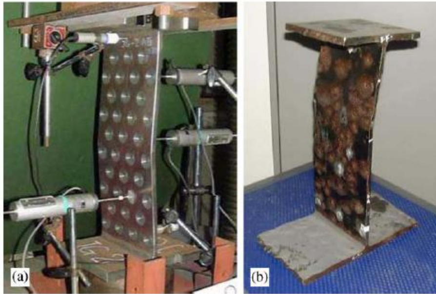
Εικόνα 4.10. Δοκίμια που υποβλήθηκαν σε θλιπτική καταπόνηση.
