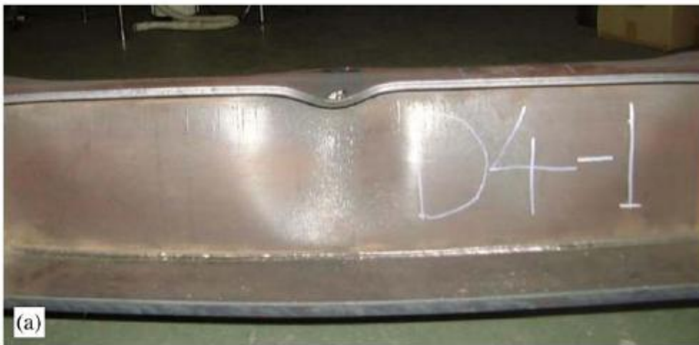
Εικόνα 4.14. Τοπικός λυγισμός του face plate του δοκιμίου:
