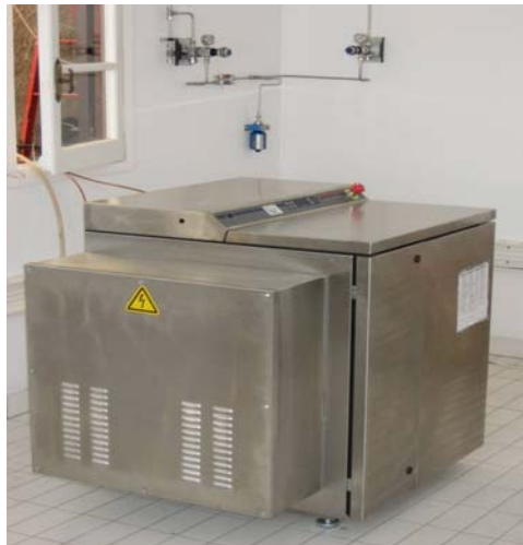
Εικόνα II.1.3: Μονάδα ηλεκτρόλυσης του νερού τεχνολογίας μεμβράνης εναλλαγής πρωτονίων (PEM)
