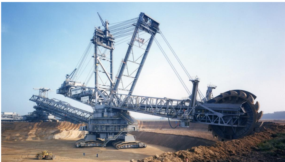
Εικόνα 2.1 Καδοφόρος εκσκαφέας (ιστότοπος ThyssenKrupp AG)
