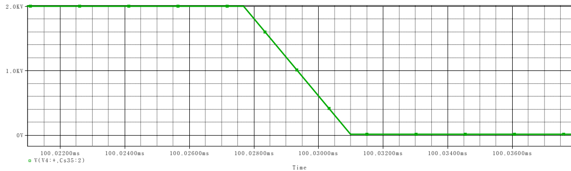
Σχήμα 5.12 Τάση έναυσης διακόπτη με RL φορτίο
