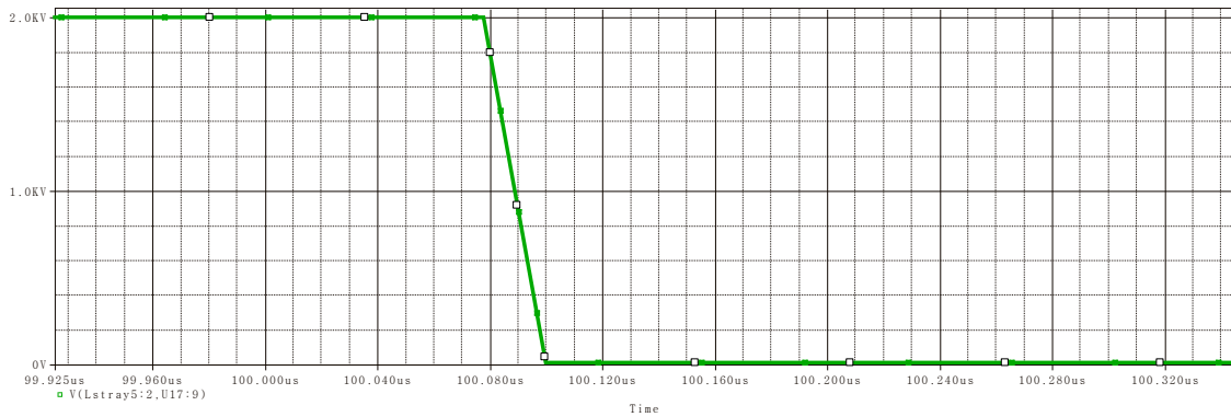
Σχήμα 5.31 Τάση έναυσης διακόπτη με RL φορτίο
