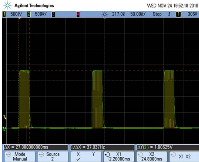
Σχήμα 4.19. Πράσινο: Τάση στα άκρα του ρυθμιστή τάσης. Κίτρινο: Παλμοσειρά σε ακροδέκτη του μικροελεγκτή για ρολόι λειτουργίας 2MHz και ισχύ εισόδου -2.5 dBm στα 430 MHz.
