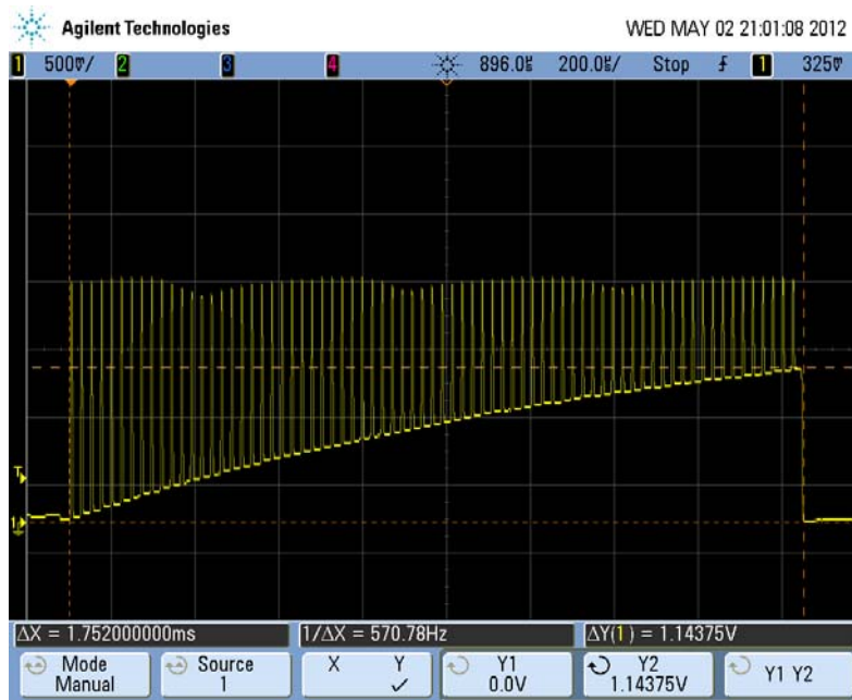
Σχήμα 3.21. Τάση στο κοινό άκρο των δύο πυκνωτών κατά τη μέτρηση άγνωστης σταθερής χωρητικότητας με τη μέθοδο διακοπόμενων πυκνωτών (Συχνότητα λειτουργίας του μικροελεγκτή f_{\text{CLOCK}} = 2 \text{ MHz} , C_{\text{SEN}} = 100 \text{ pF} , C_{\text{INT}} = 10 \text{ nF} ). Μεταφορά φορτίου στη χωρητικότητα C_{\text{INT}} (εκθετική φόρτιση).
