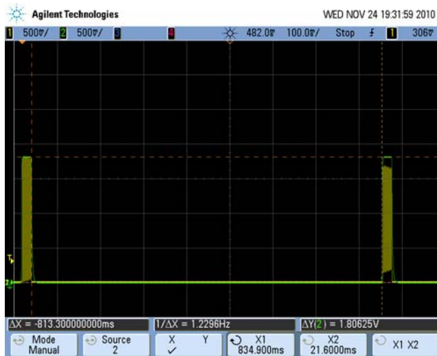
Σχήμα 4.18. Πράσινο: Τάση στα άκρα του ρυθμιστή τάσης. Κίτρινο: Παλμοσειρά σε ακροδέκτη του μικροελεγκτή για ρολόι λειτουργίας 2MHz και ισχύ εισόδου -5.4 dBm στα 430 MHz.
