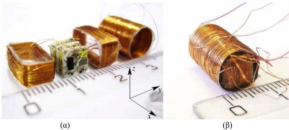
Σχήμα 2.7. (α) Τρία σωληνοειδή πηνία λήψης για παθητικό κόμβο που λειτουργεί με επαγωγική ζεύξη με τα ηλεκτρονικά λήψης. (β) Το σύστημα συναρμολογημένο [11].
