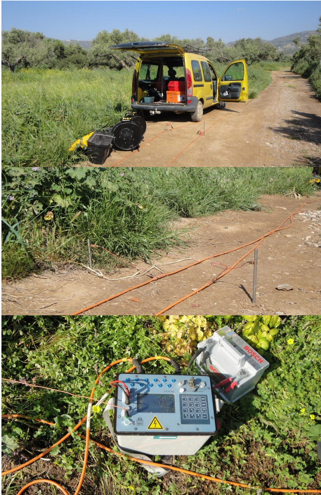
Εικόνα 5.8: Ο εξοπλισμός που χρησιμοποιήθηκε για τις μετρήσεις της ηλεκτρικής τομογραφίας.
