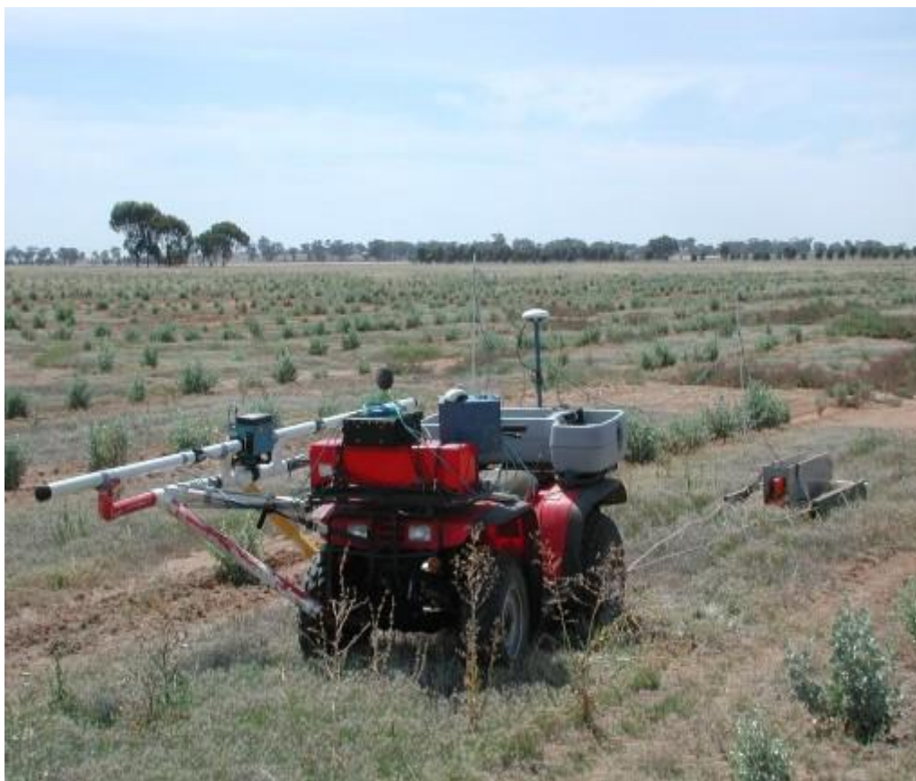
Εικόνα 3.1: Τετράτροχο όχημα για την κάλυψη της περιοχής της έρευνας εξοπλισμένο με τα απαραίτητα όργανα μέτρησης.
