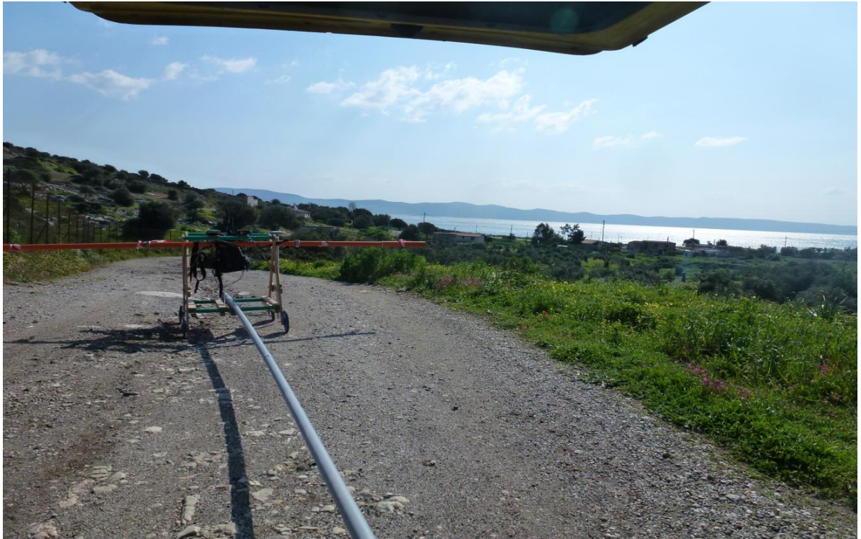
Εικόνα 1.3: Το αμαξίδιο που μεταφέρει το ηλεκτρομαγνητικό όργανο μέτρησης CMD4 και το διαφορικό GPS τα οποία σύρονται από αυτοκίνητο μέσω πλαστικού σωλήνα 6μ. στην περιοχή του Θορικού.
