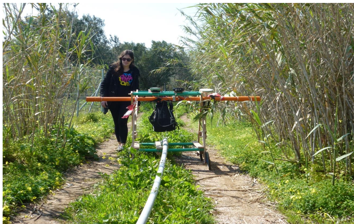
Εικόνα 1.6: Το κινούμενο αμαξίδιο όπου φαίνονται τα μέρη του ηλεκτρομαγνητικού οργάνου μέτρησης CMD2 και του διαφορικού GPS σε δύσκολες συνθήκες στην περιοχή του Θορικού.
