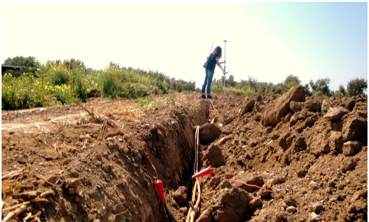
Εικόνα 1.4: Μέτρηση με το διαφορικό GPS της θέσης και του υψομέτρου κάθε ηλεκτροδίου στις τομές γεωηλεκτρικής τομογραφίας.
