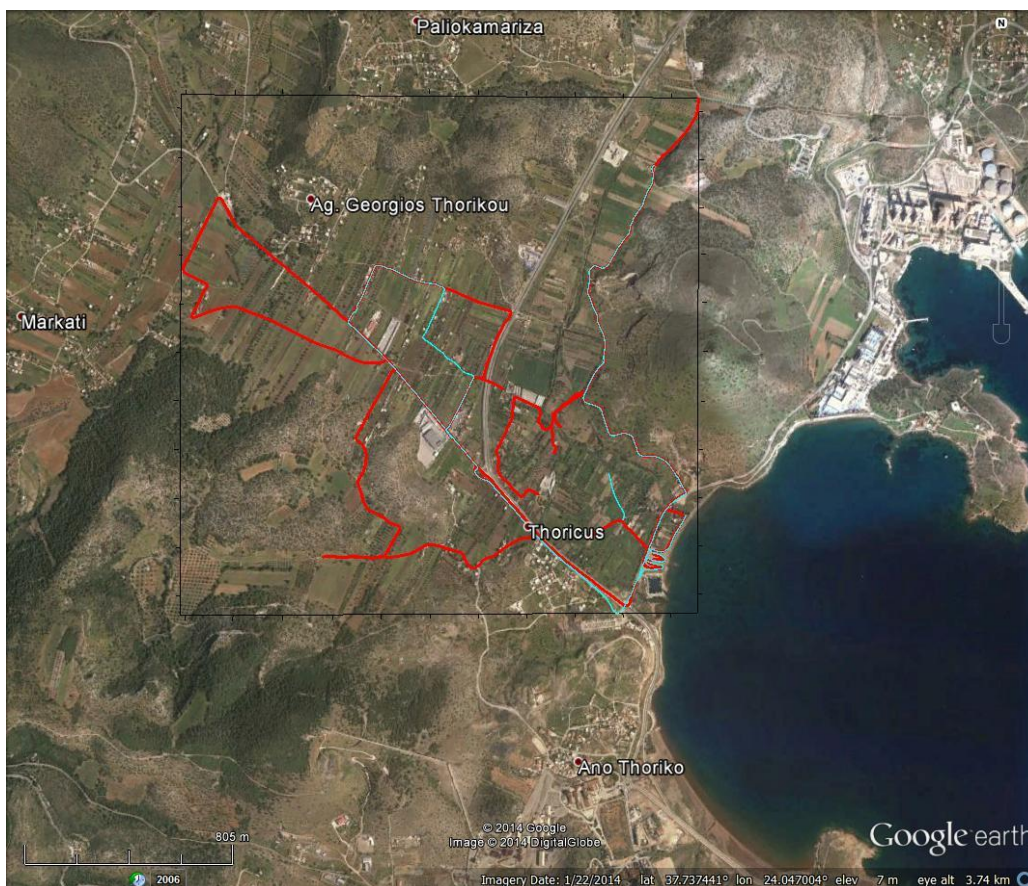
Εικόνα 5.6: Διαδρομές μέτρησης με το ηλεκτρομαγνητικό όργανο EM-31, για συνολικά βάθη διασκόπησης 3 μέτρα και 6 μέτρα, αποτυπωμένες στο Google Earth. Η κόκκινη γραμμή αποτυπώνει τις μετρήσεις με συνολικό βάθος διασκόπησης 3 μέτρα, ενώ η γαλάζια γραμμή αφορά τις μετρήσεις με συνολικό βάθος διασκόπησης τα 6 μέτρα.
