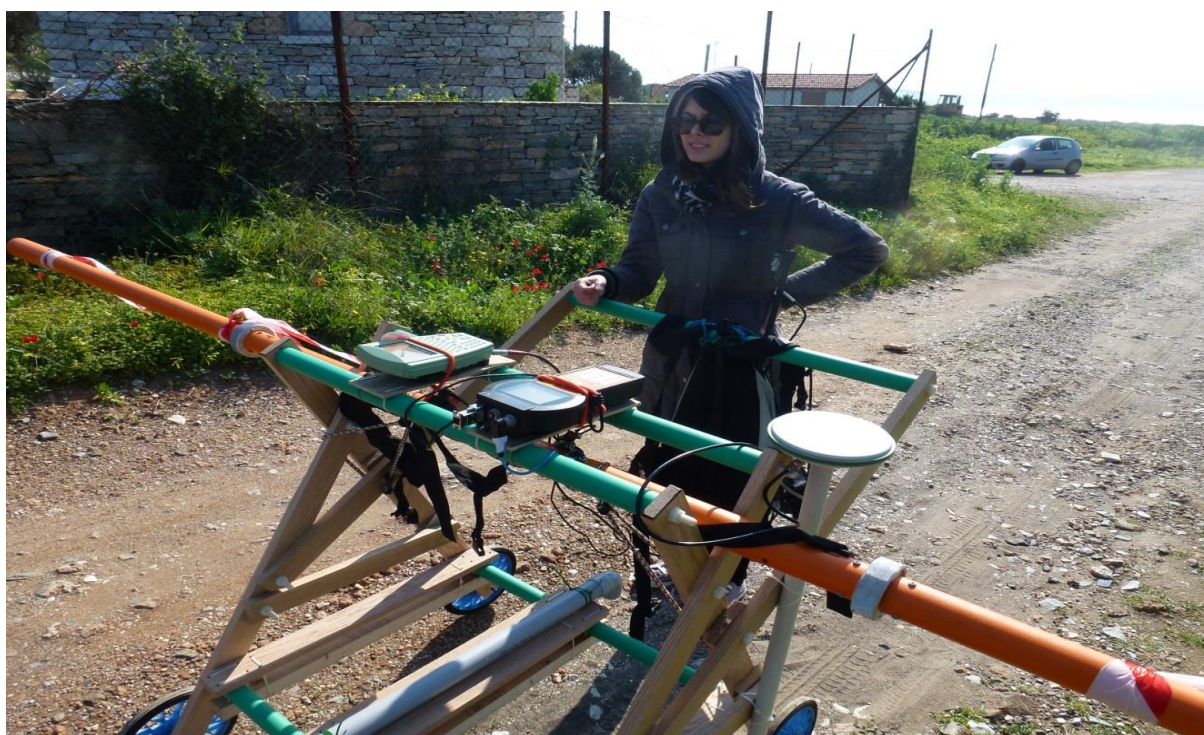
Εικόνα 1.5: Το κινούμενο αμαξίδιο όπου φαίνονται τα μέρη του ηλεκτρομαγνητικού οργάνου μέτρησης CMD4 και του διαφορικού GPS.
