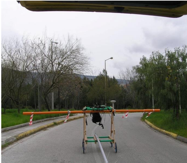
Εικόνα 4.1 : Το ηλεκτρομαγνητικό όργανο μέτρησης, τοποθετημένο στο αυτοσχέδιο καρότσι στην Πολυτεχνειούπολη Ζωγράφου.
