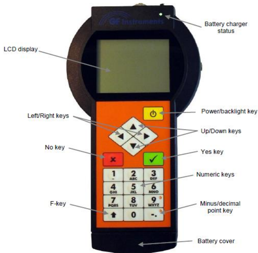
Σχήμα 2.5 : Χειριστήριο ηλεκτρομαγνητικού οργάνου CMD4
