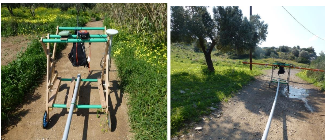
Εικόνα 5.7: Το τροχήλατο ρυμουλκούμενο όχημα που χρησιμοποιήθηκε για την κάλυψη μεγάλων αποστάσεων με το ηλεκτρομαγνητικό όργανο μέτρησης CMD4 και το όργανο λήψης συντεταγμένων GPS.
