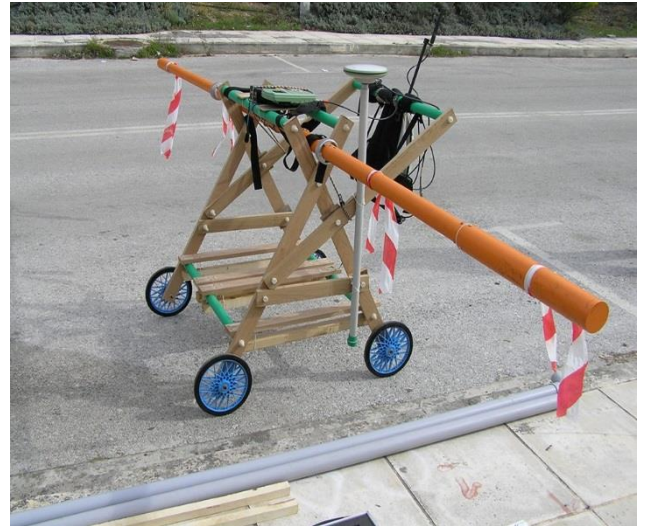
Εικόνα 4.1 : Το ηλεκτρομαγνητικό όργανο μέτρησης, τοποθετημένο στο αυτοσχέδιο καρότσι στην Πολυτεχνειούπολη Ζωγράφου.
