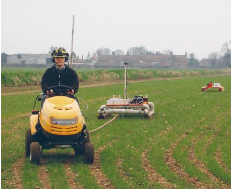
Εικόνα 3.2: Έρευνα με το GEEP, για ρυμούλκηση του οργάνου μέτρησης της ηλεκτρικής αγωγιμότητας EM34.
