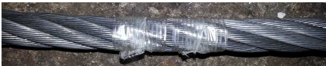
Εικόνα 5.1: Το συρματόσχοινο φιμώνεται εκατέρωθεν του σημείου κοπής με κολλητική ταινία
