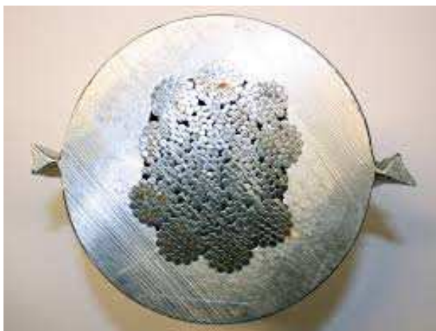
Εικόνα 5.6 Φωτογραφία τομής συνδετικού δακτυλίου μετά το πρεσάρισμα
