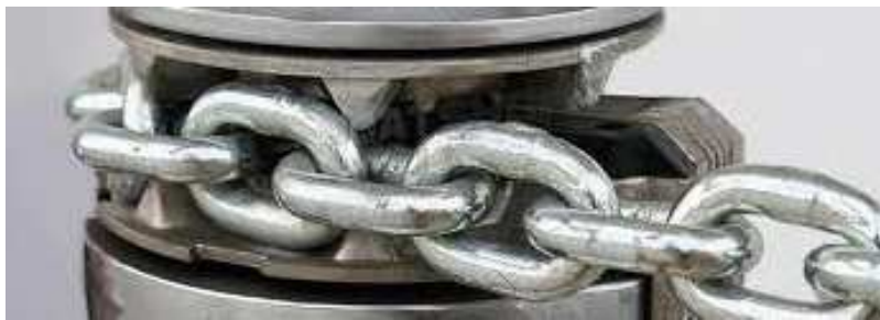
Φωτογραφία 4.8 Αλυσίδα κατά DIN 766 σε αλυσέλικτρο βαρούλκου άγκυρας
