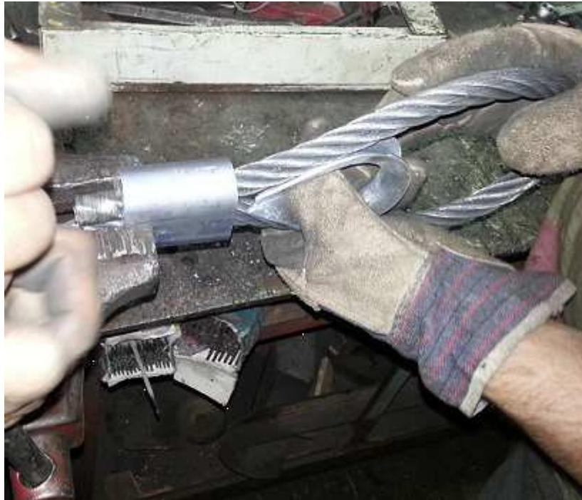
Εικόνα 5.3: Τοποθέτηση ροδάντζας και ρύθμιση θηλιάς
