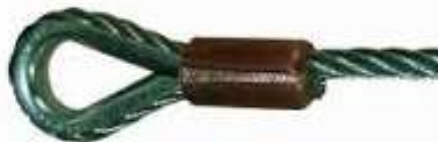
Εικόνα 1.3 Θηλιά με ροδάντζα ανοξειδωτο συρματόσχοινο ασφαλισμένη με συνδετικό δακτύλιο χαλκού
