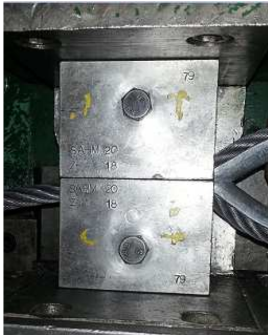
Εικόνα 5.5: Ο σχηματισμός του συνδέσμου ολοκληρώνεται μόλις τα καλούπια έρθουν σε επαφή
