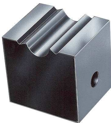
Εικόνα 5.4: Το ένα από τα δύο πανομοιότυπα τμήματα καλουπιού για پرسάρισμα συνδετικών δακτυλίων αλουμινίου
