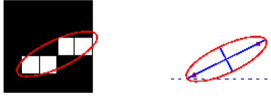
Εικόνα 3.1 Ισοδύναμη έλλειψη που περικλείει τις μικροασβεστώσεις ενός συμπλέγματος δύο μικροασβεστώσεων.
