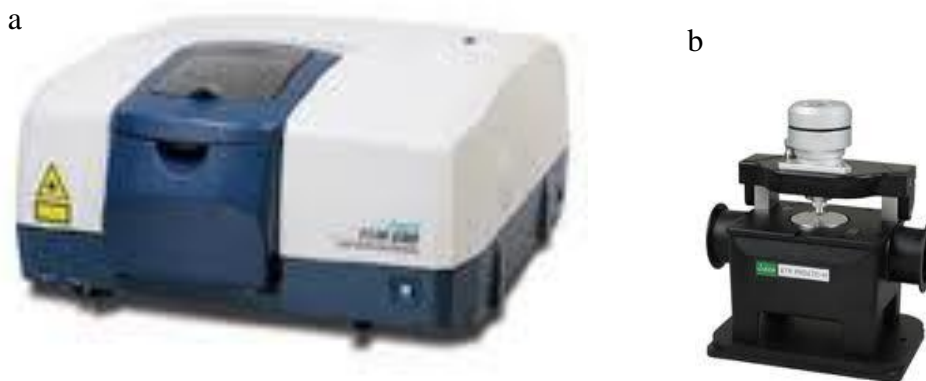
Εικόνα 3. a) Κεντρική μονάδα IR και b) Δειγματοφορέας.
