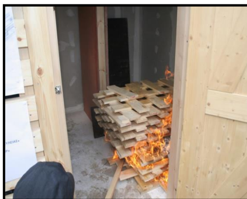
Εικόνα 9. Έναυση του κινητού πυροθερμικού φορτίου
