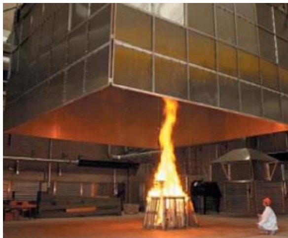
Εικόνα 14. Κατασκευή για τη μελέτη των παραγόμενων αερίων από την καύση των πολυμερών του εργαστηρίου FireSERT.
