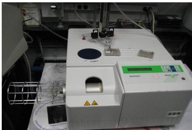
Εικόνα 1. Θερμοζυγός Mettler Toledo μοντέλου TGA/SDTA 851e.
