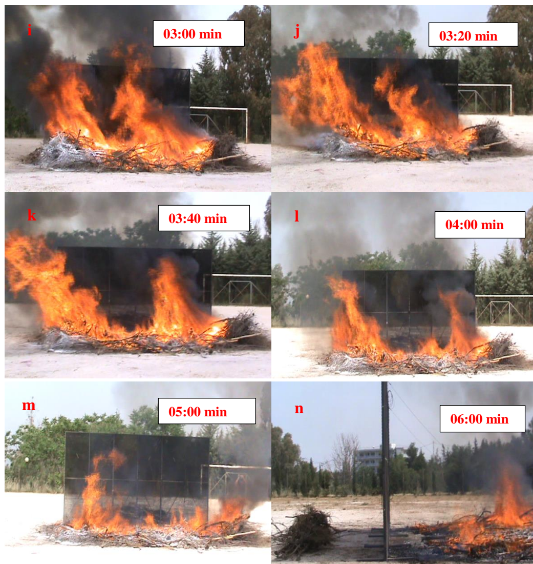
Εικόνα 16. Έναρξη και διάδοση φλόγας σε διάφορες χρονικές στιγμές.
