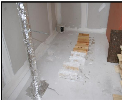
Εικόνα 12. Τα δοκίμια τοποθετημένα το ένα δίπλα στο άλλο σε ίσες αποστάσεις στο πάτωμα του οικίσκου μαζί με δυο θερμοστοιχεία.
