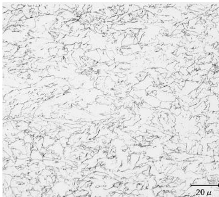
Εικόνα 2.18 Μικροδομή φερρίτη και μπαινίτη χάλυβα FCA.
