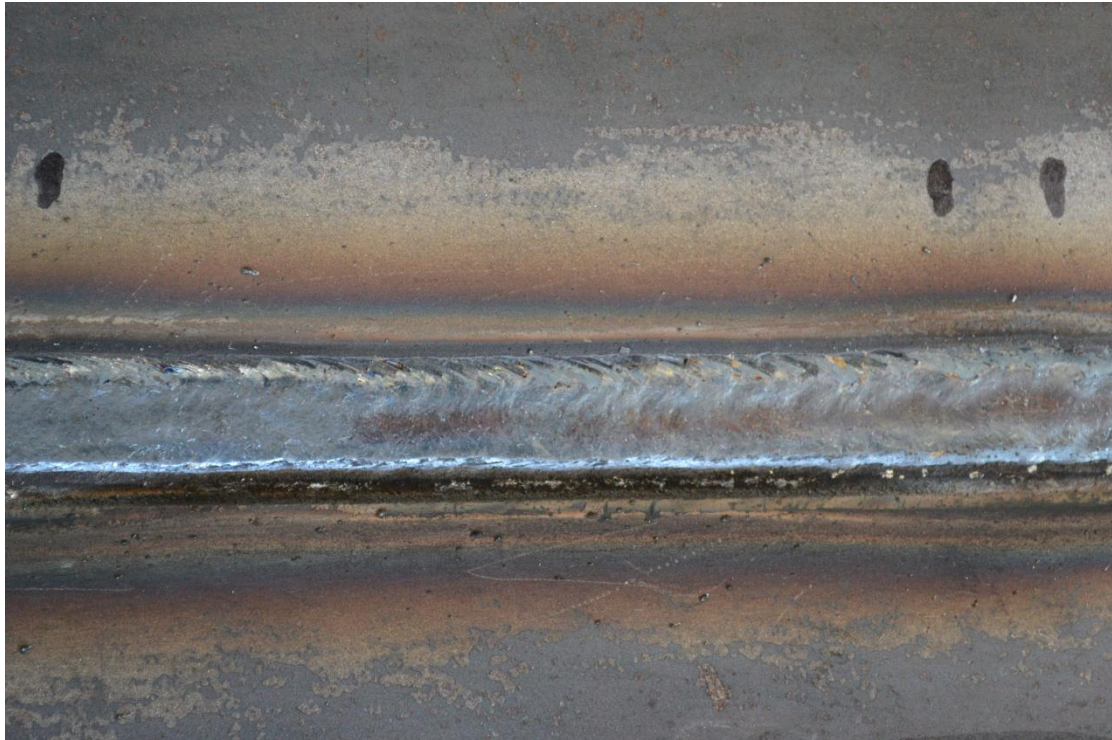
Εικόνα 4.53 Επιφάνεια ραφής, έπειτα από την εκτέλεση του 3 ου περάσματος επικάλυψης.
