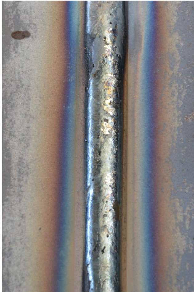
Εικόνα 4.46 Επιφάνεια ραφής της ρίζας συγκόλλησης.
