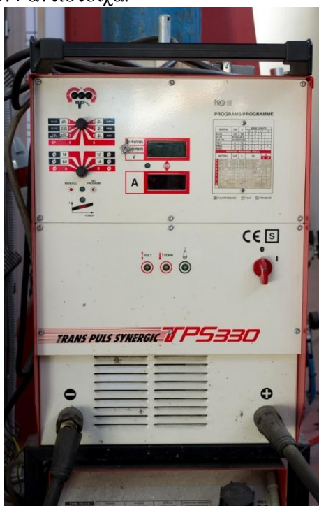
Εικόνες 3.2 , 3.3 Μηχανή συγκόλλησης σταθερής τάσης TPS330 του οίκου Fronius® και κύλινδρος, υψηλής πίεσης, παροχής αερίου προστασίας.
