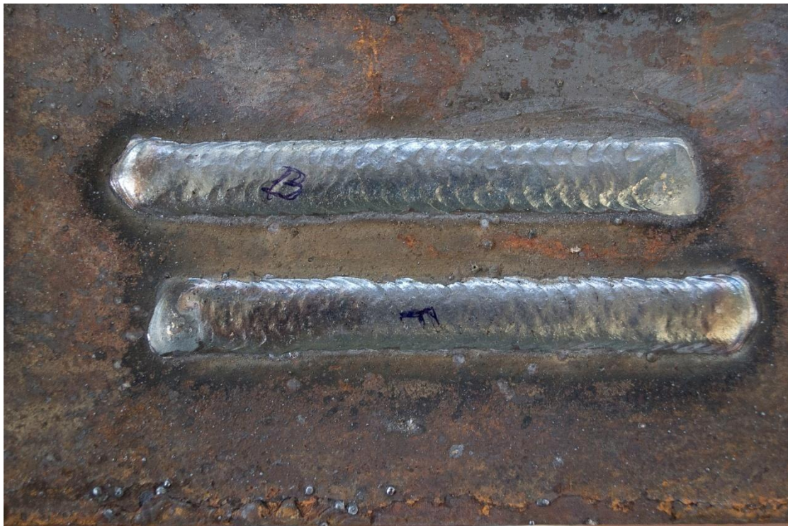
Εικόνα 4.29 Εναποθέσεις κυματοειδών κινήσεων με πρόσθια (F) και οπίσθια (B) τεχνική.
