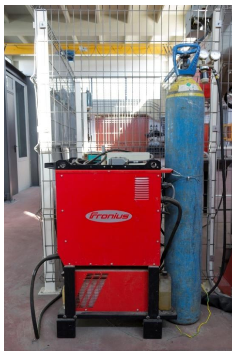
Εικόνες 3.2 , 3.3 Μηχανή συγκόλλησης σταθερής τάσης TPS330 του οίκου Fronius® και κύλινδρος, υψηλής πίεσης, παροχής αερίου προστασίας.
