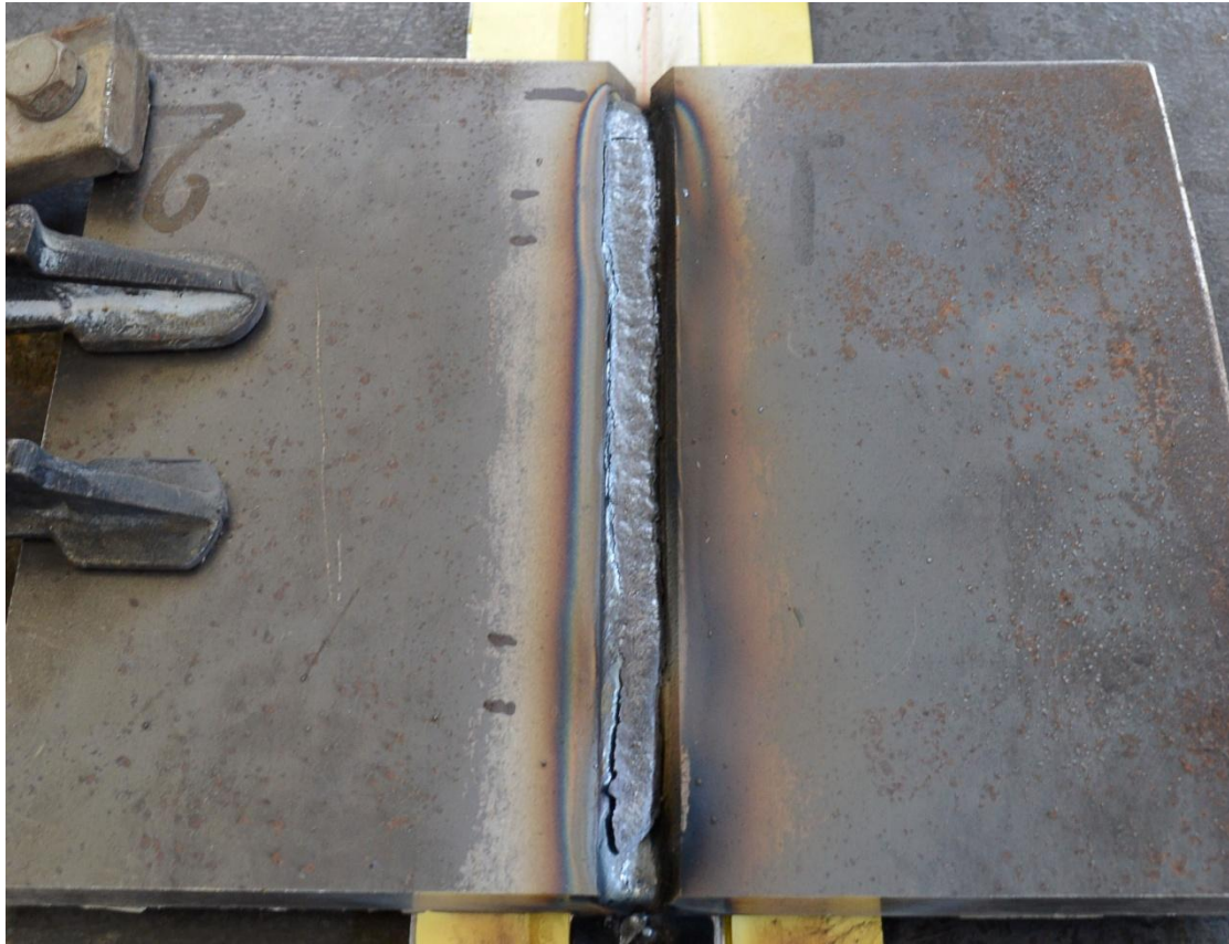
Εικόνα 4.48 Εκτέλεση 1 ου περάσματος επικάλυψης των δοκίμων της σειράς Β.
