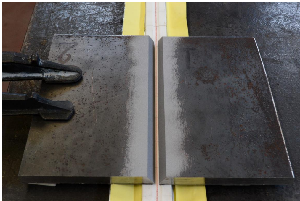
Εικόνα 4.44 Διάταξη των προς συγκόλληση δοκιμίων πριν την εκτέλεση πόντας.
