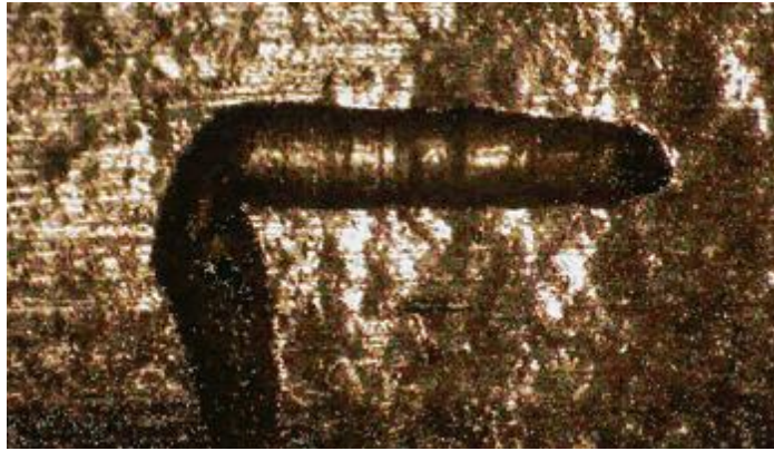
Εικόνα 14. Σφάλμα γραμμικής ένωσης πόρων, γνωστό και ως «worm tracks» [ESAB 2013]
