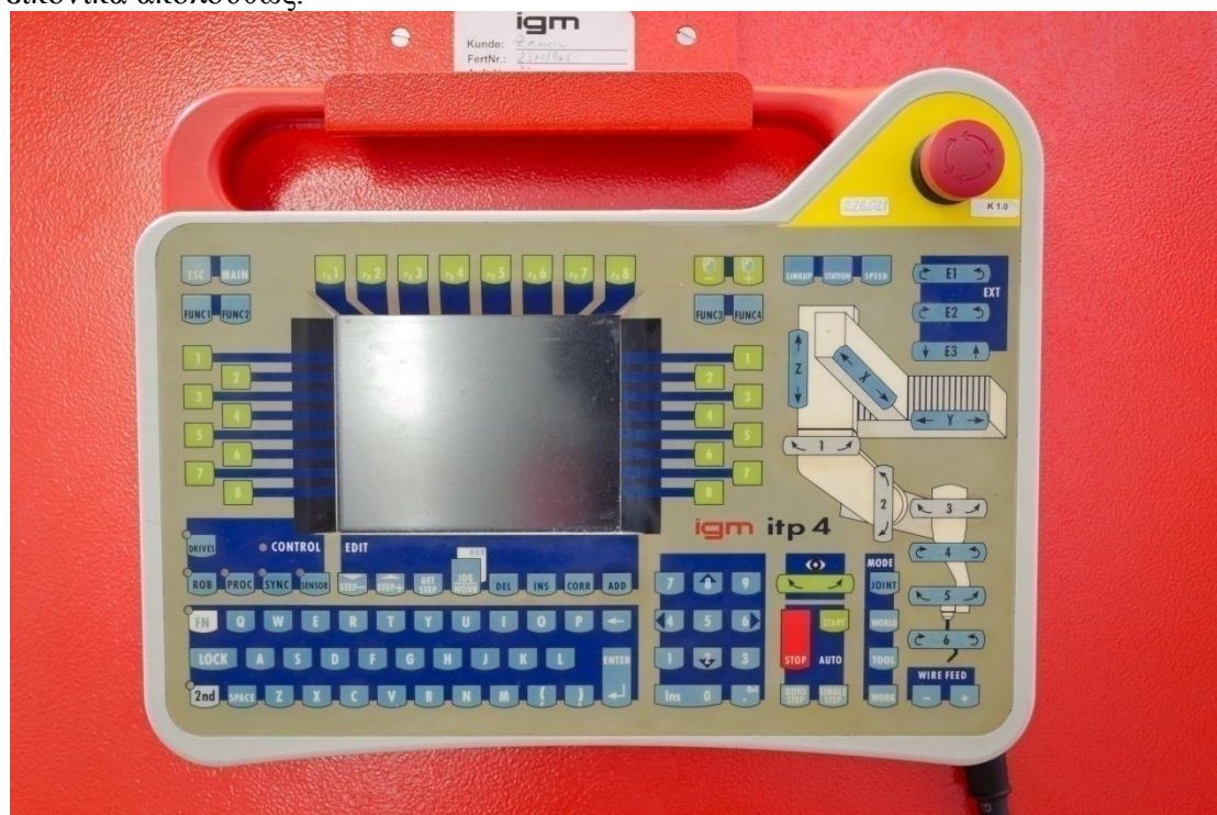
Εικόνα 3.7 Απεικόνιση του χειριστηρίου προγραμματισμού ITP4 του ρομποτικού βραχίονα του E.N.T.
