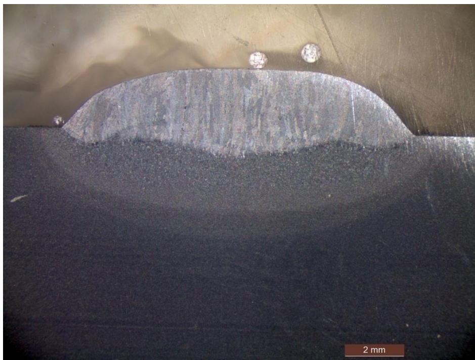
Εικόνα 4.32 Απεικόνιση ,μέσω στερεοσκοπίου, των ζωνών συγκόλλησης της εγκάρσιας τομής της απλής γραμμικής εναπόθεσης μετάλλου BoP.
