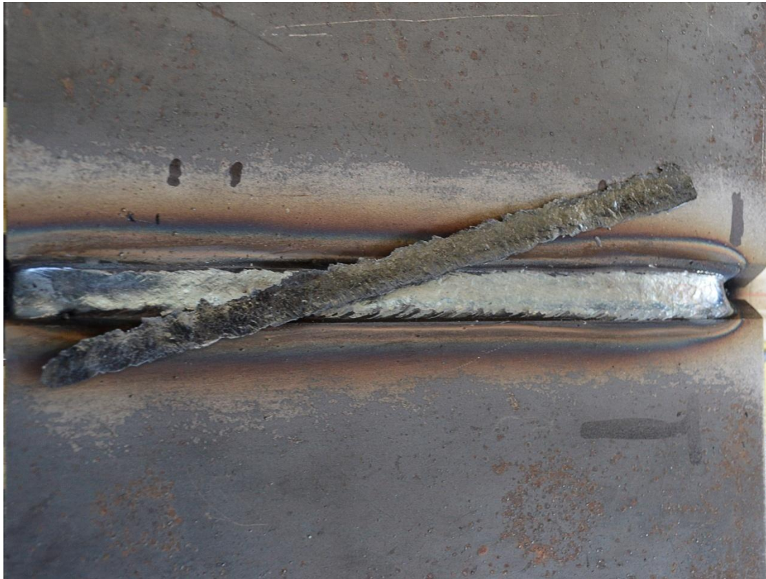
Εικόνα 4.51 Επιφάνεια ραφής έπειτα από την εκτέλεση του 2 ου περάσματος επικάλυψης.
