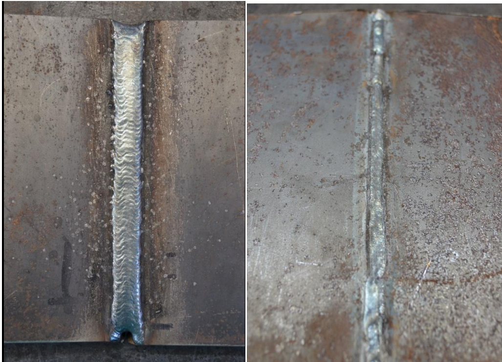
Εικόνα 4.63 Τελικό πέρασμα επικάλυψης και εναπόθεση ρίζας δοκιμίων σειράς Β(2).
