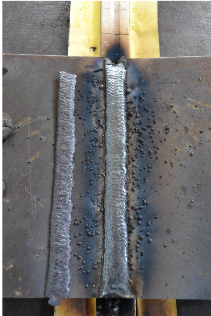
Εικόνα 4.57 Τελικό πέρασμα επικάλυψης της συγκόλλησης με παρουσία εκτοξεύσεων μετάλλου.
