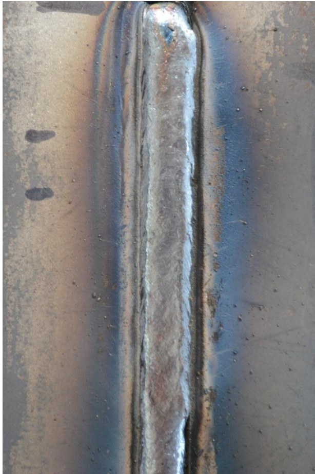
Εικόνα 4.55 Επιφάνεια ραφής μετά το πέρας του 4 ου περάσματος επικάλυψης.
