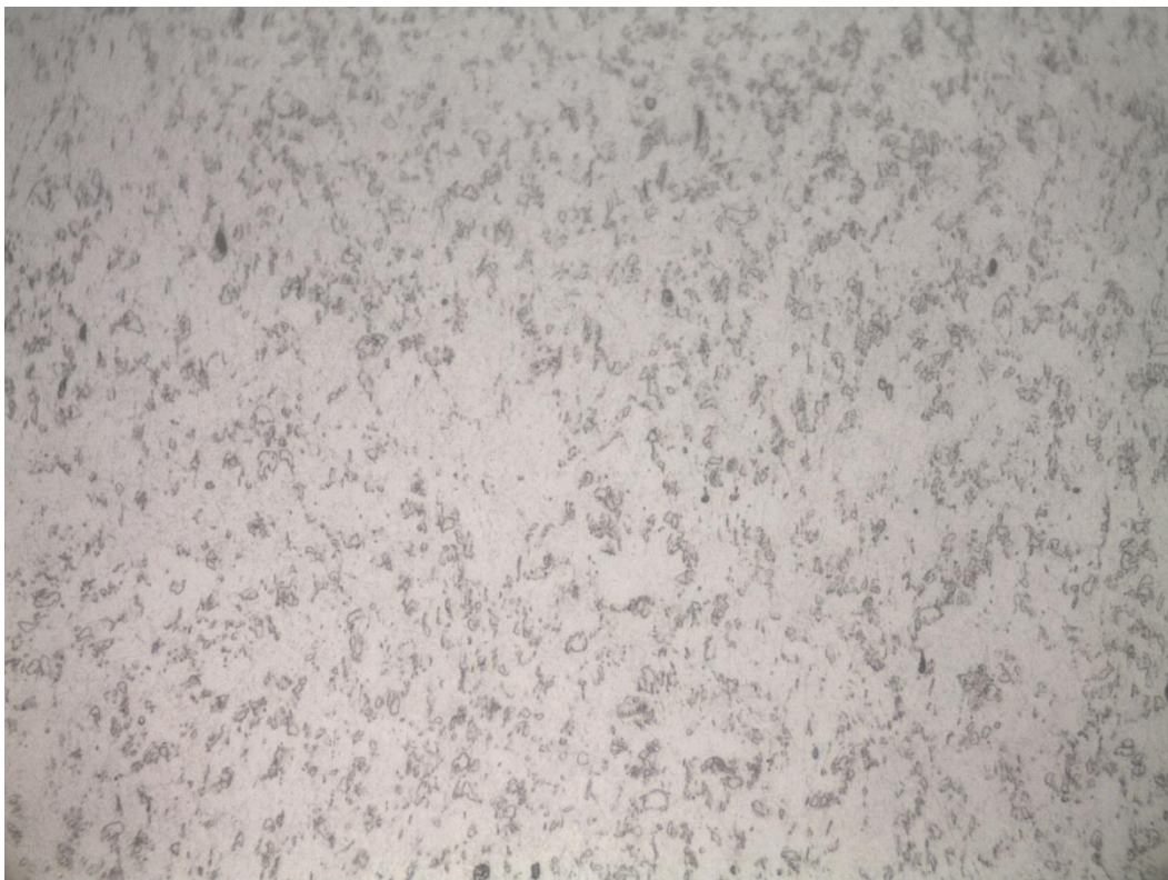
Εικόνα 4.68 Μικροδομή ΘΕΖ της συγκόλλησης δοκιμών της σειράς Β.
