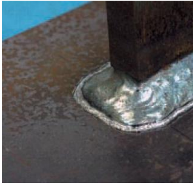
Εικόνα 2.12 Εφαρμογή μεθόδου UP σε αυχενική συγκόλληση. [Nippon Steel & Sumitomo Metal 2012]
