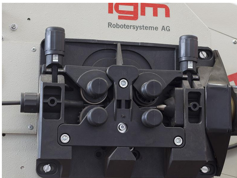
Εικόνα 2. Μηχανισμός ελέγχου παροχής ηλεκτροδίου του ρομποτικού βραχίονα του Ε.Ν.Τ.
