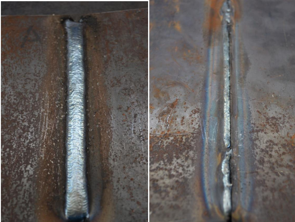
Εικόνα 4.61(α),(β) Τελικό πέρασμα επικάλυψης και εναπόθεση ρίζας συγκόλλησης δοκιμίων σειράς Α.
