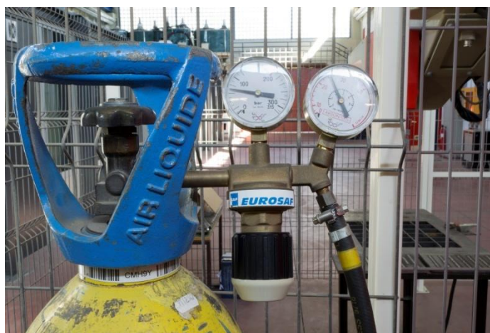
Εικόνα 22.4 Ρυθμιστικός μηχανισμός παροχής και πίεσης αερίου προστασίας.
