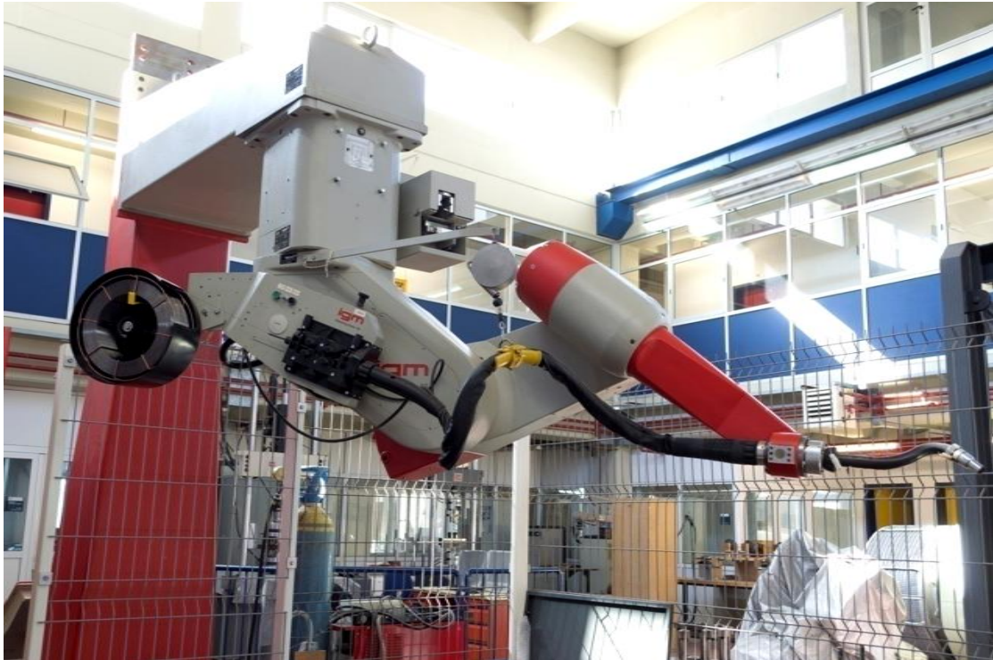
Εικόνα 21. Ρομποτικός βραχίονας της IGM Robotersysteme για συγκόλληση FCAW χαλύβδινων ελασμάτων.
