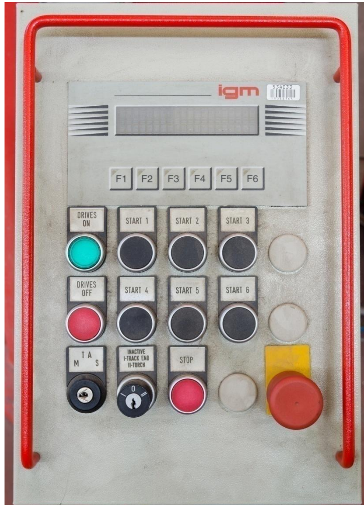
Εικόνα 3.9 Εξωτερική ελεγκτική μονάδα - External Start/Stop Cassette.
