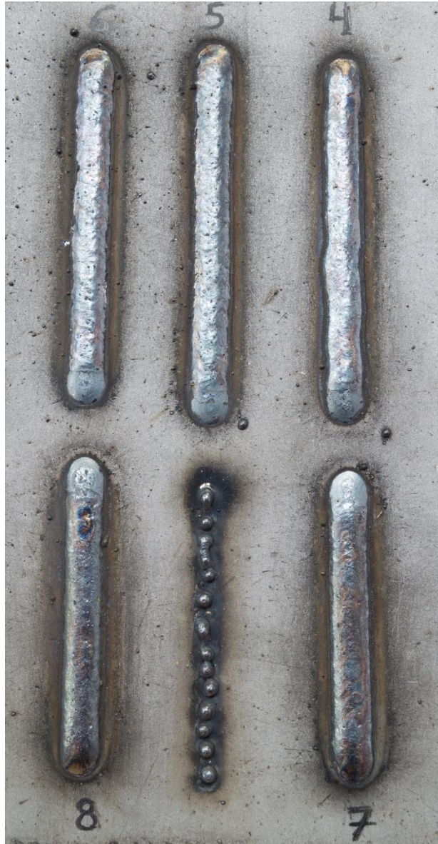
Εικόνα 4.26 Επίδραση forehand και backhand τεχνικής στην όψη της ραφής. Η παράθεση των ενδιαφερόμενων χαρακτηριστικών των ραφών 5,6,7,8 γίνεται στον πίνακα 4.7, υπό τις ονομασίες 5B,6B,7B,8B.
