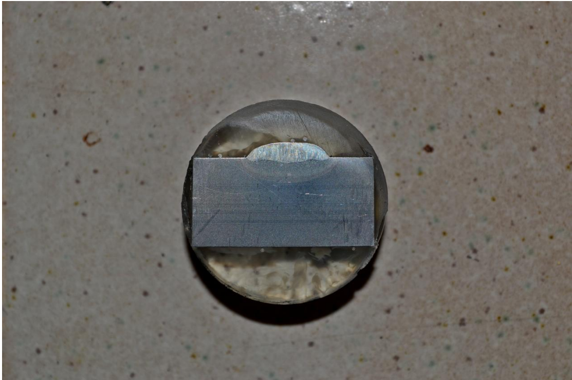
Εικόνα 4.30 Εγκιβωτισμένη εγκάρσια τομή γραμμικής εναπόθεσης μεμονωμένης στρώσης μετάλλου Linear Bead On Plate.
