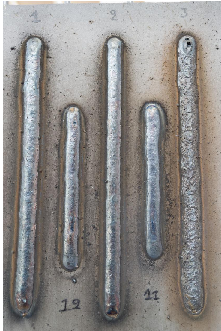
Εικόνα 4.25 Επίδραση επιλογών προστασίας σε ομαλότητα επιφανείας ραφής, σταθερότητα τόξου και ύπαρξη επιφανειακών σφαλμάτων. Οι ενδιαφερόμενες ραφές 1,2,3 παρατίθενται στον πίνακα 4.7 υπό τις ονομασίες 1B,2B,3B .
