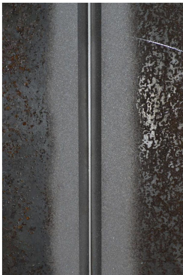
Εικόνα 4.42 Απεικόνιση αμμοβολημένης λοξοτομής δοκιμίων της σειράς Α.
