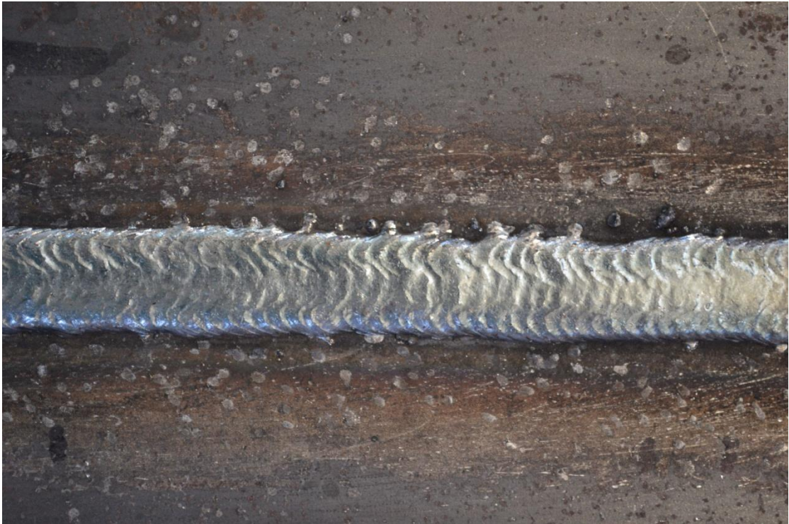
Εικόνα 4.58 Επιφάνεια τελικής ραφής συγκόλλησης δοκιμίων σειράς Β.
