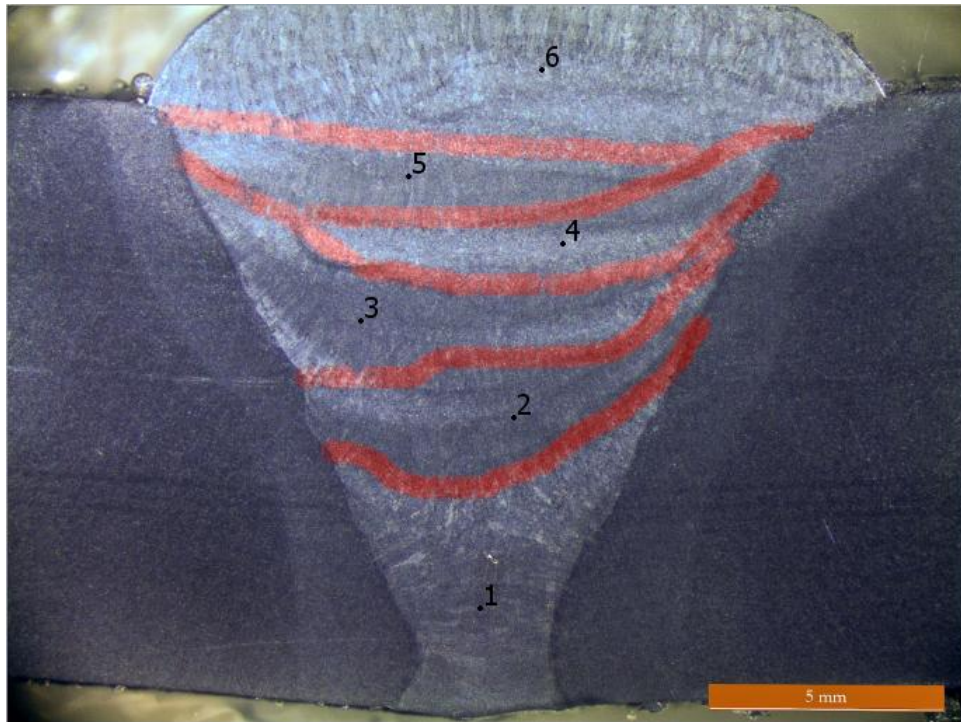
Εικόνα 4.64 Προφίλ συγκόλλησης δοκιμίων σειράς A και διακριτοποίηση περασμάτων ρίζας και επικάλυψης της ζώνης τήξης.
