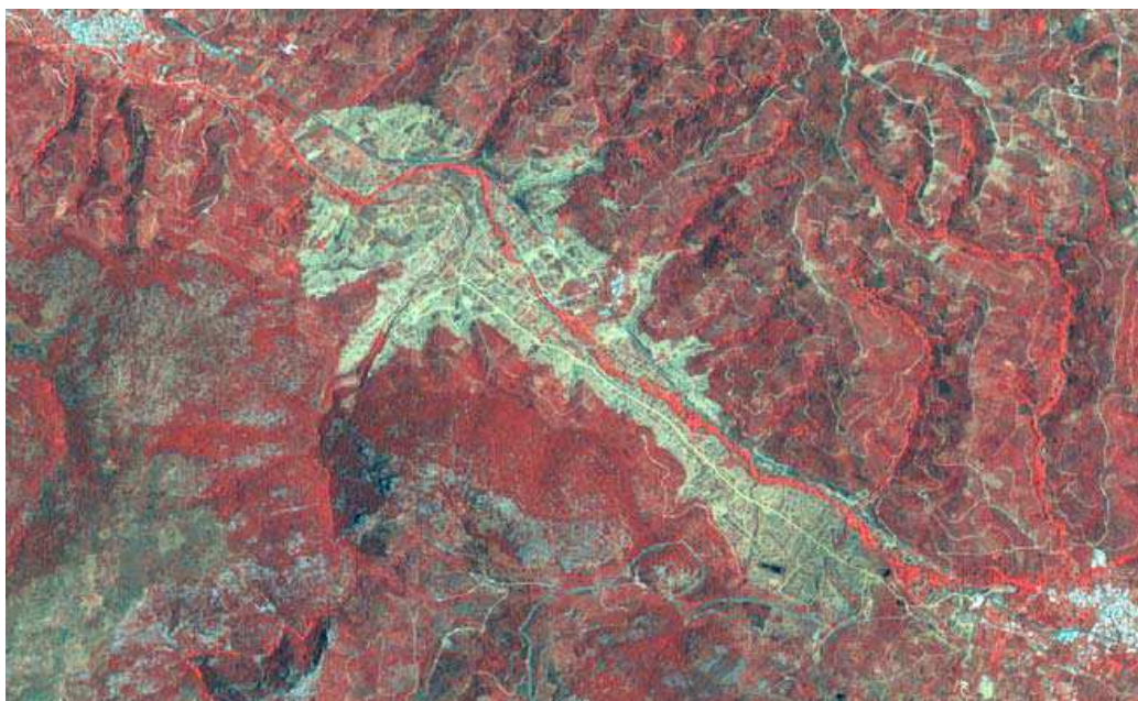
Εικόνα 25: Αποτύπωση από το δορυφόρο IKONOS της αποψίλωσης της βλάστησης στην περιοχή του φράγματος Αποσελέμη το 2006. Η εικόνα είναι πολυφασματική σε ορατό και εγγύς υπέρυθρο και η φωτοσυνθετικά ενεργή βλάστηση παρουσιάζεται με αποχρώσεις του κόκκινου.
