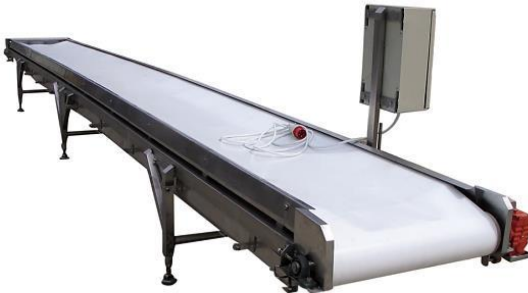
Εικόνα 5.8: Παράδειγμα μεταφορικής ταινίας για τη μεταφορά του ελαιοπυρηνόξυλου στο χωνευτήρα ( www.douglasmanufacturing.com )
