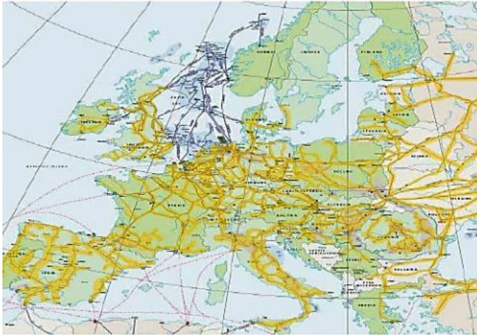
Εικόνα 4.13: Ο ευρωπαϊκός χάρτης του φυσικού αερίου και πιθανοί διάδρομοι (κίτρινα) κατάλληλοι για την παραγωγή βιοαερίου και την έγχυση βιομεθανίου (Rutz D. et al. 2008)
