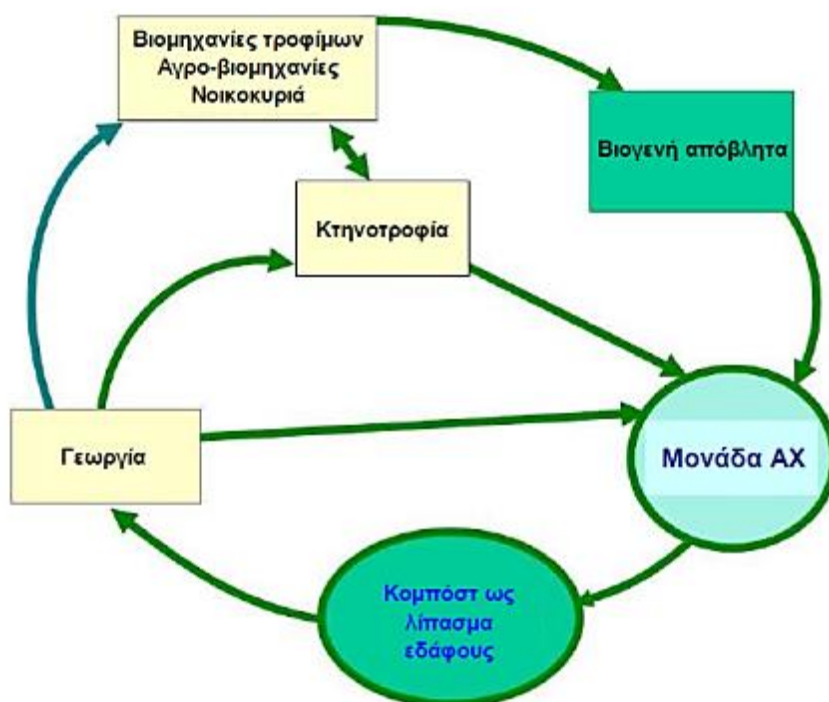
Εικόνα 4.1: Σχηματική αναπαράσταση του κλειστού κύκλου της συγκεντρωμένης αναερόβιας χώνευσης (Al Seadi et al., 2001)
