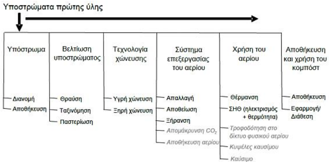
Εικόνα 4.6: Κύρια βήματα διεργασίας παραγωγής βιοαερίου (Σιούλας Κ. ΚΑΠΕ)
