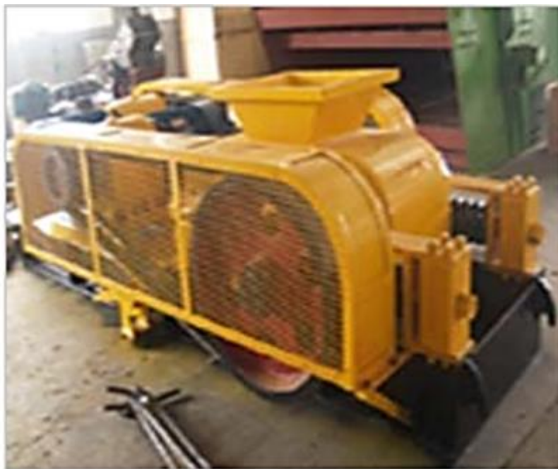
Εικόνα 5.6: Μηχανή θρυμματισμού του ελαιοπυρηνόξυλου ( http://www.woodcrusher-mill.com )
