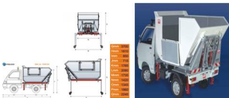
Εικόνα 21: Όχημα τύπου Spider SWC24 που χρησιμοποιείται για τη διαλογή αποβλήτων στις κοινότητες του Πύργου και του Όρμου Πανόρμου
