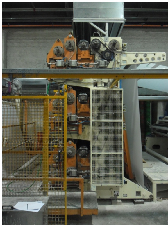
Εικόνα 8. Σημείο τύλιξης και αποκοπής
