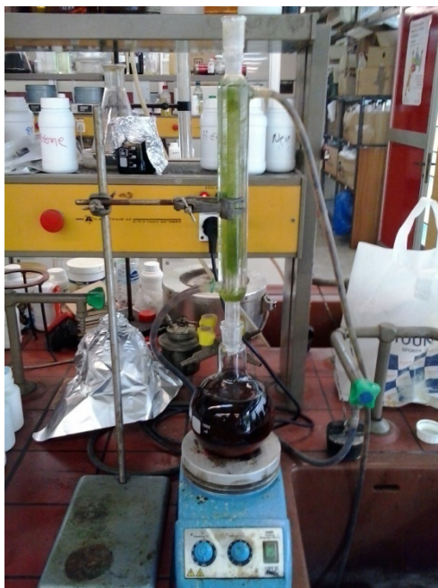
Εικόνα 4-1: Αντίδραση μετεστεροποίησης. Η σφαιρική φιάλη πάνω στη συσκευή θέρμανσης και ανάδευσης συνδεδεμένη με ψυκτήρα Liebig.
