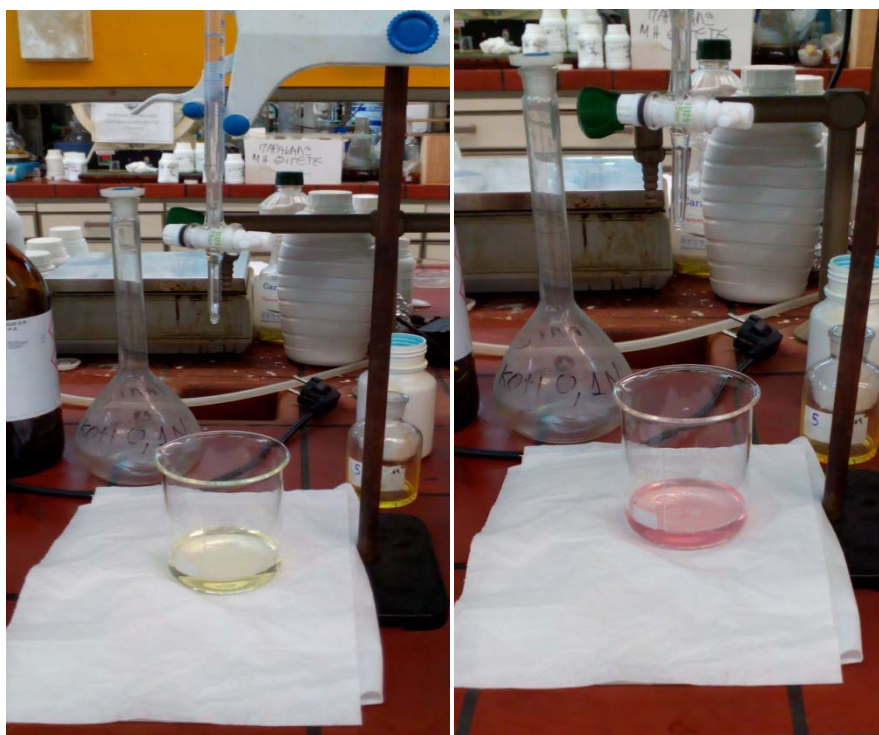
Εικόνα 4-4: Διάταξη τιτλοδότησης. Αριστερά το δείγμα πριν την έναρξη και δεξιά μετά την εξουδετέρωση.
