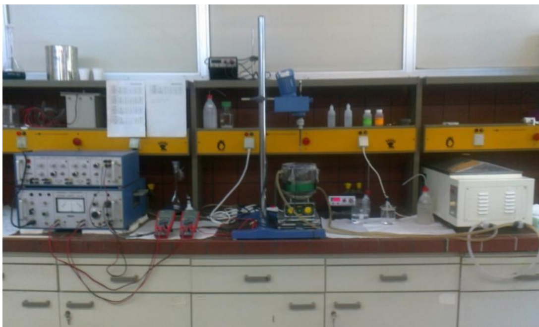
Εικόνα 6.1. Εργαστηριακή διάταξη για την παρασκευή των σύνθετων επικαλύψεων
