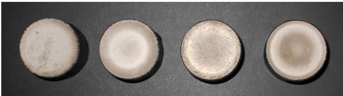
Εικόνα 8.1. Επικαλύψεις Ni/μίγματος φουλερενίων, οι οποίες παρασκευάστηκαν σε συνθήκες DC, με πυκνότητα ρεύματος j = 5\text{A/dm}^2 και ταχύτητα περιστροφής της καθόδου, από αριστερά προς τα δεξιά, \Omega = 300, 600, 900 και 1200 rpm, αντίστοιχα
