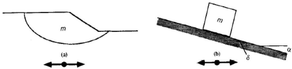
Σχήμα 2.14: Σχηματική απεικόνιση της απλοποιημένης μεθόδου Newmark.
