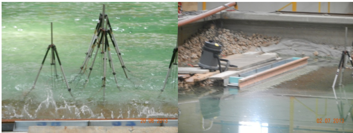
Φωτ.5.2- Απόψεις κατακορύφου μετώπου με τοίχο επιστροφής σε ψευδοδιδιάστατο φυσικό προσομοίωμα.
