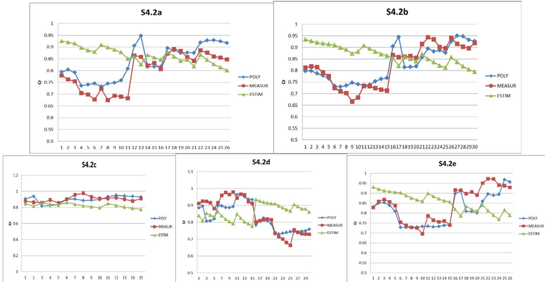
Διάγραμμα 10.19 Συγκριτικά αποτελέσματα μετρηθέντων και υπολογισθέντων τιμών συντελεστή ανάκλασης της Σειράς Σ4.2 βάση των προτεινόμενων πολυωνυμικών εξισώσεων της Σειράς 4 και βάση της εκθετικής ενιαίας προτεινόμενης εξίσωσης της Σειράς 3
