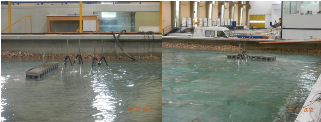
Φωτ.5.1- Απόψεις κατακόρυφου μετώπου με θάλαμο εκτόνωσης ( Ψευδοδισδιάστατο φυσικό προσομοίωμα)
