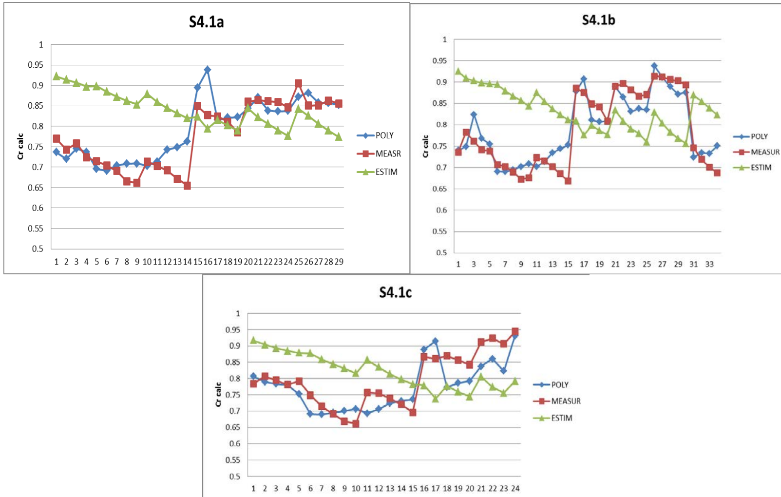
Διάγραμμα 10.18 Συγκριτικά αποτελέσματα μετρηθέντων και υπολογισθέντων τιμών συντελεστή ανάκλασης της Σειράς Σ4.1 βάση των προτεινόμενων πολυωνυμικών εξισώσεων της Σειράς 4 και βάση της εκθετικής ενιαίας προτεινόμενης εξίσωσης της Σειράς 3
