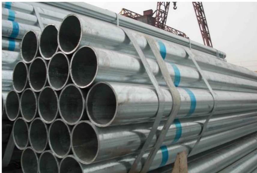
Εικόνα 2.4 Χαλυβωσολήνες νερού και φυσικού αερίου
