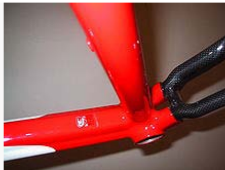
Σχήμα 2-11 Downtube από αλουμίνιο με εσοχές στις απολήξεις. Συνδέεται με διπλό chain stay από ανθρακονήματα. Τα τμήματα από αλουμίνιο συγκολλήθηκαν κατά TIG, ενώ τα τμήματα από ανθρακονήματα συνδέονται πάνω στα τμήματα του αλουμινίου.
