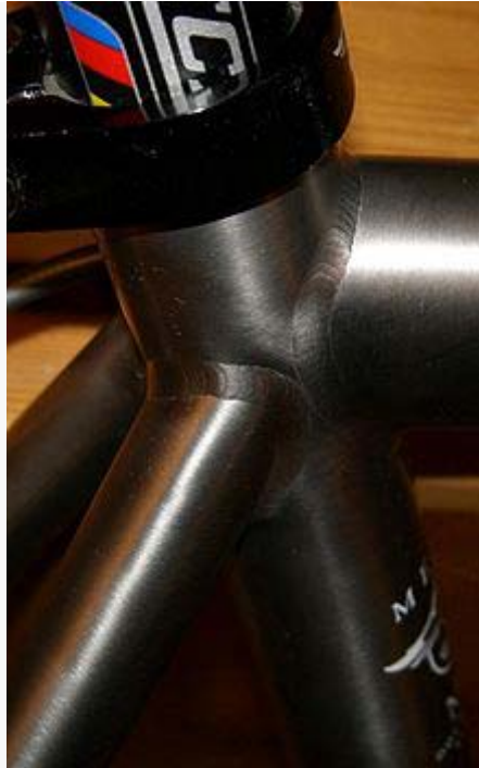
Σχήμα 2-11 Χαρακτηριστικές συγκολλήσεις σε ένα σκελετό από τιτάνιο.
