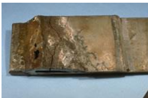
Σχήμα 1.26: Διάβρωση λόγω μηχανικής καταπόνησης σε υψηλά κραματοποιημένο χάλυβα συγκόλλησης 54
