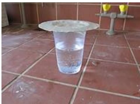
Σχήμα 7.2: Σύστημα υποστρώματος βαφής για την μέτρηση της υδρατμοπερατότητας
