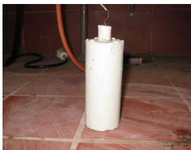
Σχήμα 10.28: Δοκίμιο οπλισμένου τσιμεντοκονιάματος
