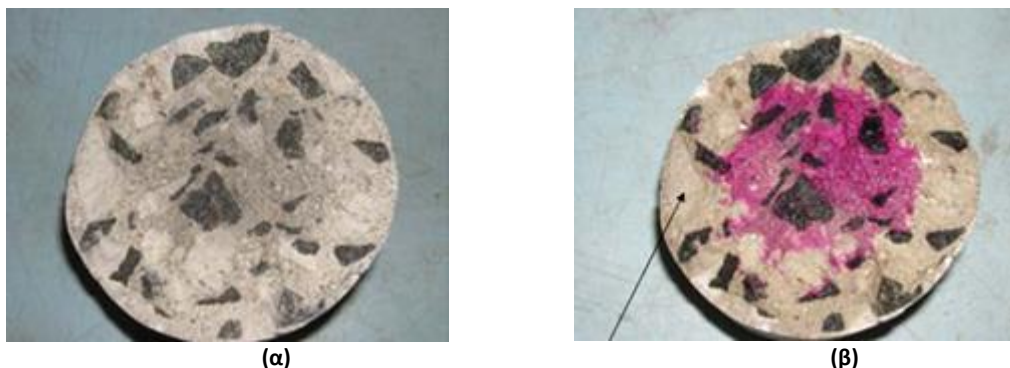
Σχήμα 2.8: (α) Δοκίμιο εκτεθειμένο σε ατμόσφαιρα πλούσια σε CO 2 , (β) Εφαρμογή φαινολοφθαλείνης. Οι μη ενανθρακωμένες περιοχές χρωματίζονται 85
