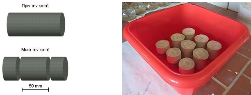
Σχήμα 7.1: Δοκίμια άσπλου τσιμεντοκονιάματος για την μέτρηση της υδατοπερατότητας
