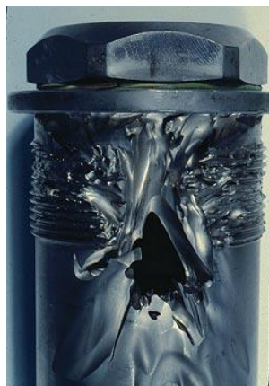
Σχήμα 1.21: Ρευστομηχανική διάβρωση εξαιτίας γρήγορης κίνησης υγρού σε βαλβίδα λαδιού 45
