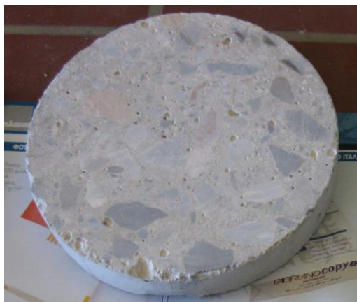
Σχήμα 9.14: Δοκίμια σκυροδέματος τα οποία χρησιμοποιήθηκαν για την μέτρηση pull-off
