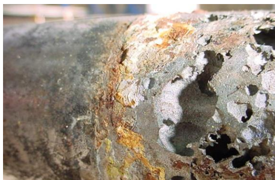
Σχήμα 1.33: Κομμάτι ατράκτου πλοίου που υπόκειται σε διάβρωση από ρεύματα διαφυγής. Η ομαλή κοίλανση της επιφάνειας και οι μικροσκοπικοί πόροι είναι χαρακτηριστικοί στην διάβρωση από ρεύματα διαφυγής του ανοξειδωτού χάλυβα 65
