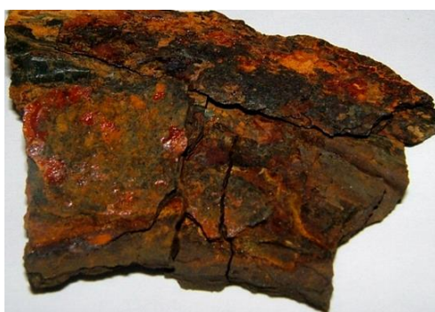
Σχήμα 1.24: Μικρό τμήμα μηχανικού εξαρτήματος αυτοκινήτου που έχει υποστεί περικρυσταλλική διάβρωση 49
