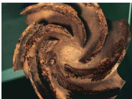
Σχήμα 1.22: Σπηλαιώδης διάβρωση σε μεταλλική φυγοκεντρική αντλία 46
