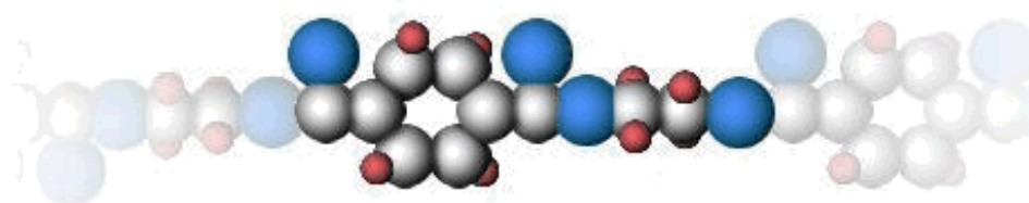
Σχήμα 4.9: Ομάδα πολυεστέρα σε πολυμερική αλυσίδα 225
