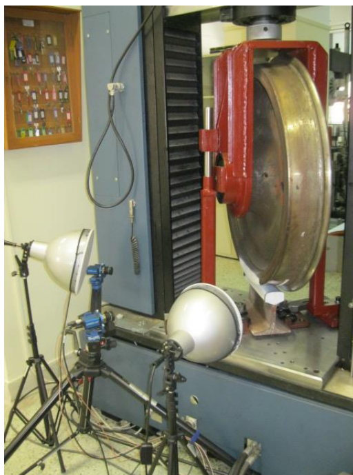
Εικόνα 8.78: Βαθμονομημένο σύστημα καμερών-προβολέων
