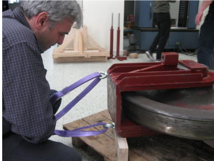
Εικόνα 8.55: Τοποθέτηση μάντα ανύψωσης στον φορέα φόρτισης
