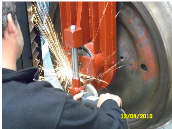
Εικόνα 8.66: Επί τόπου διορθωτική επέμβαση στον φορέα στήριξης
