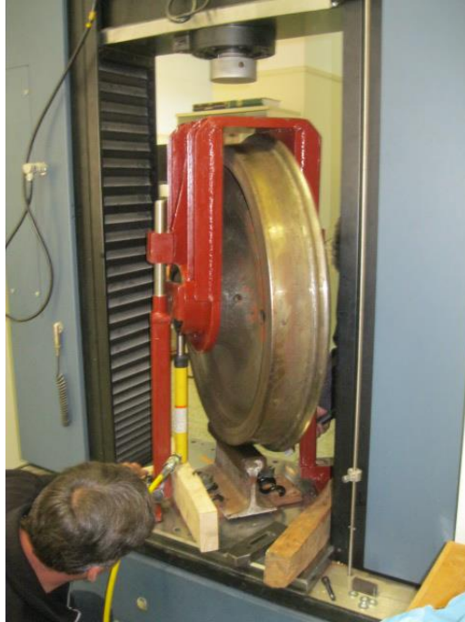
Εικόνα 8.65: Ανύψωση φορέα φόρτισης για τοποθέτηση σιδηροτροχιάς
