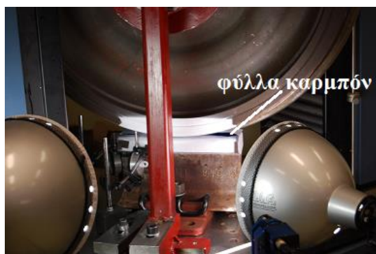
Εικόνα 8.93: Φύλλα καρμπόν μεταξύ των δοκιμίων για λήψη αποτυώματος
