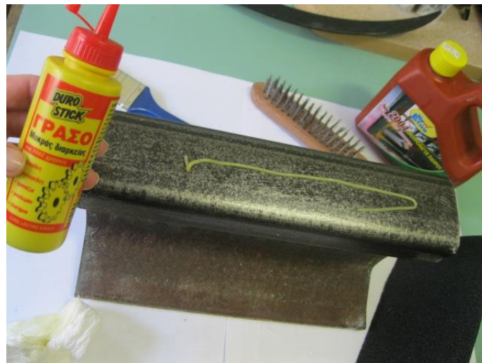
Εικόνα 8.36: Επάλειψη επιφάνειας κύλισης με γράσο
