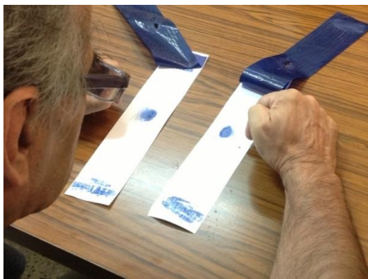
Εικόνα 8.94: Αποτύπωμα μεταξύ των δοκιμίων σε φύλλο καρμπόν
