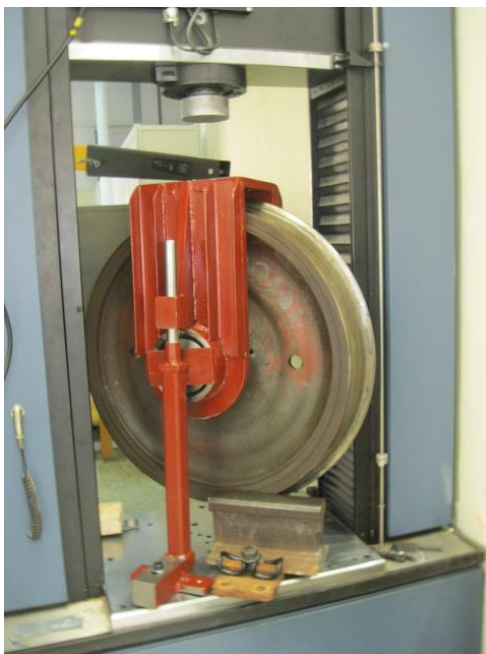
Εικόνα 8.63: Τοποθέτηση σιδηροτροχιάς-πλάκας έδρασης
