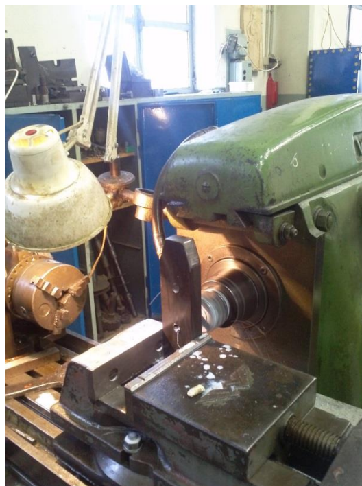
Εικόνα 8.24: Κατασκευή σφικτήρα πλάκας έδρασης σιδηροτροχιάς
