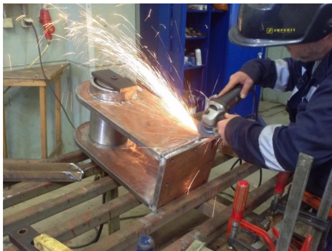
Εικόνα 8.10: Τρόχισμα συγκολλήσεων επάνω πλάκας φορέα φόρτισης
