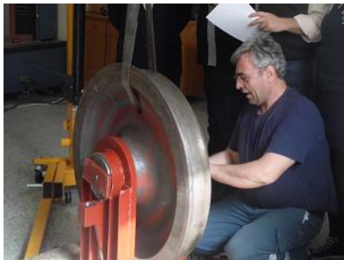
Εικόνα 8.52: Τοποθέτηση σφικτήρων τροχοφόρου άξονα
