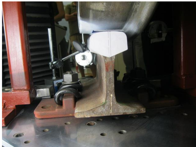
Εικόνα 8.71: Αποτύπωση κεφαλής σιδηροτροχιάς και χαρακτηριστικών σημείων
