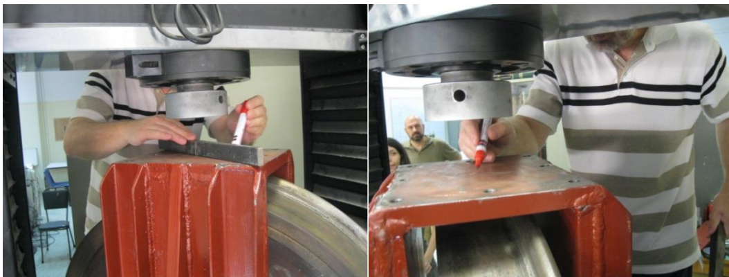
Εικόνα 8.90: Εύρεση κέντρου επάνω πλάκας φορέα φόρτισης Στο επάνω μέρος της σφαιρικής άρθρωσης τοποθετήθηκε επίπεδη πλάκα, κυκλικής διατομής και διαμέτρου ίδιας με αυτή του εμβόλου, για προστασία του δυναμοκελιού του εμβόλου φόρτισης από την άμεση επαφή του με τη σφαιρική άρθρωση (Εικ. 8.91 και 8.92).
