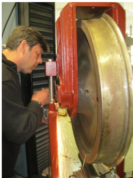
Εικόνα 8.67: Επί τόπου διορθωτική επέμβαση στον φορέα στήριξης
