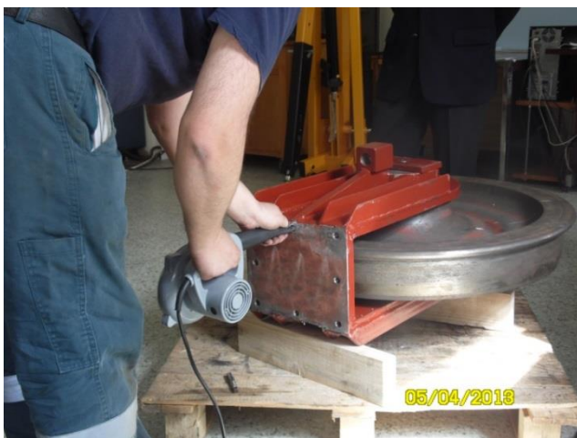
Εικόνα 8.54: Καθαρισμός οπών επάνω πλάκας φορέα φόρτισης με αέρα
