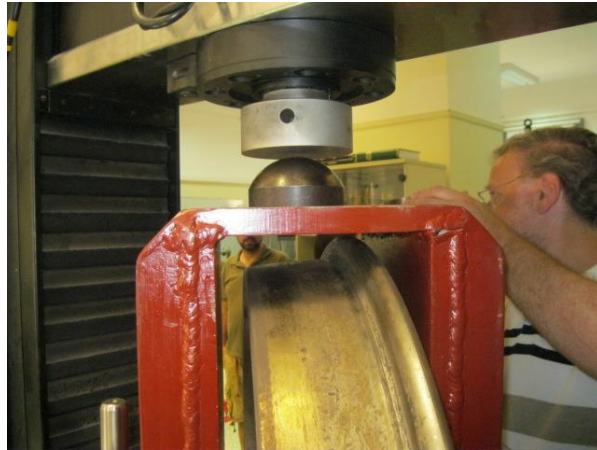
Εικόνα 8.89: Σφαιρική άρθρωση μεταξύ εμβόλου φόρτισης και φορέα φόρτισης Η σφαιρική άρθρωση τοποθετήθηκε στο κέντρο της επάνω πλάκας του φορέα φόρτισης ώστε να αποφευχθεί η μεταφορά ροπών λόγω εκκεντρότητας (Εικ. 8.90).
