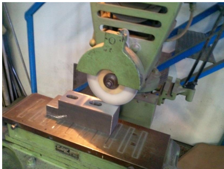
Εικόνα 8.19: Κατασκευή βάσης φορέα στήριξης
