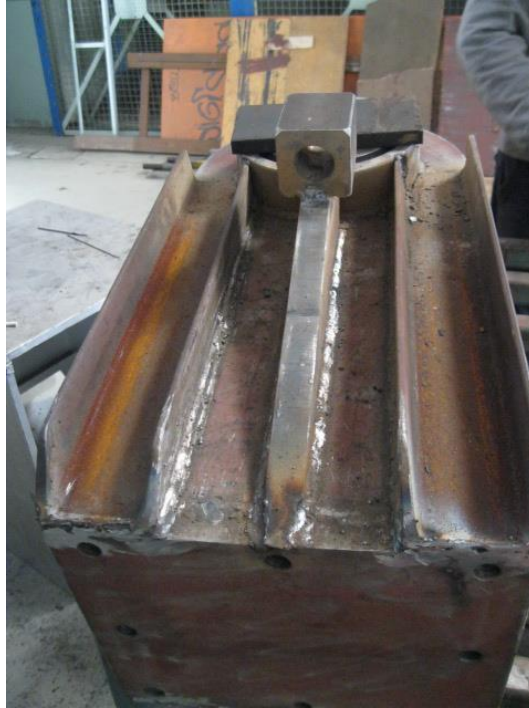
Εικόνα 8.13: Φορέας φόρτισης με ενισχυτικά και έδρανο
