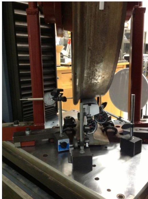
Εικόνα 8.87: Λεπτομέρεια τοποθέτησης βελομέτρων
