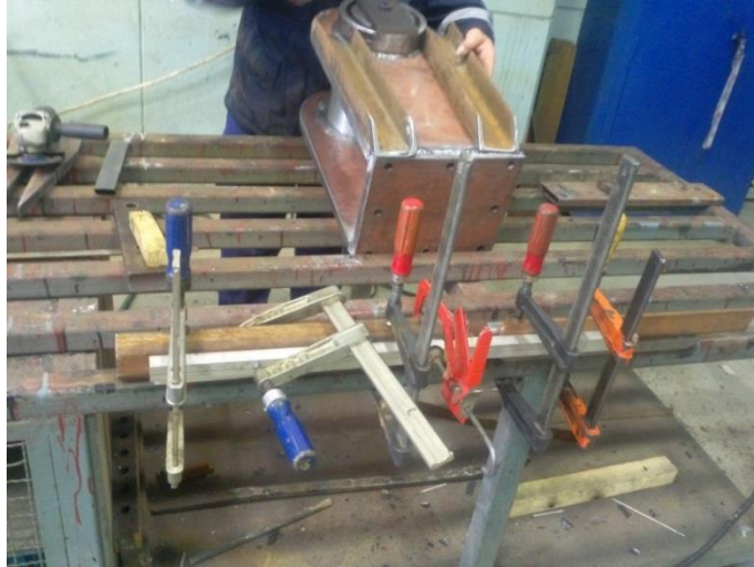
Εικόνα 8.14: Πλαϊνή πλάκα φόρτισης με αριστερό και δεξιό ενισχυτικό. Ο φορέας φόρτισης σε κάτοψη, πλάγια όψη και τομή δίδεται στο ακόλουθο σχήμα (Σχ. 8.16).
