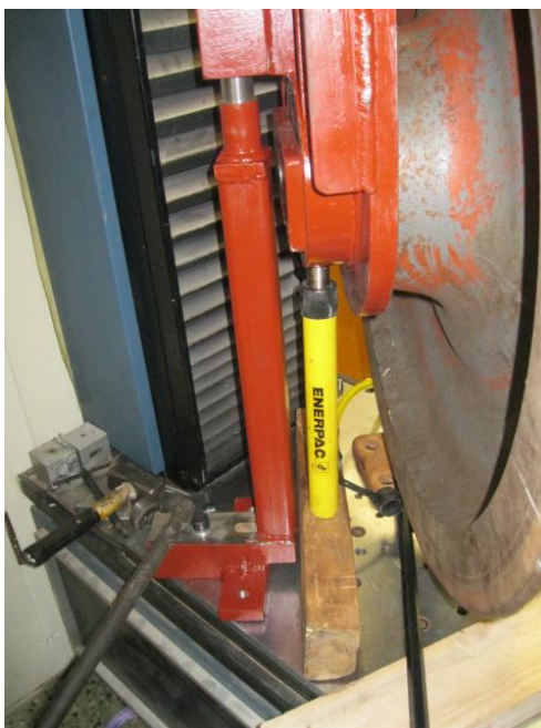
Εικόνα 8.64: Τοποθέτηση γρύλου κάτω από το τεμάχιο υποδοχής του τροχοφόρου άξονα του φορέα φόρτισης
