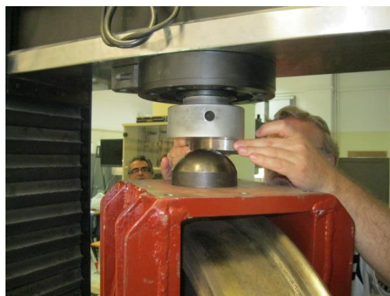
Εικόνα 8.91: Τοποθέτηση πλάκας μεταξύ εμβόλου φόρτισης και σφαιρικής άρθρωσης
