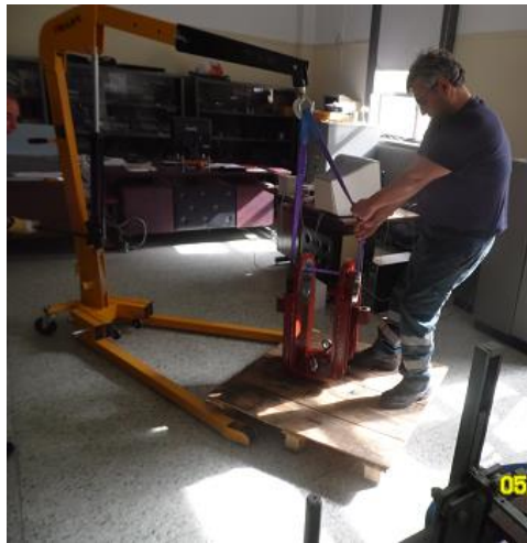
Εικόνα 8.48: Διαχείριση φορέα φόρτισης στον χώρο διεξαγωγής του πειράματος Συναρμολόγηση των τεμαχίων της πειραματικής διάταξης
