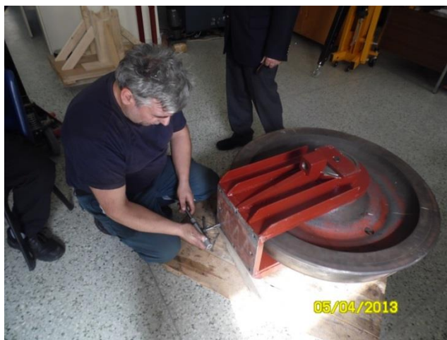
Εικόνα 8.53: Καθαρισμός οπών επάνω πλάκας φορέα φόρτισης με σπειροτόμο
