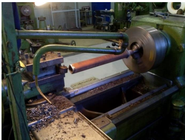
Εικόνα 8.18: Κατασκευή προέκτασης φορέα στήριξης
