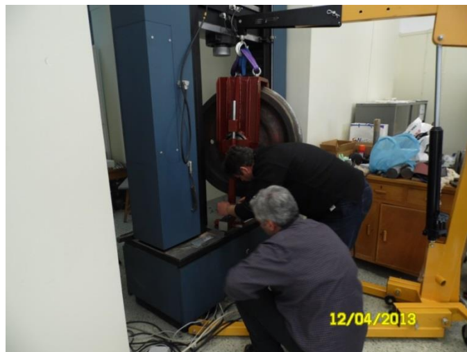
Εικόνα 8.59: Στερέωση πρώτου ορθοστάτη στην πλάκα στερέωση δοκιμίων
