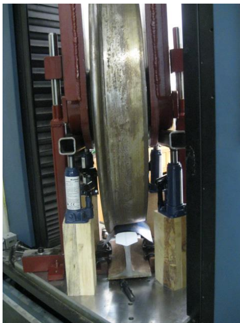
Εικόνα 8.70: Θέση γρύλων ανύψωσης και κοιλοδοκών
