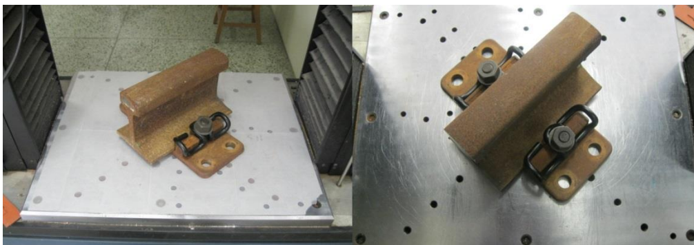
Εικόνα 8.4: Σιδηροτροχιά διατομής UIC60 και πλάκα έδρασης κλίσης 1:40
