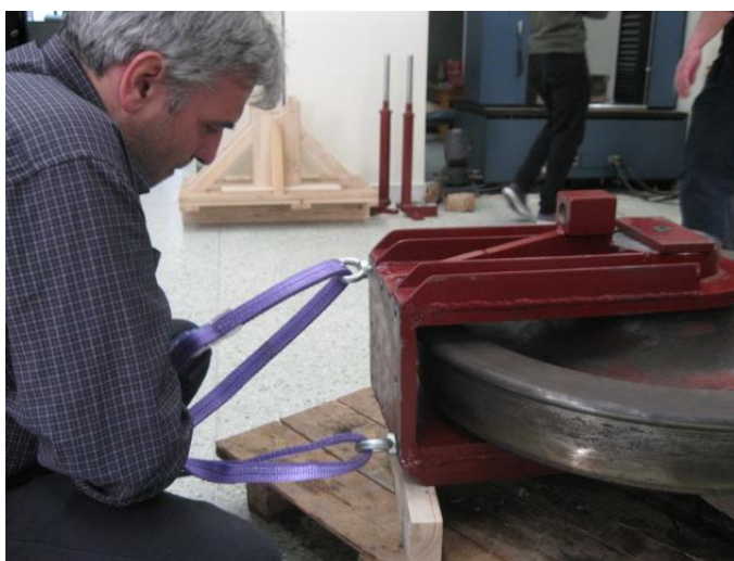
Εικόνα 8.31α: Προετοιμασία ανύψωσης τροχού-άξονα-φορέα φόρτισης
