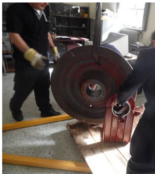
Εικόνα 8.49: Τοποθέτηση τροχού εντός του φορέα φόρτισης
