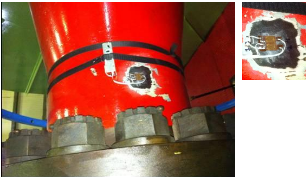
Εικόνα 5-17 Ο άξονας του κινητήρα στον οποίο εγκαταστάθηκε η διάταξη μέτρησης της ροπής. Επίσης διακρίνονται η μονάδα μέτρησης και μετάδοσης, στερεωμένη με υφασμάτινη ταινία και μέρος της στεφάνης (γαλάζιο) της μονάδας λήψης μετρήσεων. Στην λεπτομέρεια δεξιά διακρίνεται η διάταξη των μηκυνσιόμετρων.
