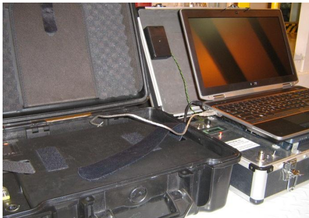
Εικόνα 4-18 Δυο συστήματα λήψης μετρήσεων τα οποία είναι συνδεδεμένα στον ίδιο υπολογιστή, με σκοπό την ταυτόχρονη λήψη μετρήσεων από τα δυο διαφορετικά συστήματα, ταυτόχρονα.
