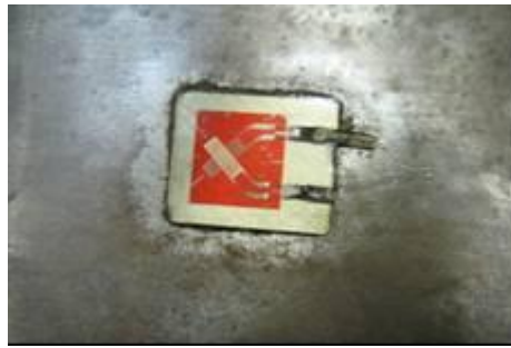
Εικόνα 5-2 Μηκυσιόμετρο για τη μέτρηση της ροπής στη διάρκεια των δοκιμών θαλάσσης.
