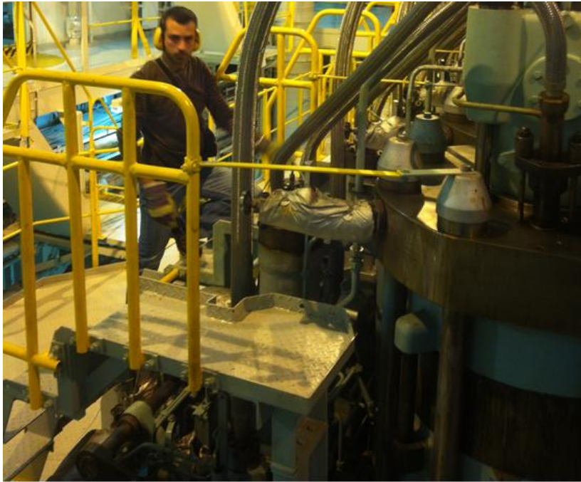
Εικόνα 6-9 Στιγμιότυπο από την μέτρηση της πίεσης κυλίνδρου στον κινητήρα "Γ"
