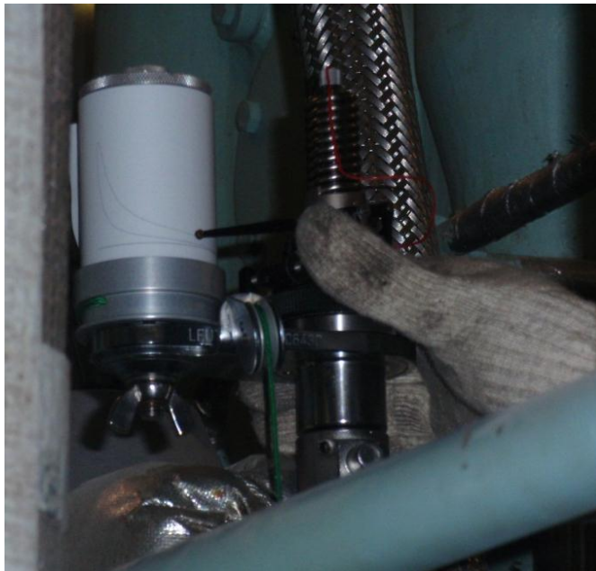
Εικόνα 2-2 Μηχανικός δυναμοδείκτης προσαρμοσμένος στον κρουνό. Διακρίνεται το ίχνος του διαγράμματος πίεσης-όγκου
