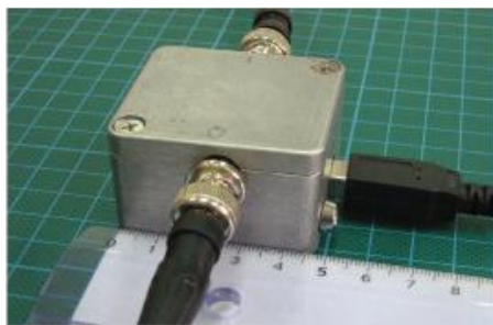
Εικόνα 2-5 Φωτογραφικές απόψεις ολοκληρωμένης διάταξης- κύκλωμα διασύνδεσης και τροφοδοσία, με χρήση των τυπωμένων που φαίνονται στο Σχήμ. 2-6 (c) και (d)
