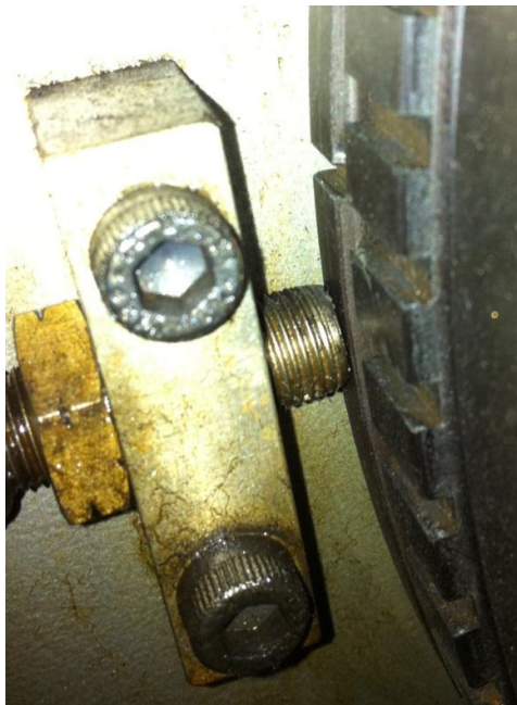
Εικόνα 3-1 (α) Επαγωγικός λήπτης εγκατεστημένος στον κινητήρα Ricardo Hydra του Εργαστηρίου ΜΕΚ. (β) Επαγωγικός λήπτης εγκατεστημένος σε μεγάλο κινητήρα ηλεκτροπαραγωγής
