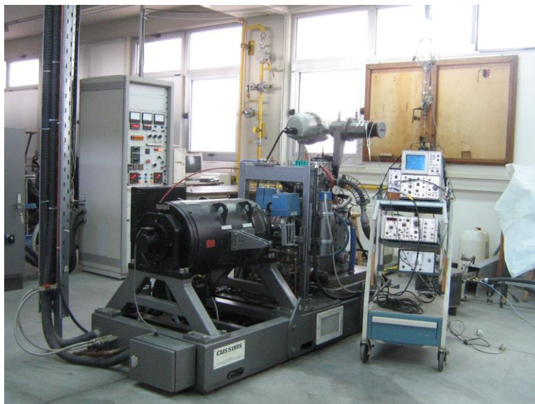
Εικόνα 6-3 Φωτογραφική άποψη της εγκατάστασης του πειραματικού κινητήρα Ricardo Hydra
