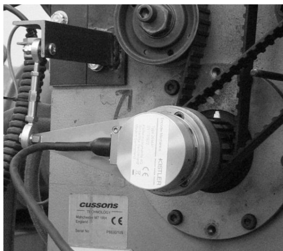
Εικόνα 6-2 Ο κωδικοποιητής γωνίας στροφάλου Kistler Type 2613B εγκατεστημένος στον κινητήρα Ricardo Hydra του Εργαστηρίου MEK
