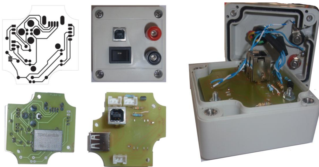
Εικόνα 2-4 Κατασκευή που αναπτύχθηκε και κατασκευάστηκε για την τροφοδοσία του αισθητήρα από θύρα USB υπολογιστή.
