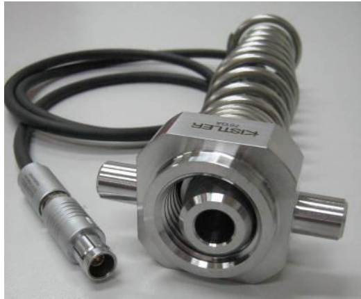
Εικόνα 2-3. Αισθητήρας Kistler type 6613CP, προσαρμοσμένος σε προσαρμογέα τύπου Tompson
