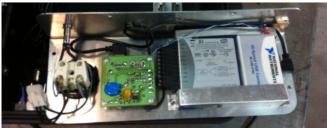
Εικόνα 2-11 Η μονάδα λήψης μετρήσεων που αναπτύχθηκε και κατασκευάστηκε.
