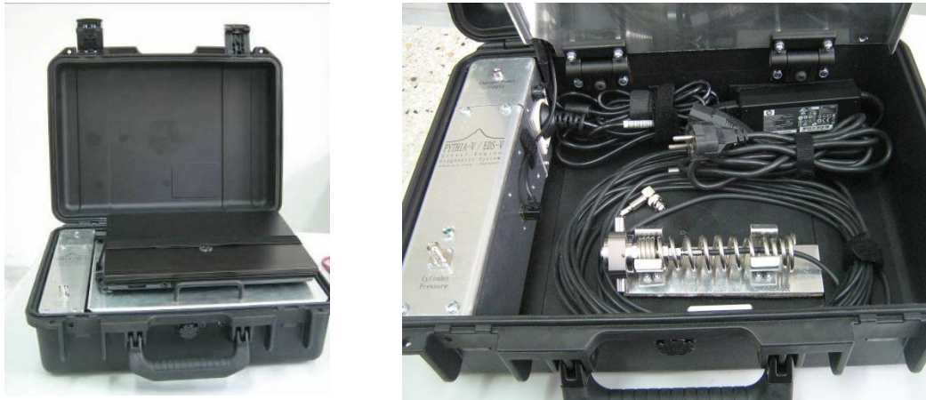
Εικόνα 2-10 Το ολοκληρωμένο σύστημα λήψης μετρήσεων που αποτελείται από την μονάδα λήψης μετρήσεων, τον υπολογιστή, τον αισθητήρα και τα καλώδια (σε αντίστοιχο αποθηκευτικό χώρο)
