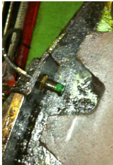
Εικόνα 3-1 (α) Επαγωγικός λήπτης εγκατεστημένος στον κινητήρα Ricardo Hydra του Εργαστηρίου ΜΕΚ. (β) Επαγωγικός λήπτης εγκατεστημένος σε μεγάλο κινητήρα ηλεκτροπαραγωγής
