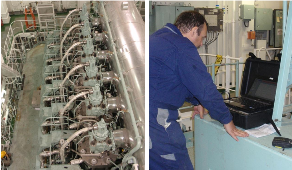
Εικόνα 6-7 Φωτογραφική άποψη του κινητήρα "B" και στιγμιότυπο από την λήψη μετρήσεων πίεσης κυλίνδρου από τεχνικό του πλοίου
