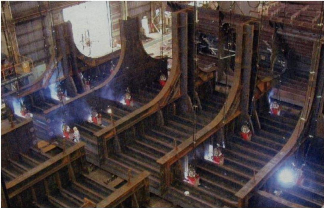
Σχήμα 3.4: Ρομποτικές συγκολλήσεις κατά την συναρμολόγηση κύριου block
