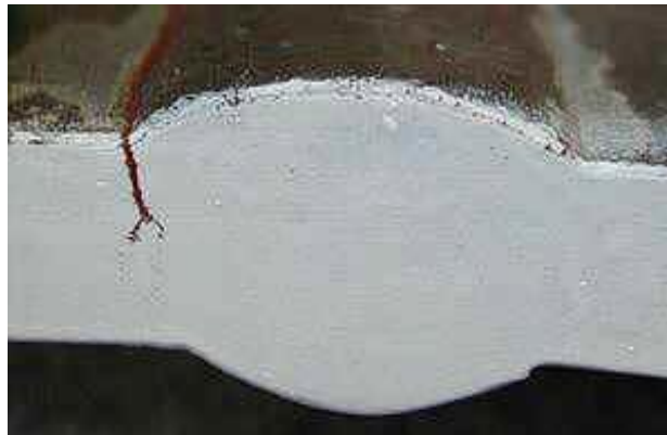
Σχήμα 1.1: Ρωγμάτωση στην ζώνη τήξης
