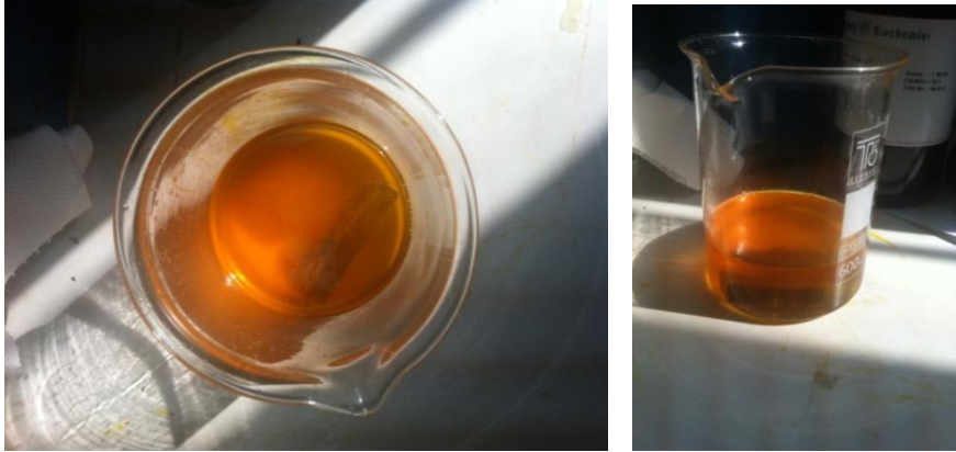
Εικόνα 6.34: Χημική προσβολή δοκιμίου σε αντιδραστήριο Glyceresia
