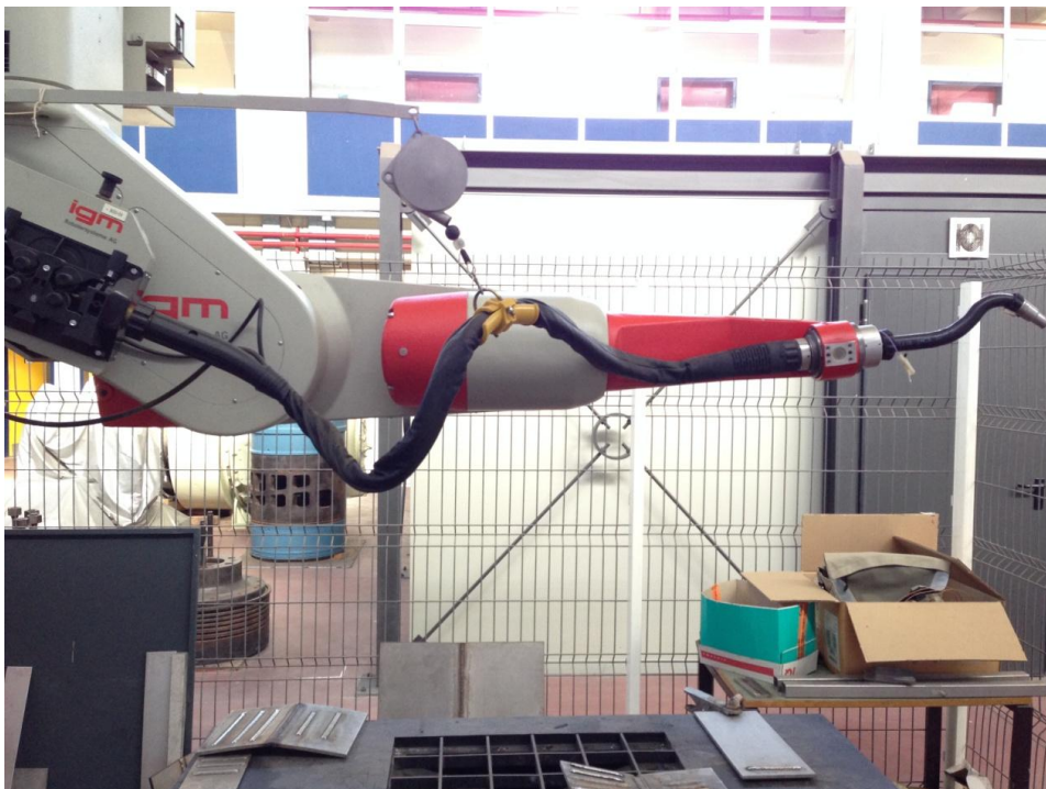
Σχήμα 5.10: Ο ρομποτικός βραχίονας μετά από καλιμπράρισμα όλων των αξόνων
