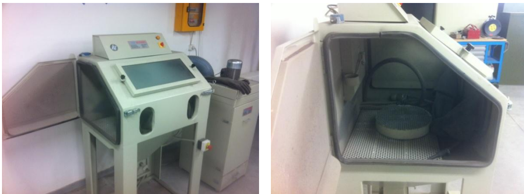
Εικόνες 6.9: Θάλαμος αμμοβολής SANDBLASTER MS100®.
