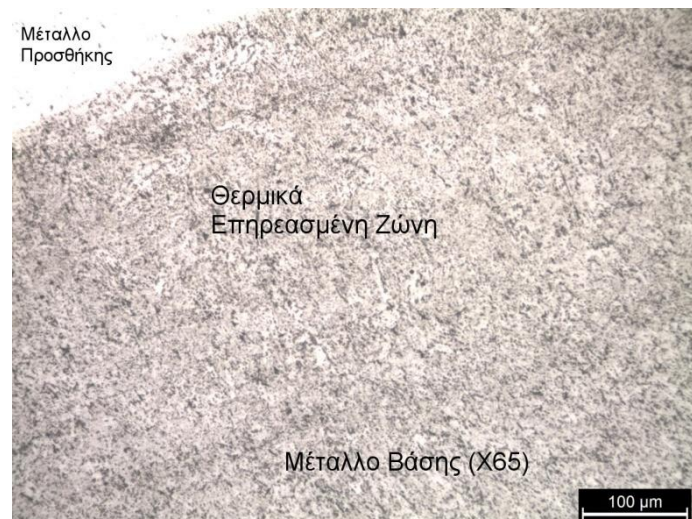
Εικόνα 7.5(β): Οι 3 περιοχές της αναγόμωσης του δοκιμίου Νο.6 σε μεγέθυνση x20
