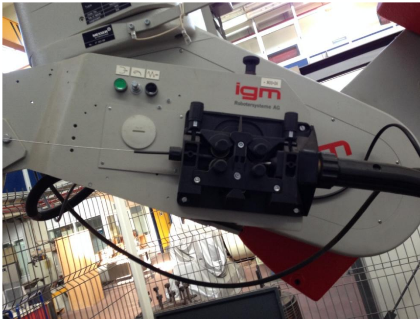
Σχήμα 5.4: Σύστημα τροφοδοσίας του ηλεκτροδίου προς το πιστόλι συγκόλλησης (wire feeder)
