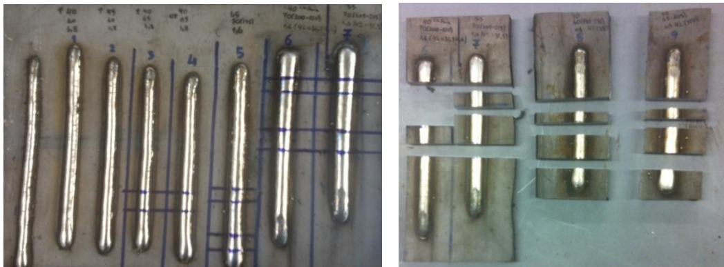
Εικόνα 6.18: α) Διευθύνσεις τομών στο έλασμα του X65, β) Έλασμα X65 μετά τις τομές
