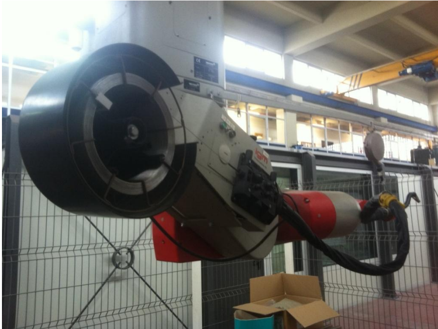
Σχήμα 5.3: Η μονάδα τροφοδοσίας ηλεκτροδίου με το τυλιγμένο ηλεκτρόδιο
