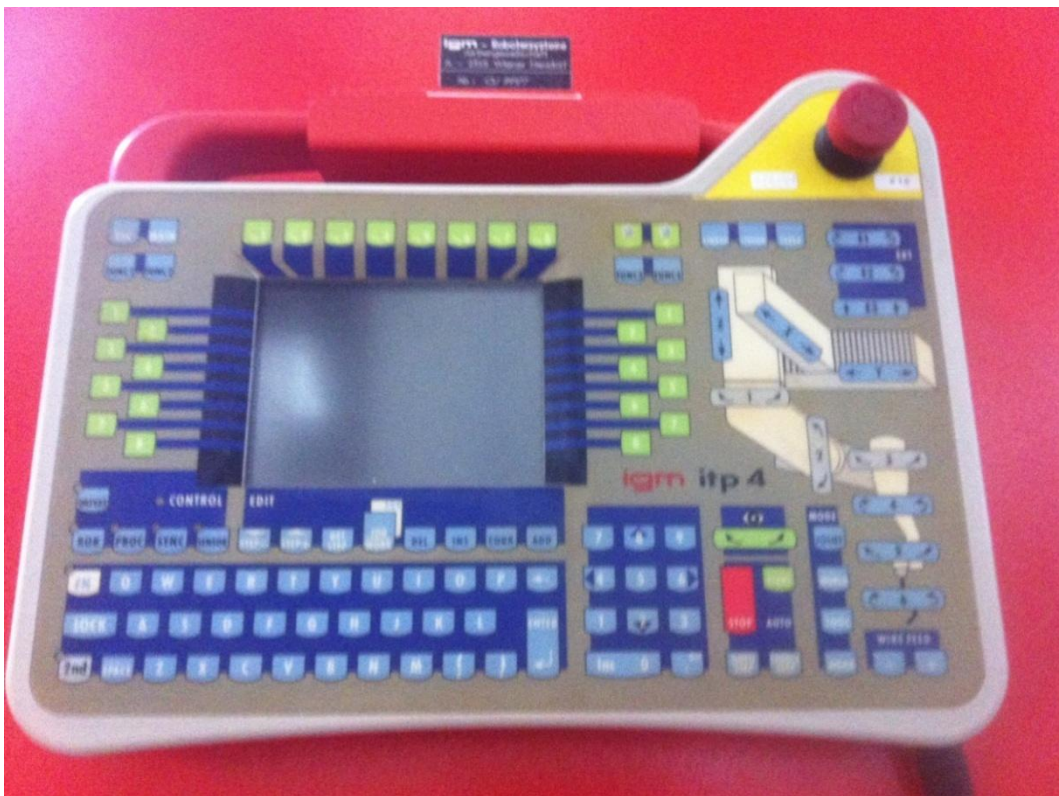
Σχήμα 5.8: Η κονσόλα χειρισμού (teach pendant) του ρομποτικού βραχίονα
