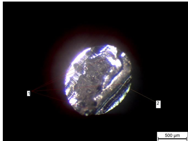
Εικόνα 6.6: Φωτογραφία εγκάρσιας τομής του ηλεκτροδίου από το οπτικό στερεοσκόπιο. 1: Ανοξειδωτος Χάλυβας, 2: Σκόνη Ρουτιλίου
