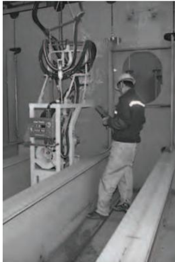
Σχήμα 3.1: On-line διδασκαλία του ρομπότ συγκόλλησης σε χώρο εργασίας
