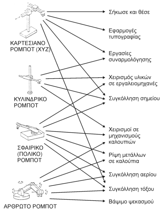
Σχήμα 2.8: Χρήση των καρτεσιανών, κυλινδρικών, σφαιρικών και αρθρωτών ρομπότ στις διάφορες βιομηχανικές εφαρμογές
