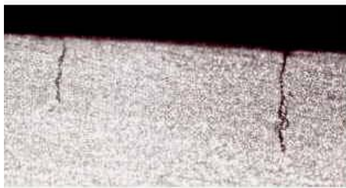
Σχήμα 1.2: Ρωγμάτωση στις γειτονικές περιοχές της ζώνης τήξης
