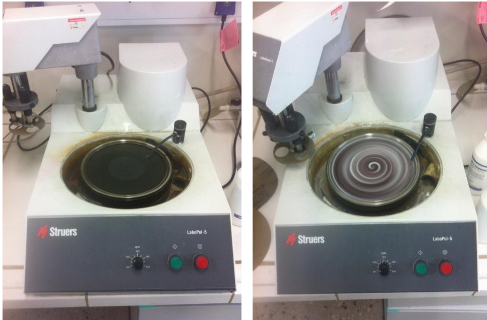
Εικόνες 6.23(α,β): Μηχανή λείανσης-στίλβωσης Struers Laborpol-5 με α) γυαλόχαρτο 80 grit και β) το βελούδο στίλβωσης με την πάστα αλούμινας
