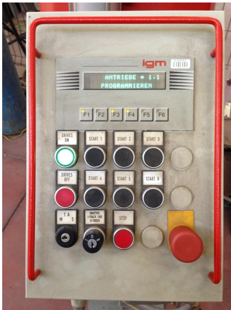
Σχήμα 5.11: External Start/Stop Cassette
