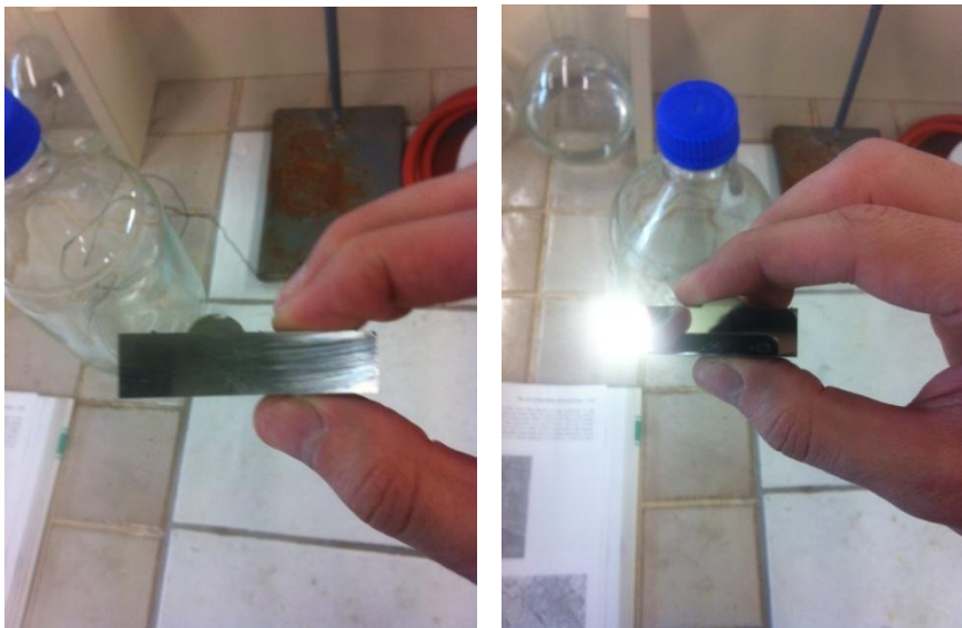
Εικόνες 6.24(α,β): Δοκίμιο πριν (α) και μετά (β) τις διαδικασίες λείανσης-στίλβωσης
