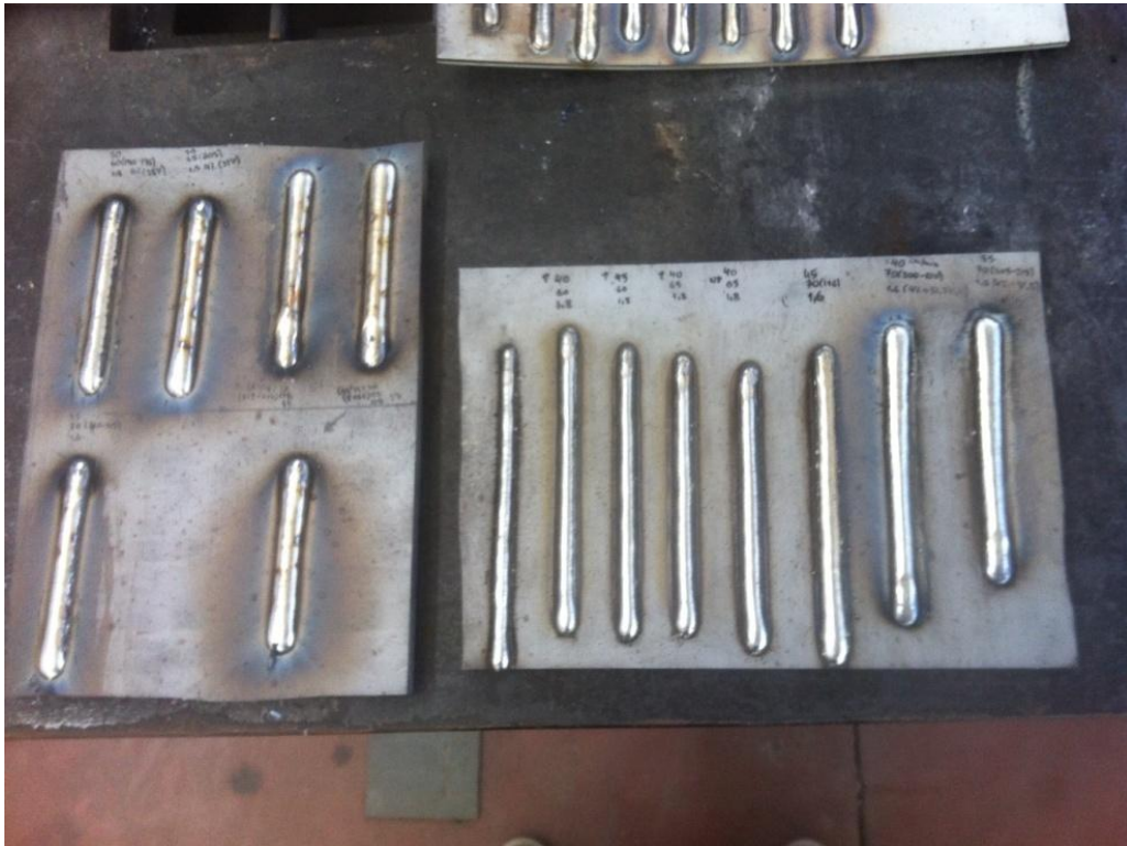
Εικόνα 6.15: Δοκιμαστικά περάσματα σε ελάσματα χάλυβα X65
