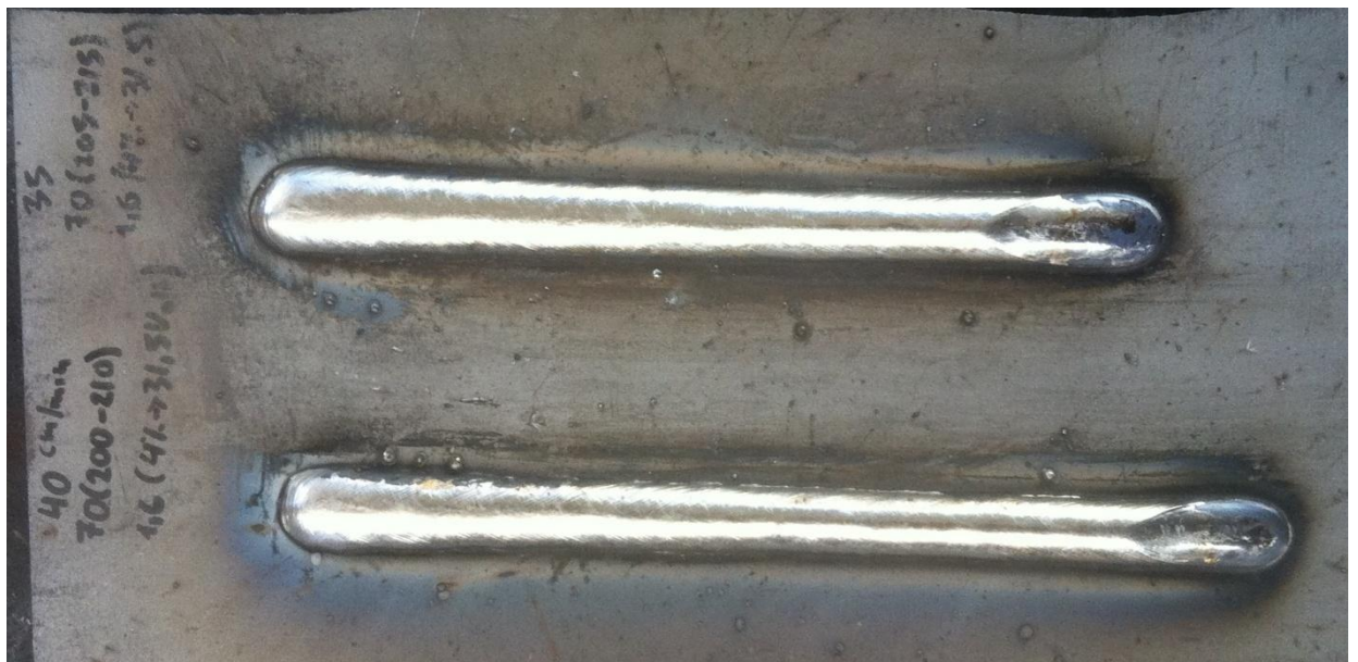
Σχήμα 6.16: Βέλτιστα beads on plate (No.6 και No.7) στο χάλυβα X65
