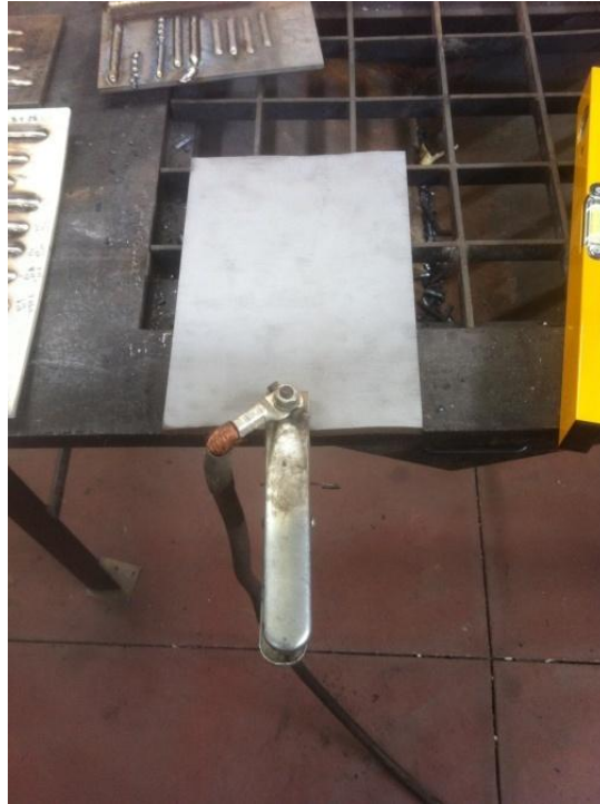
Εικόνα 6.11: Έλασμα του χάλυβα X65 πριν από δοκιμαστικό πέρασμα με το ρομπότ
