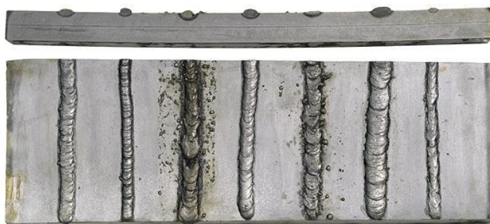
Σχήμα 1.10: Επίδραση παραμέτρων στην ποιότητα συγκόλλησης: 1) Ικανοποιητική Όψη Ραφής, 2) Χαμηλή Ένταση Ρεύματος, 3) Υψηλή Ένταση Ρεύματος, 4) Μικρό Μήκος Τόξου, 5) Μεγάλο μήκος τόξου, 6) Χαμηλή Ταχύτητα Τόξου, 7) Υψηλή Ταχύτητα Τόξου
