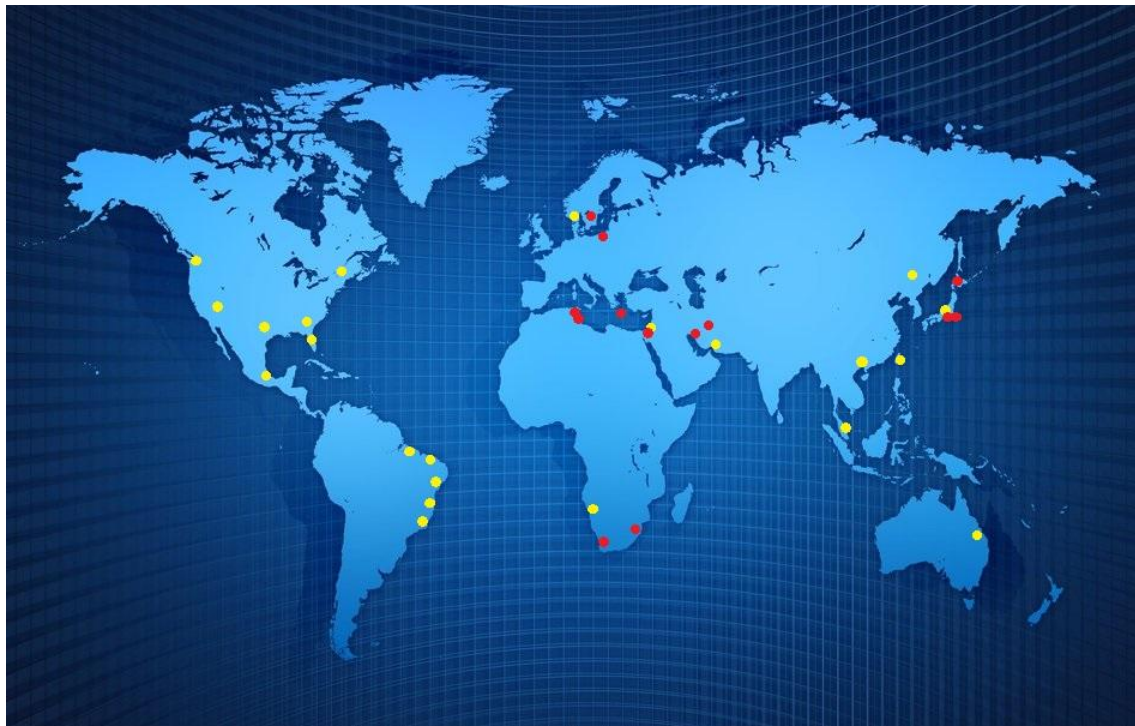
Εικόνα 2.1: Συγκεντρωτική απεικόνιση των περιοχών στις οποίες είτε έχουν κατασκευαστεί ειδικοί υπαίθριοι σταθμοί δοκιμών (κόκκινες κουκκίδες) είτε έχουν γίνει μετρήσεις στους μονωτήρες του υπάρχοντος δικτύου (κίτρινες κουκκίδες).
