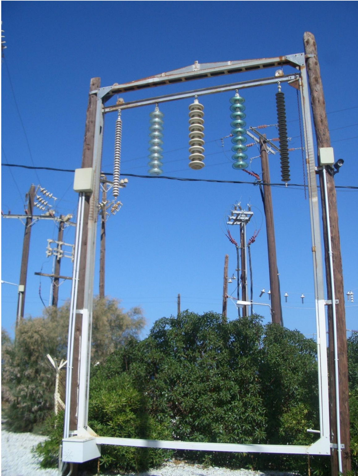
3. Διάταξη για τη μελέτη της επίδρασης των περιβαλλοντικών συνθηκών στη διαδικασία γήρανσης της επιφάνειας των μονωτήρων (μετρήσεις ESDD, NSDD – εκτός τάσης)
