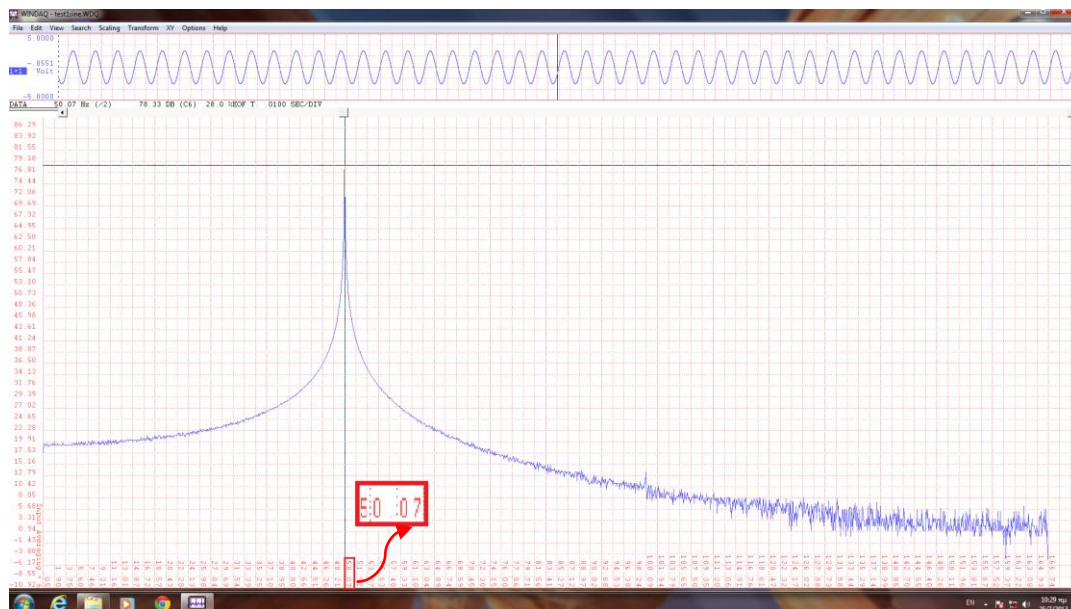
Εικόνα 5.3: Παράδειγμα μετασχηματισμού Fourier δοκιμαστικού ημιτονοειδούς σήματος εισόδου, όπου είναι εμφανής η θεμελιώδης συχνότητα στα 50.07Hz.
