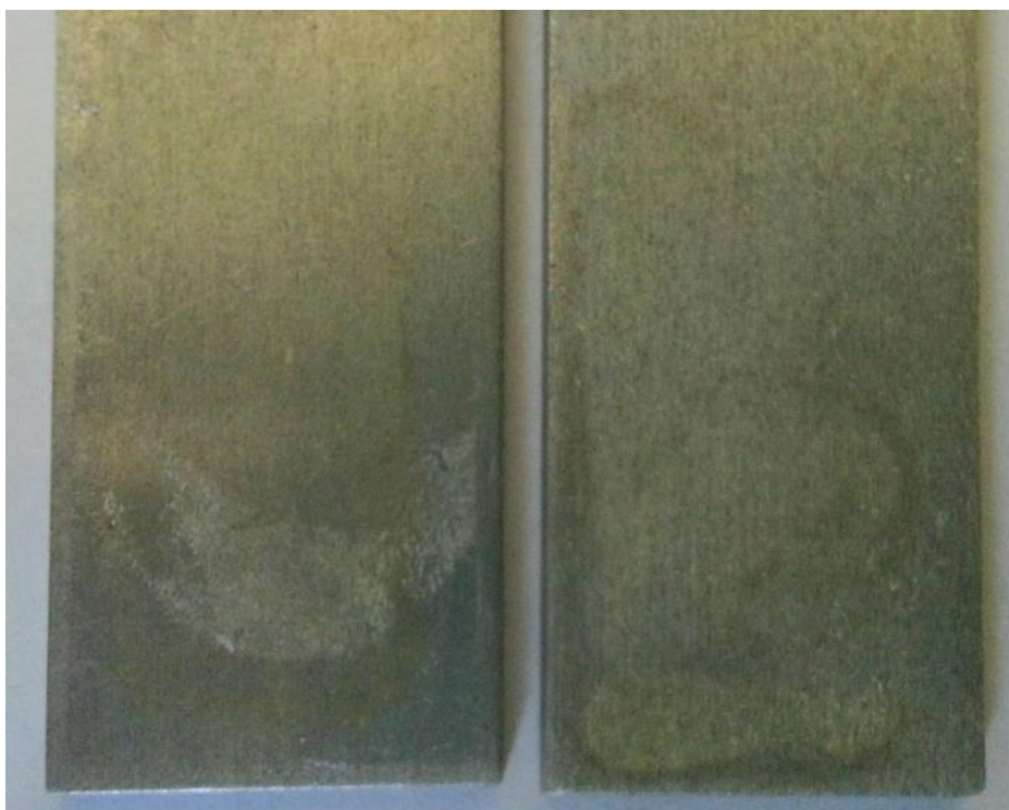
Σχήμα 6.16 Οπτικές εικόνες των επικαλυμμένων δοκιμίων της σύνθεσης A-5/95 Ce/Si και A-10/90 αντίστοιχα, μετά την ολοκλήρωση της έκθεσης τους στο διαβρωτικό μέσο για 4 εβδομάδες.
