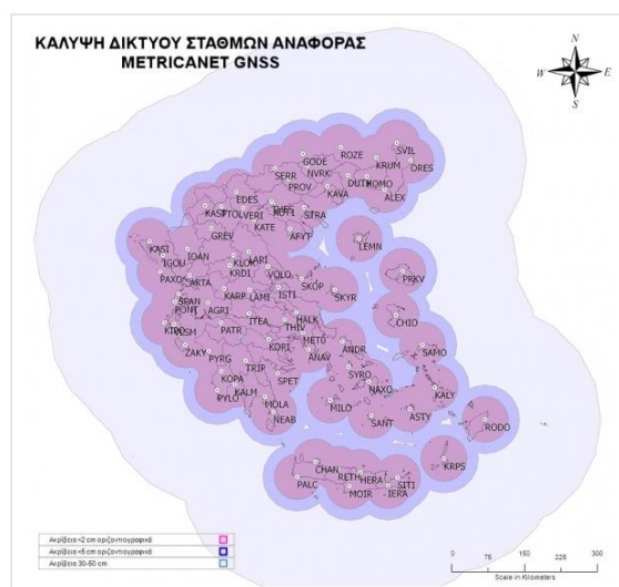
Εικόνα 9: Οι σταθμοί αναφοράς GNSS του δικτύου Metricanet (πηγή : http://www.metricanet.gr/documentation/smartnet-greece-network.html )
