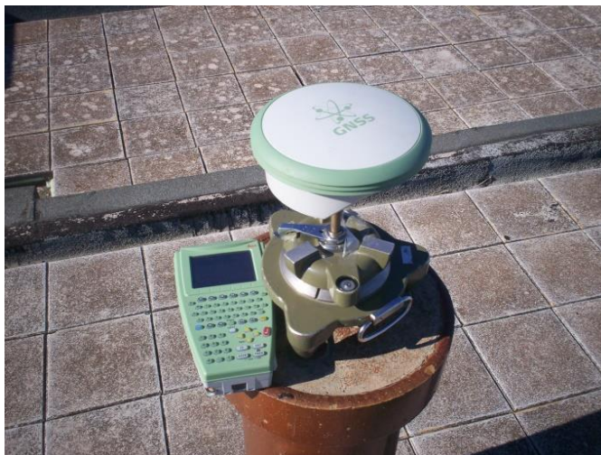
Εικόνα 13: Χειριστήριο RX 1250 X, κεραία ATX 1230 και βάση εξαναγκασμένης κέντρωσης Kern
