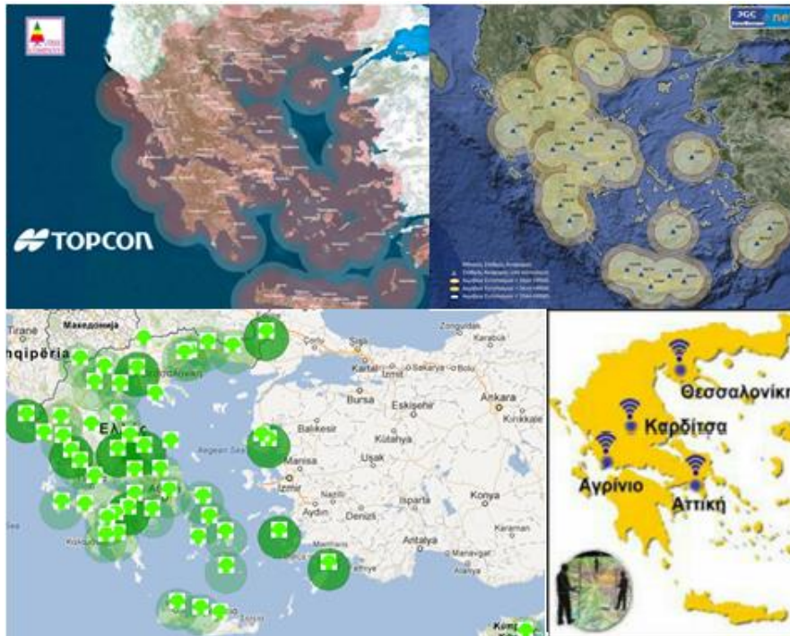
Εικόνα 10: Τα ιδιωτικά δίκτυα δορυφορικού εντοπισμού στην Ελλάδα (πάνω αριστερά το δίκτυο URANUS της εταιρείας TREE COMPANY, πάνω δεξιά το δίκτυο της εταιρείας JGC, κάτω αριστερά το δίκτυο CORS της εταιρείας CIVILSHOP, κάτω δεξιά το δίκτυο σταθμών της εταιρείας GEOTECH) (πηγή: http://www.uranus.gr/ , http://www.civilshop.com/ , http://www.jgc.gr/ , http://www.geotech.gr/ )
