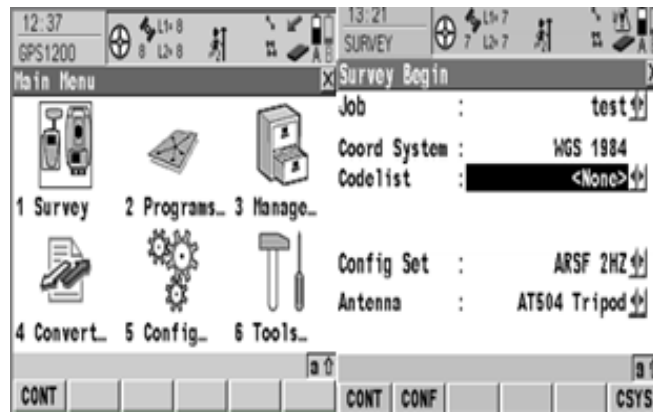
Εικόνα 14: Κυρίως μενού και εισαγωγή δεδομένων αποτύπωσης στο λογισμικό smartwrx (πηγή : Leica Geosystems User Manual)
