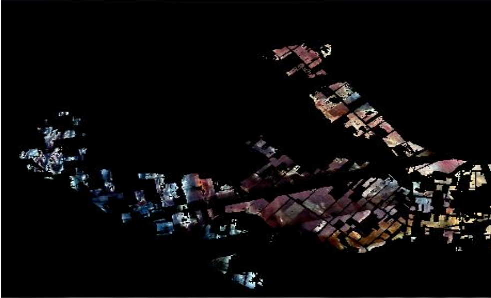
Εικόνα 3-12: Τελική απεικόνιση η οποία χρησιμοποιήθηκε για την εφαρμογή της διαδικασίας του φασματικού διαχωρισμού. Εγχρωμο σύνθετο (R:Band 38 (637.2 nm) G:Band 20 (535.1 nm) B: Band 5 (443.8 nm))
