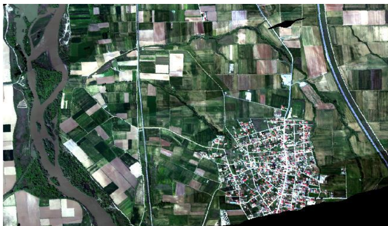
Εικόνα 3-2: Ορθοφωτομωσαϊκό πραγματικού χρώματος (R,G,B) στο οποίο φαίνονται οι διαφορετικές καλύψεις γης (καλλιέργειες, οικισμοί, νερά ποταμών)
