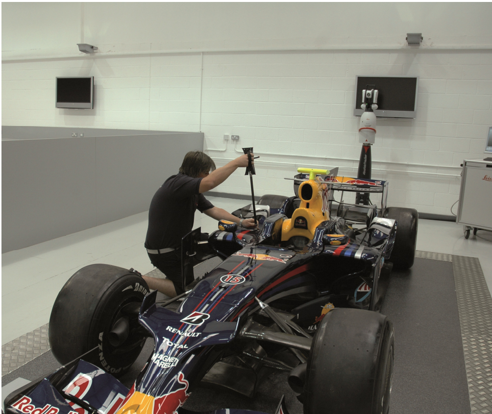
Εικόνα 1.2. Χρήση Laser Tracker σε Μονοθέσιο F1 [ www.leica-geosystems.com ]
