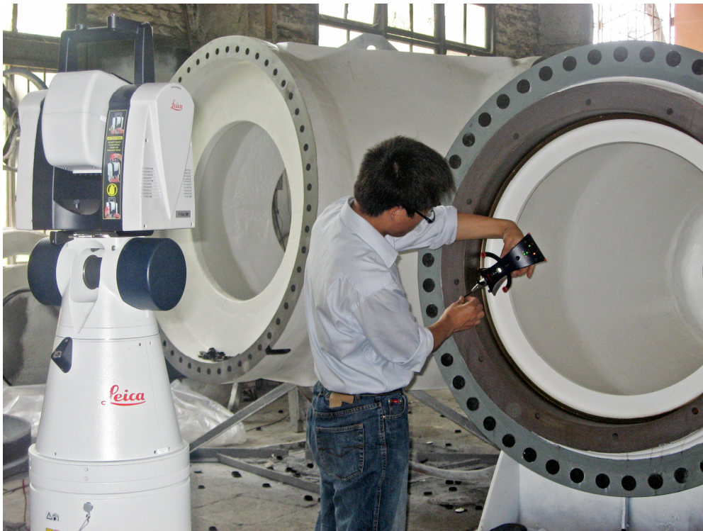
Εικόνα 1.4. Χρήση Laser Tracker για Έλεγχο Ανεμογεννητριών [ www.leica-geosystems.com ]
