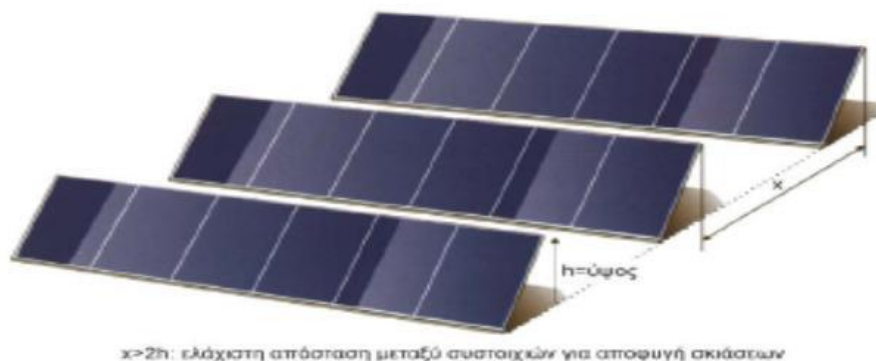
Σχήμα 2.5: Απόσταση μεταξύ συστοιχιών για αποφυγή σκιάσεων
