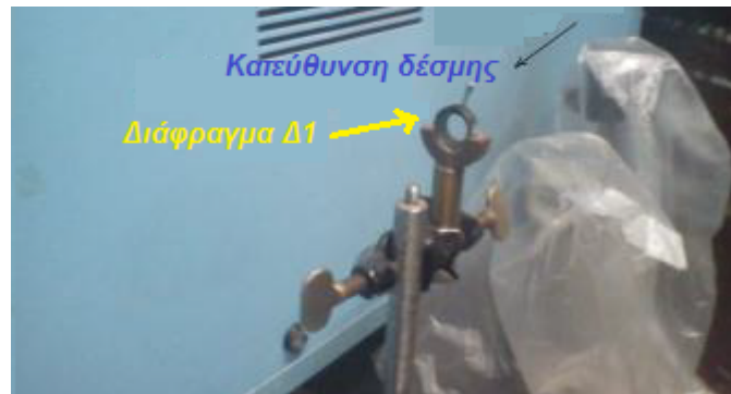
Σχήμα 6.5. Αναπαράσταση του διαφράγματος Δ1 της πειραματικής διάταξης, καθώς και της κατεύθυνση της δέσμης Laser πριν διέλθει μέσα από αυτό.
