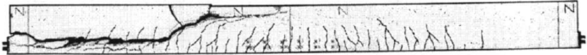
Σχήμα 4.10: Ρηγμάτωση (crack pattern) της δοκού OA3 στο στάδιο αστοχίας κατά την πειραματική δοκιμή [10].
