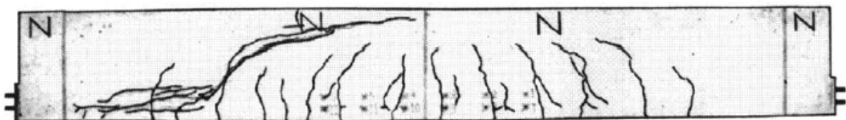
Σχήμα 4.2: Ρηγμάτωση (crack pattern) της δοκού ΟΑ1 στο στάδιο αστοχίας κατά την πειραματική δοκιμή [10].
