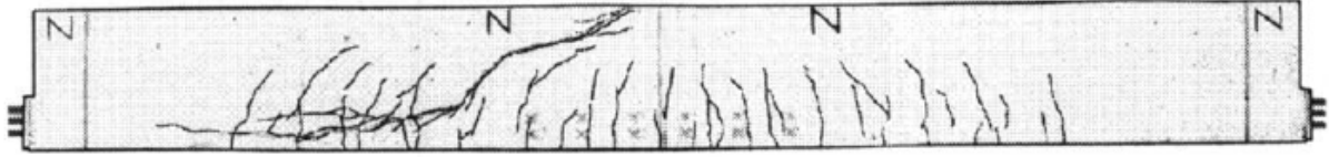
Σχήμα 4.6: Ρηγμάτωση (crack pattern) της δοκού OA2 στο στάδιο αστοχίας κατά την πειραματική δοκιμή [10].
