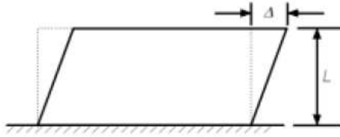
Σχήμα 2.3: Μετακίνηση σε τοίχωμα όταν η διάτμηση κυριαρχεί κατά την ανελαστική απόκριση [7].
