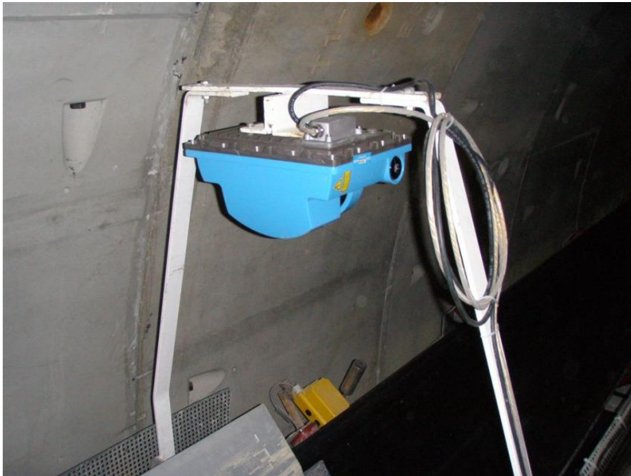
Εικόνα 2-2: Μετρητής skaner για τον προσδιορισμό του εδαφικού όγκου - Courtesy of SICK AG [9]
