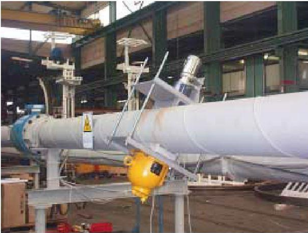
Εικόνα 2-4: Απεικόνιση μαγνητικών και ραδιομετρικών μετρητών για τον υπολογισμό του βάρους του υλικού που εκσκάπτεται [9]
