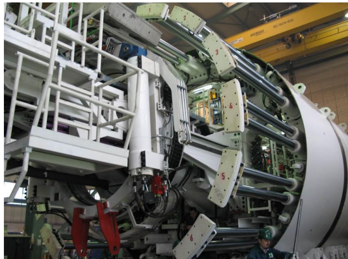
Εικόνα 1-19: Ο μηχανισμός των γάντζων τοποθέτησης των στοιχείων της επένδυσης του μηχανήματος EPB, που χρησιμοποιήθηκε στη διάνοξη του υπόγειου σιδηροδρόμου στην Αθήνα [9]
