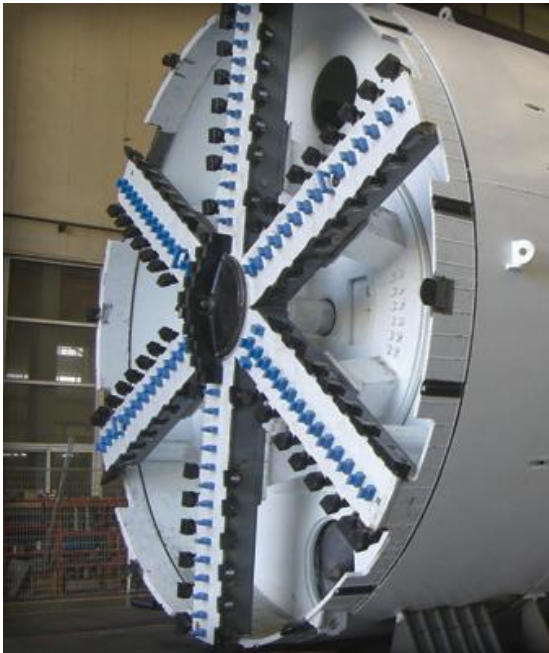
Εικόνα 1-6: Αριστερά απεικονίζεται η ανοιχτού τύπου ασπίδα που χρησιμοποιήθηκε στο μηχάνημα για την επέκταση του υπόγειου σιδηροδρόμου στο New Delhi, δεξιά απεικονίζεται η κλειστού τύπου ασπίδα που χρησιμοποιήθηκε για την επέκταση του υπόγειου σιδηροδρόμου στην Αθήνα [9]
