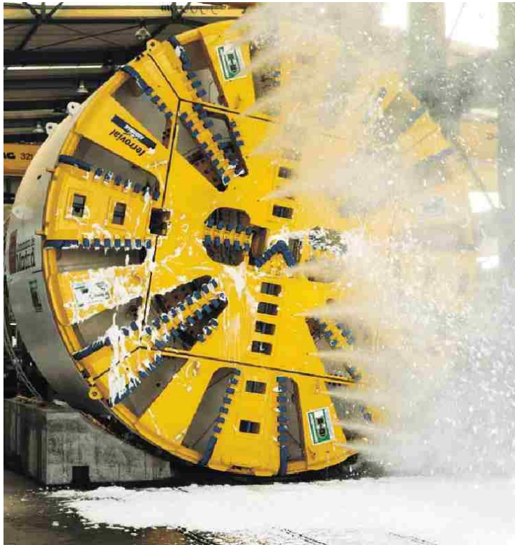
Εικόνα 1-15: Διαδικασία ελέγχου της εισπίεση αφρού στο τμήμα της κοπτικής κεφαλής ενός μηχανήματος EPB [9]
