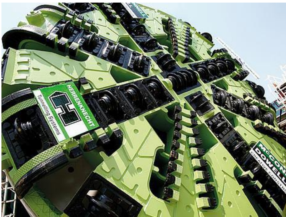
Εικόνα 1-27: Κοπτική κεφαλή του μηχανήματος Hydroshield που χρησιμοποιήθηκε στην εκσκαφή της γραμμής του υπόγειου σιδηροδρόμου στη Σιγκαπούρη [9]
