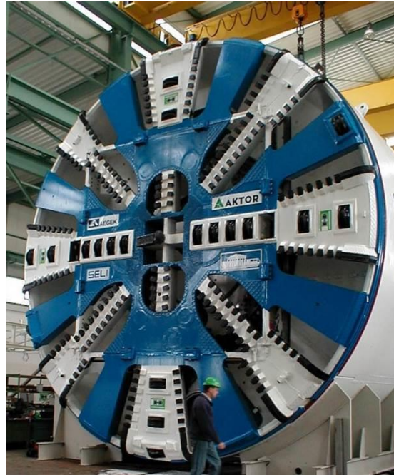
Εικόνα 1-6: Αριστερά απεικονίζεται η ανοιχτού τύπου ασπίδα που χρησιμοποιήθηκε στο μηχάνημα για την επέκταση του υπόγειου σιδηροδρόμου στο New Delhi, δεξιά απεικονίζεται η κλειστού τύπου ασπίδα που χρησιμοποιήθηκε για την επέκταση του υπόγειου σιδηροδρόμου στην Αθήνα [9]
