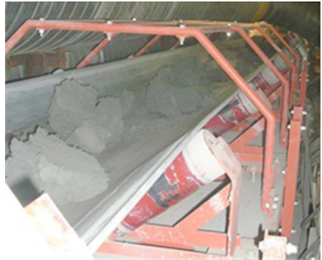
Εικόνα 2-1: Μοναδιαίος μετρητής βάρους Siemens Miltronics και μηχανικός ιμάντας μέτρησης εδαφικού όγκου όπως είναι τοποθετημένη στο εσωτερικό ενός μηχανήματος TBM (πηγή: TBM Conveyor belt scales, the university link project experience, Indra Banerjee CH2M HILL, Inc. Richard McLane Traylor Bros., Inc. , Ed Shorey CH2M HILL, Inc., Paul Gasson CH2M HILL, Inc.)
