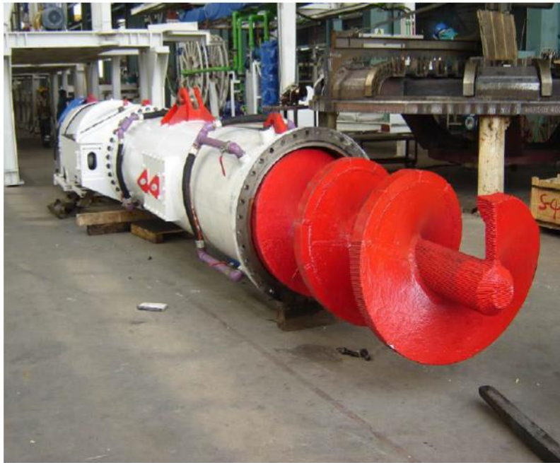
Εικόνα 1-11: Απεικόνιση ατέρμονα κοχλία με κεντρικό άξονα περιστροφής [9]
