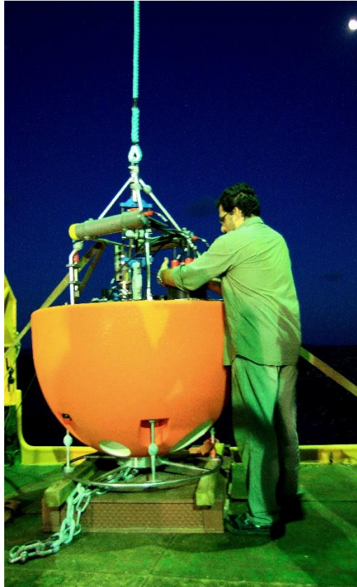
Εικόνα 25. Το παρατηρητήριο βυθού λίγο πριν την πόντισή του κοντά στον πλωτήρα της Πύλου
