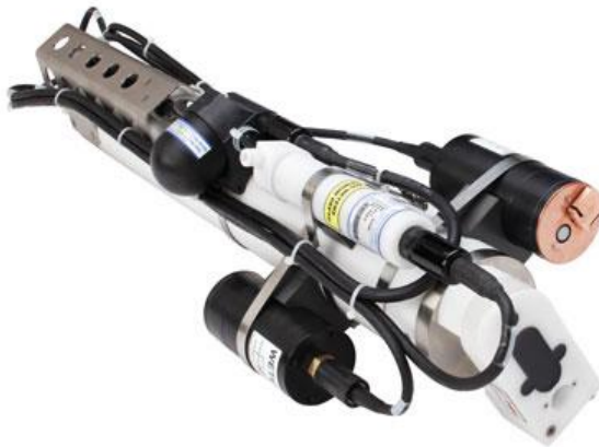
Εικόνα 31. Το seabird 16 plus με τα όργανα για την μέτρηση χλωροφύλλης-A, θολερότητας, οξυγόνου.
