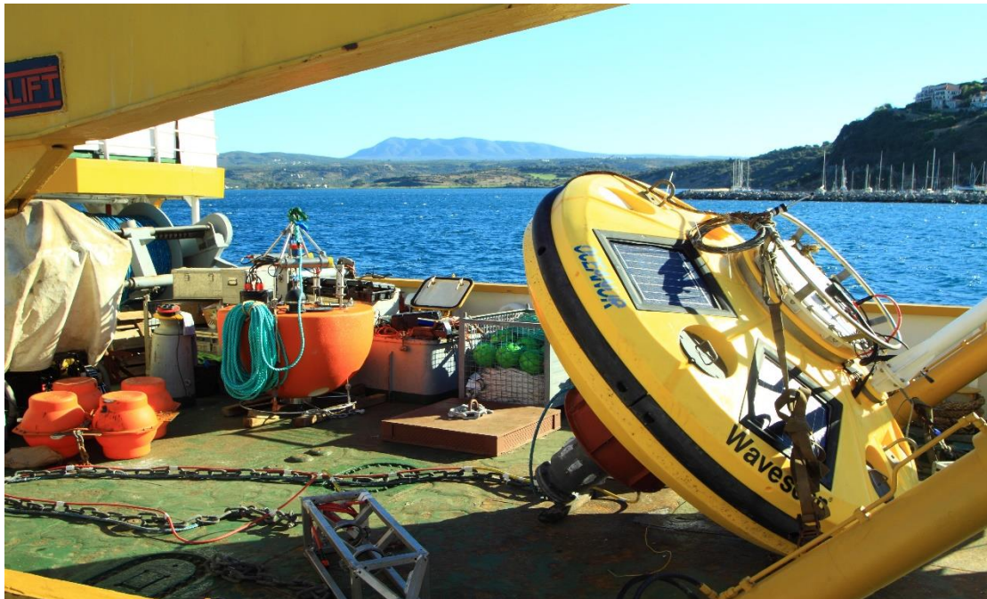
Εικόνα 24. Το παρατηρητήριο βυθού με τον πλωτήρα τύπου Wavescan στον λιμένα της Πύλου
