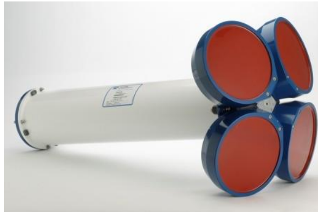
Εικόνα 33. Φωτογραφία του μετρητικού οργάνου για προφίλ ταχυτήτων και κατευθύνσεων Long Ranger ADCP
