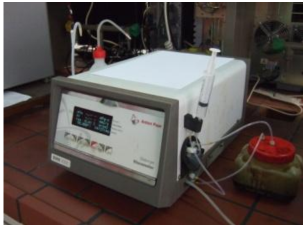
Σχήμα 3.7. Συσκευή μέτρησης ιξώδους και πυκνότητας
